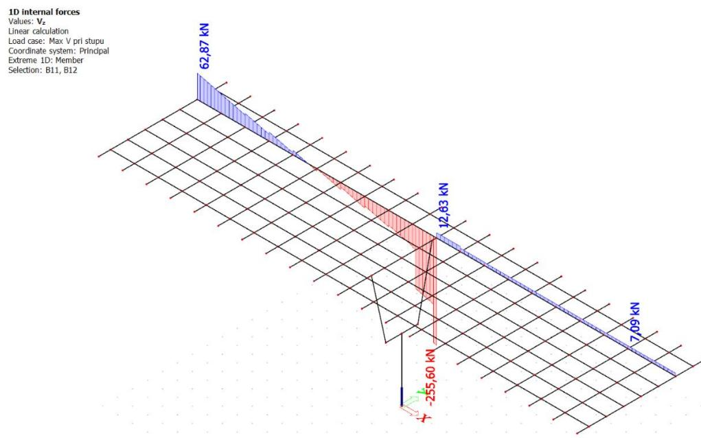
Slika 28. Pokretno – maksimalna poprečna sila pri stupu- poprečne sile ( $V_z$ ) u kN
