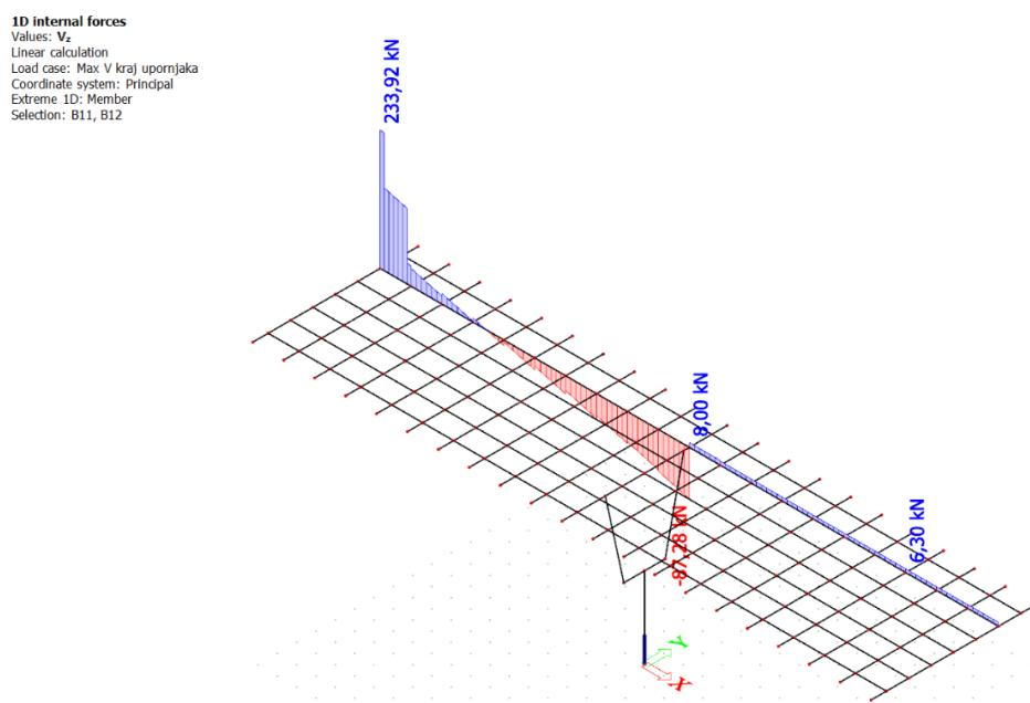
Slika 24. Pokretno – maksimalna poprečna sila pri upornjaku – poprečne sile ( $V_z$ )
