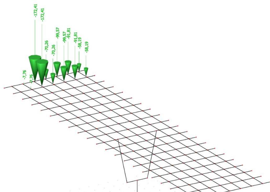
Slika 22. Prikaz opterećenja tipskog vozila za maksimalnu poprečnu silu pri upornjaku
