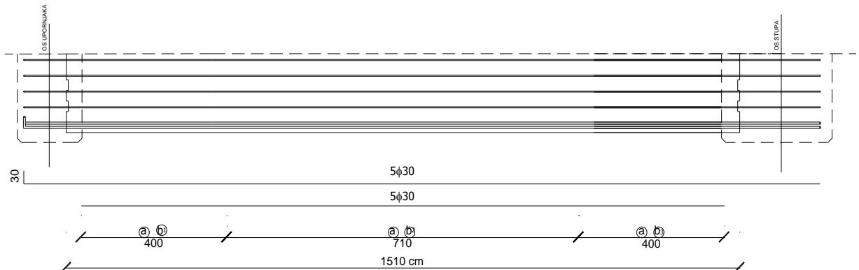
Slika 31. Prikaz armiranja uzdužnog nosača u polju
