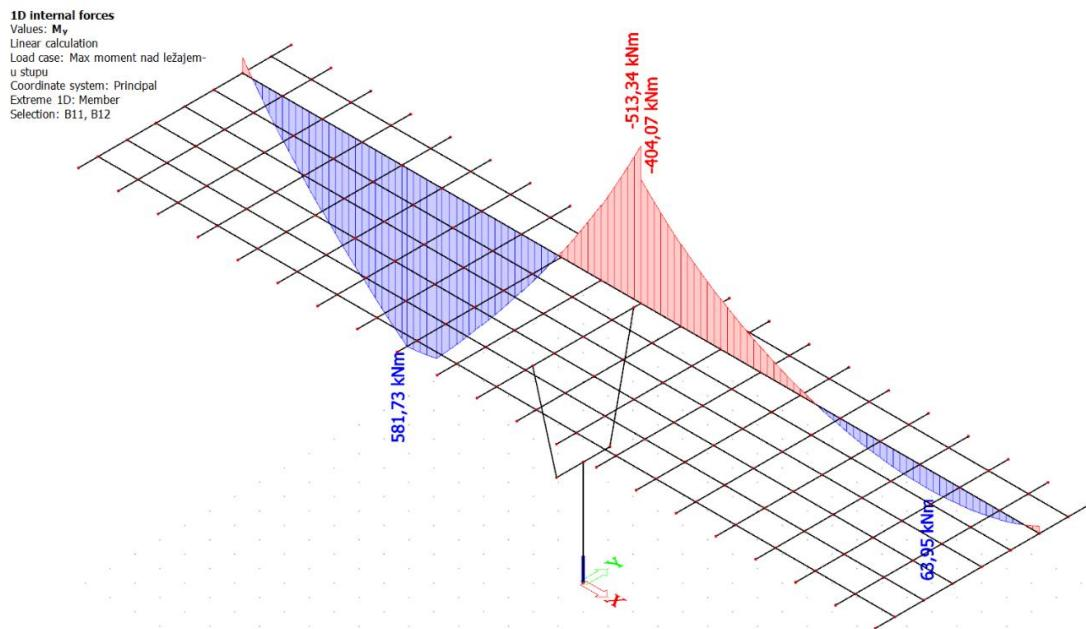
Slika 19. Pokretno – maksimalni moment nad stupom – momenti ( $M_y$ ) u kNm
