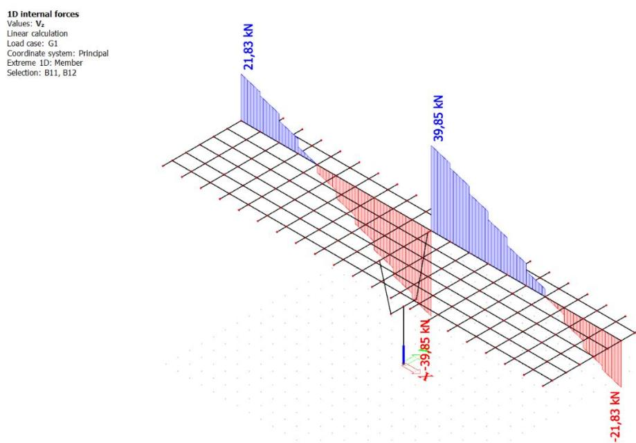
Slika 11. Dodatno stalno opterećenje – poprečne sile ( $V_z$ ) u kN
