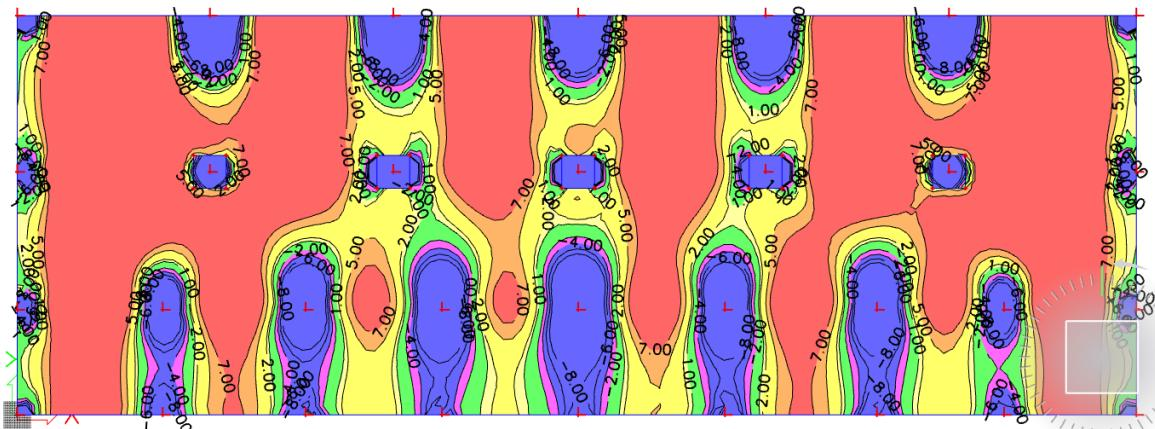
Slika 6.23 Moment savijanja  $M_{Ed,x}$  (kNm/m) za GSU
