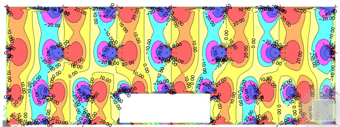
Slika 6.5 Poprečne sile  $V_{Ed,x}$  (kN/m) za GSN
