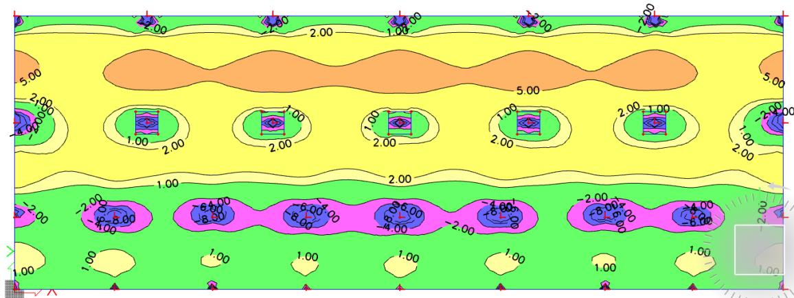
Slika 6.20 Potrebna površina armature  $A_s(cm^2/m)$  u y smjeru
