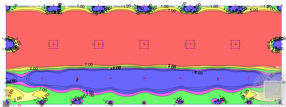
Slika 6.24 Moment savijanja  $M_{Ed,y}$  (kNm/m) za GSU
