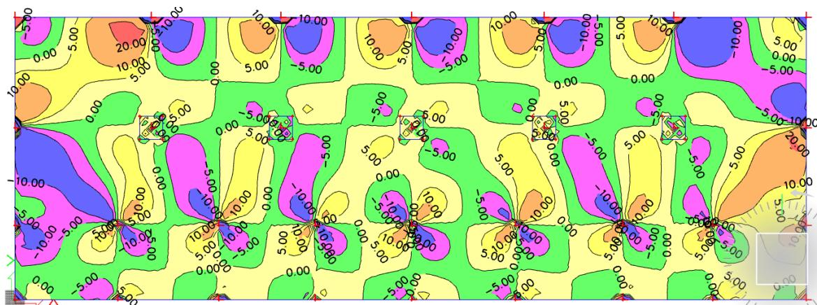
Slika 6.16 Moment savijanja  $M_{Ed,xy}$  (kNm/m) za GSN
