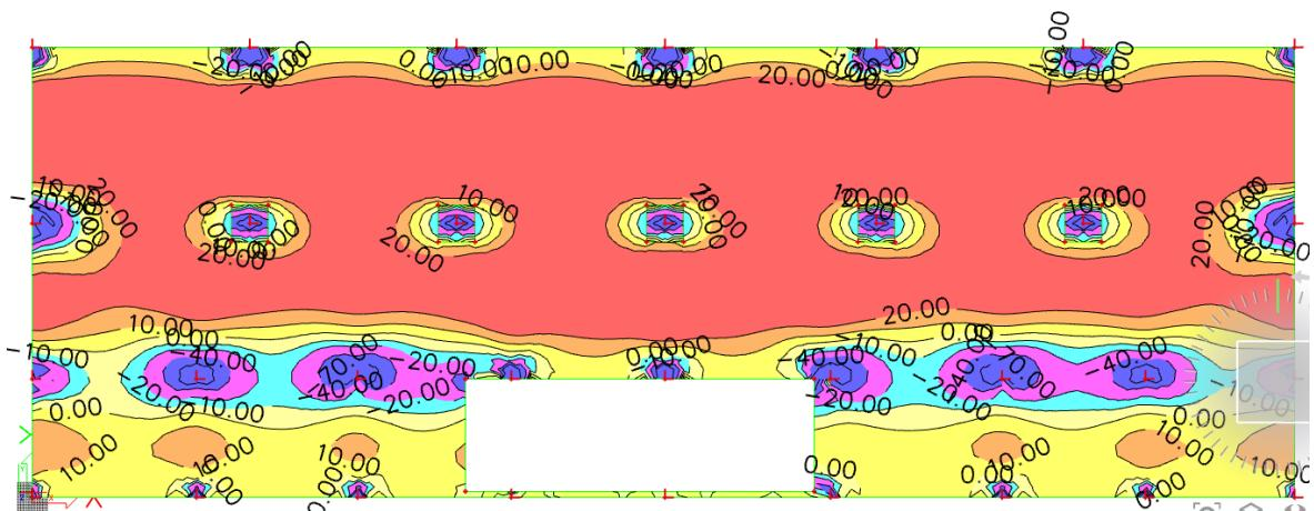
Slika 6.3 Moment savijanja  $M_{Ed,y}$  (kNm/m) za GSN
