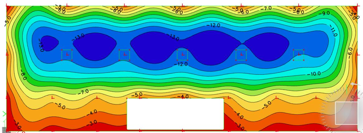
Slika 6.9 Progib ploče (mm) za kombinaciju GSU
