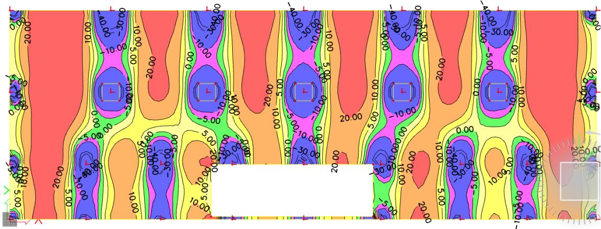
Slika 6.11 Moment savijanja  $M_{Ed,x}$  (kNm/m) za GSU
