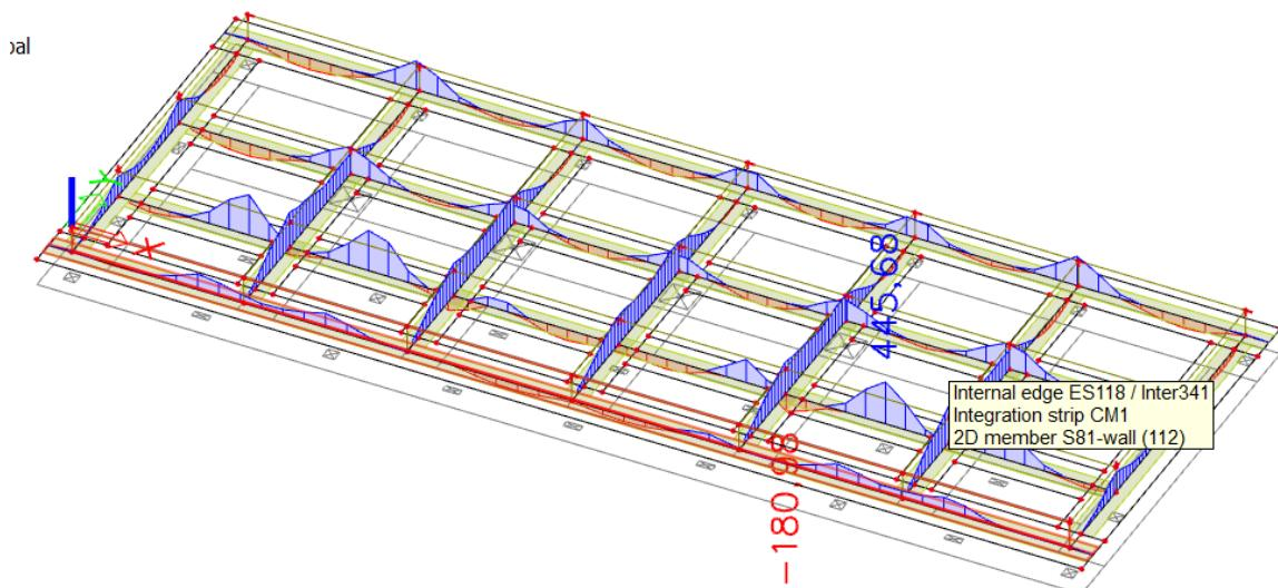
Slika 10.5 Linijske reakcije na mjestima oslanjanja zidova na temeljne trake (Kn/m) za kombinaciju GSN
