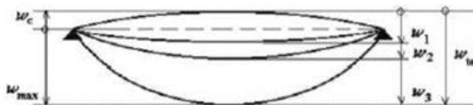
Slika 7.3 Prikaz progiba grede
