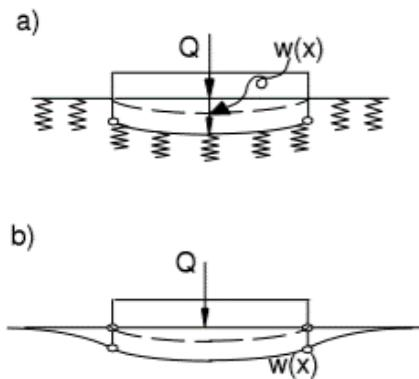
Slika 10.2 Winklerov model (a) i stvarni nosač (b)
