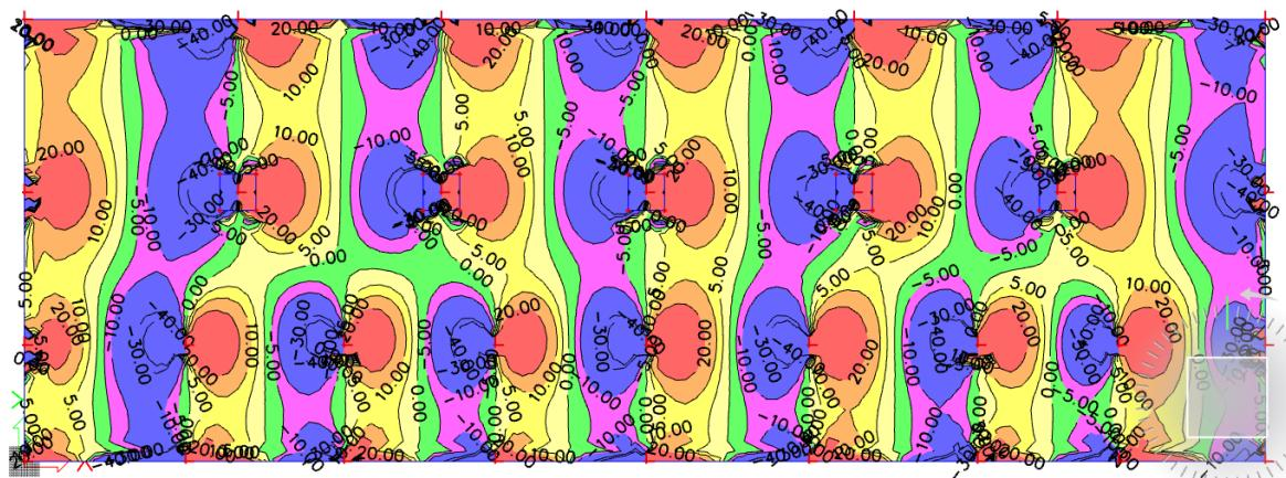
Slika 6.17 Poprečne sile  $V_{Ed,x}$  (kN/m) za GSN
