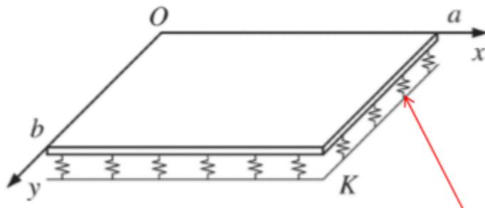
Slika 10.1 Međudjelovanje konstrukcija – tlo modelirano Winkler- ovim modelom
