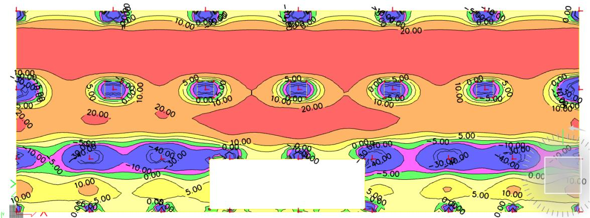
Slika 6.12 Moment savijanja  $M_{Ed,y}$  (kNm/m) za GSU
