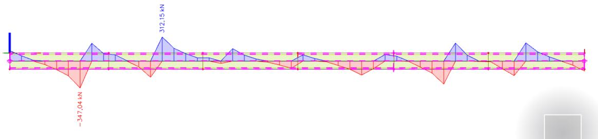
Slika 7.2 Poprečne sile  $V_{Ed,z}$  (kN/m) za GSN
