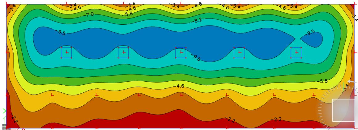
Slika 6.21 Progib ploče (mm) za kombinaciju GSU
