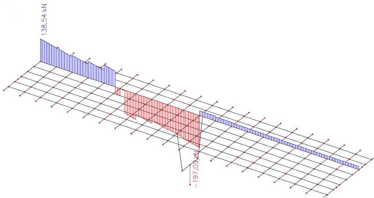
Slika 18: Pokretno opterećenje – maksimalni moment u prvom polju – poprečne sile  $V_z$  (kN)
