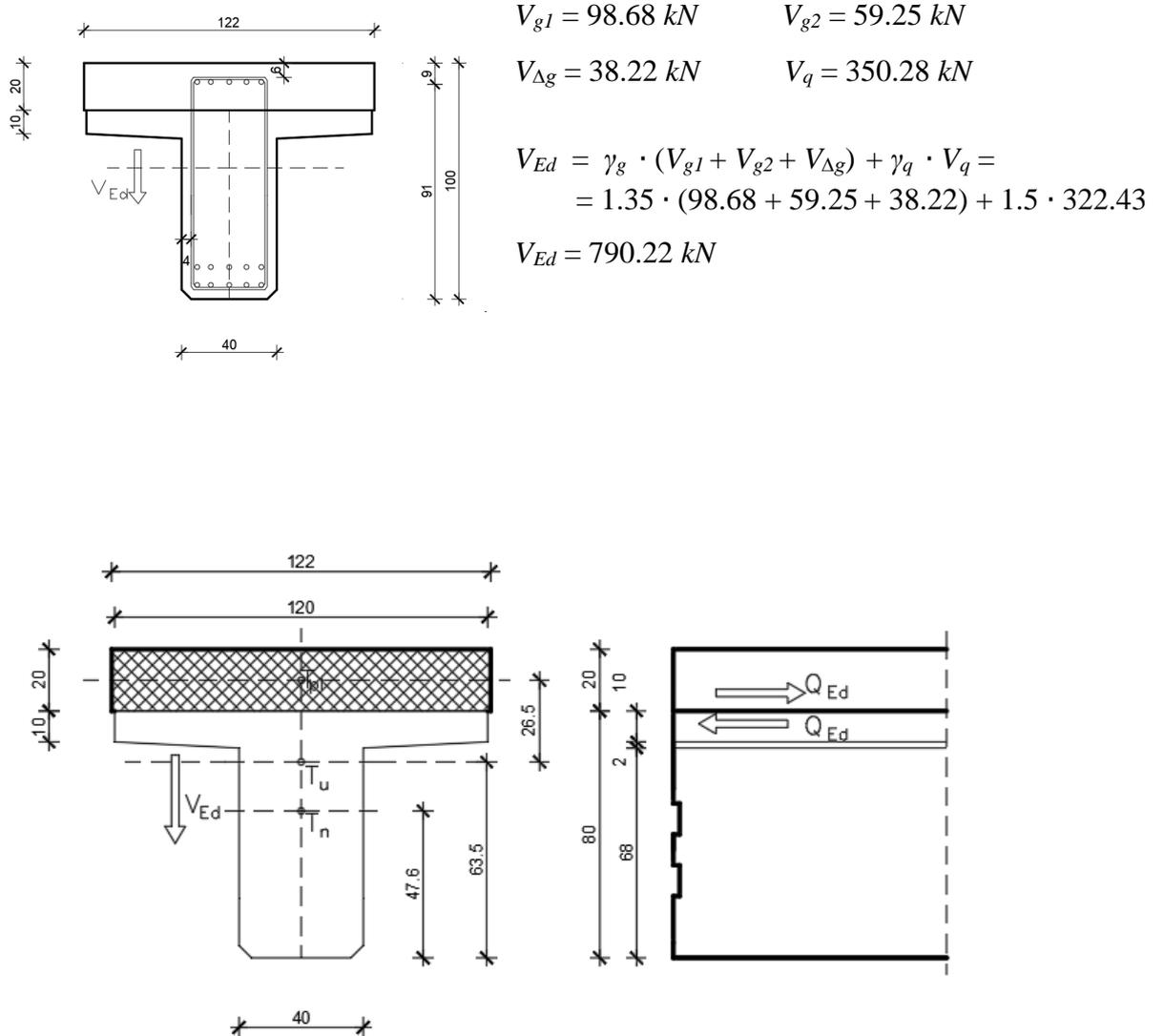
Slika 32: Poprečni presjek spregnutog T nosača
