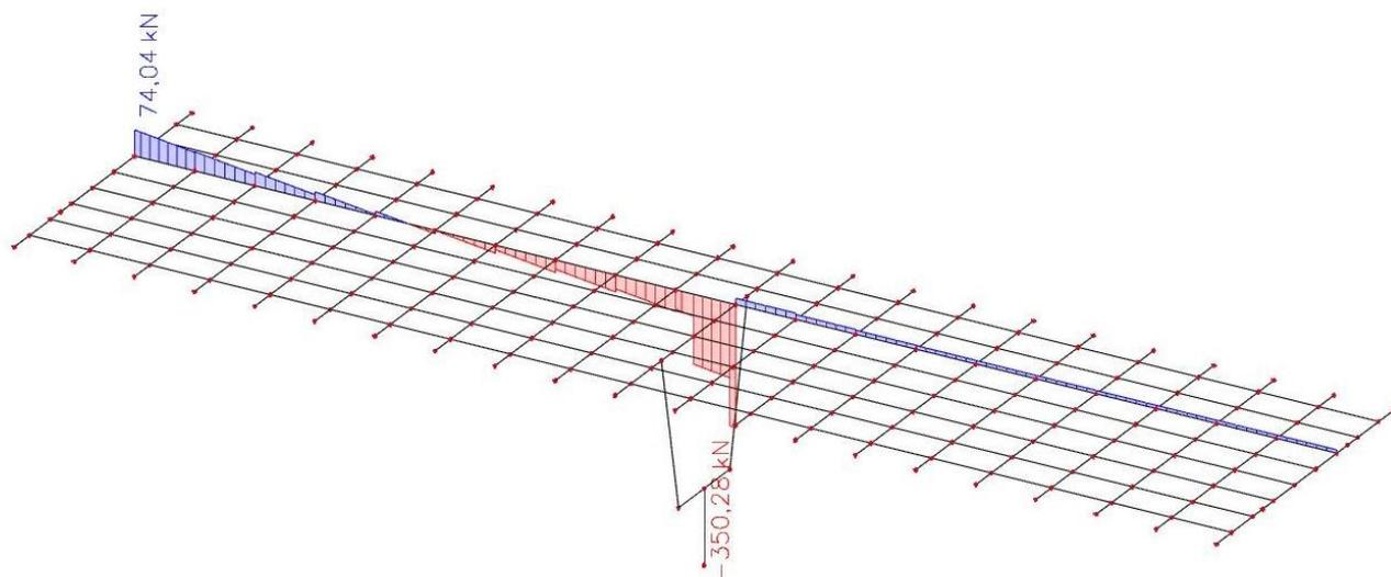
Slika 30: Pokretno opterećenje – maksimalna poprečna sila pri stupu – poprečne sile  $V_z$  (kN)
