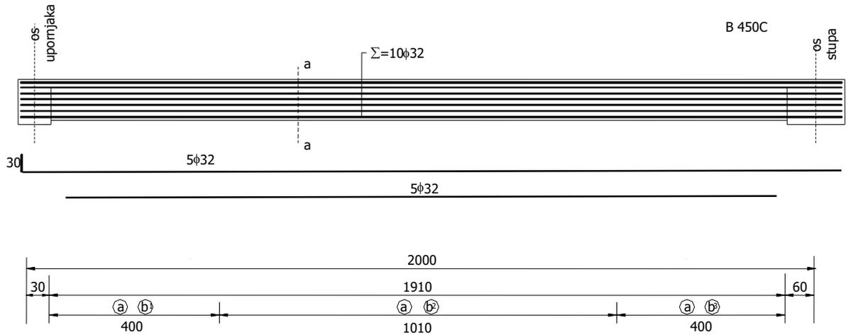
Slika 33: Uzdužni presjek nosača
