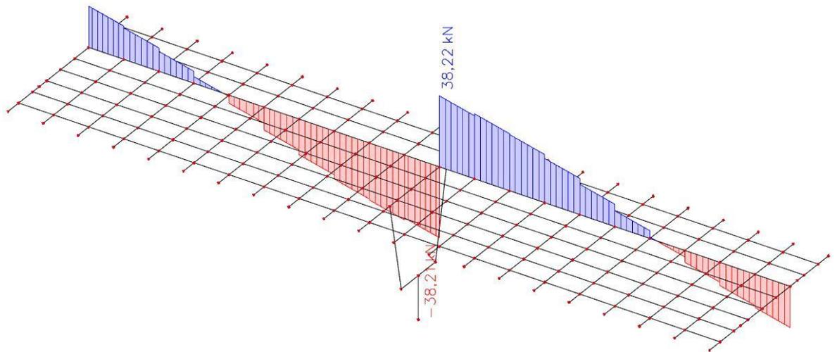
Slika 13: Dodatno stalno opterećenje – poprečne sile  $(V_z)$  u  $\text{kN}$
