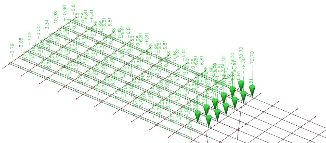
Slika 27: Pokretno opterećenje za maksimalnu poprečnu silu pri stupu
