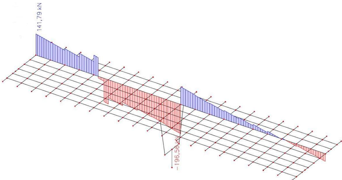
Slika 22: Pokretno opterećenje – maksimalni moment pri stupu – poprečne sile  $V_z$  (kN)
