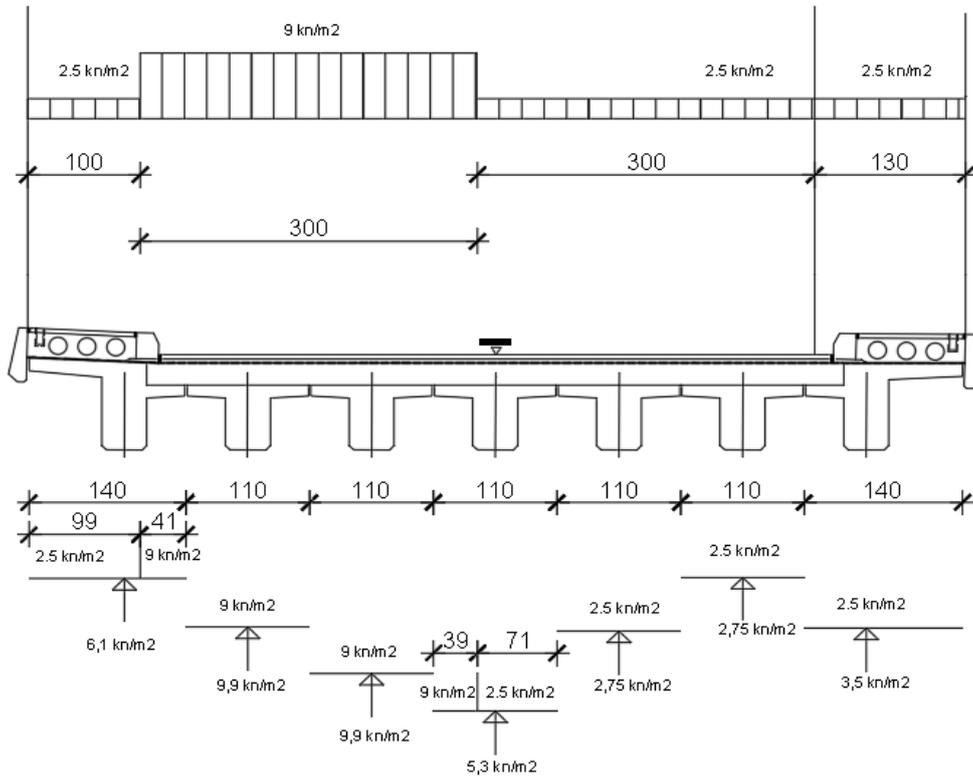
Slika 15. Analiza kontinuiranog opterećenja na uzdužnim nosačima
