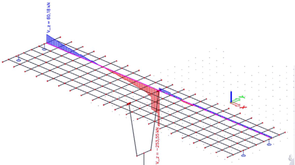
Slika 28. Pokretno – maksimalna poprečna sila pri stupu – poprečne sile ( $V_z$ ) u kN
