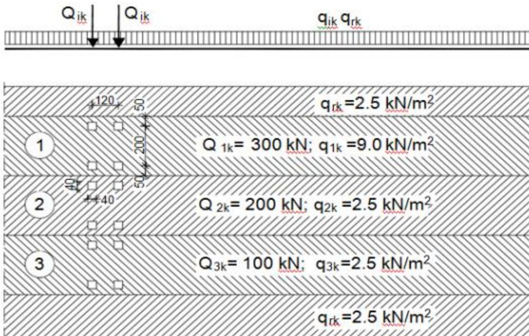
Slika 14. Prikaz načina opterećenja mosta pokretnim opterećenjem
