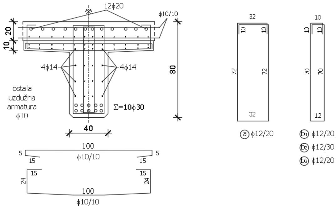
Slika 40. Prikaz armiranja nosača u presjeku a-a
