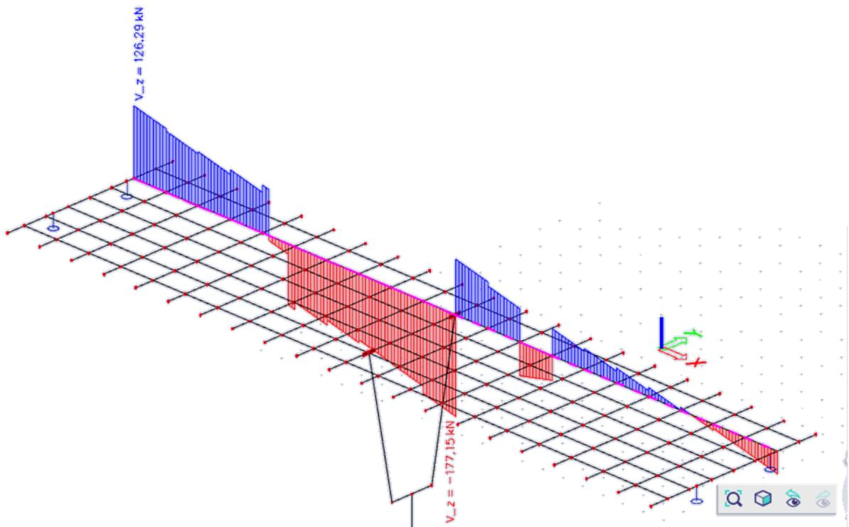
Slika 24. Pokretno – maksimalni moment pri stupu – poprečne sile ( $V_z$ ) u kN
