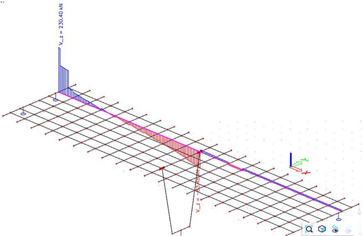
Slika 32. Pokretno – maksimalna poprečna sila pri upornjaku – poprečne sile ( $V_z$ ) u kN
