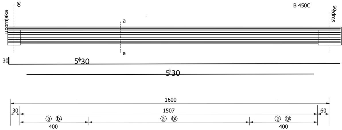
Slika 39. Prikaz armiranja uzdužnog nosača u polju
