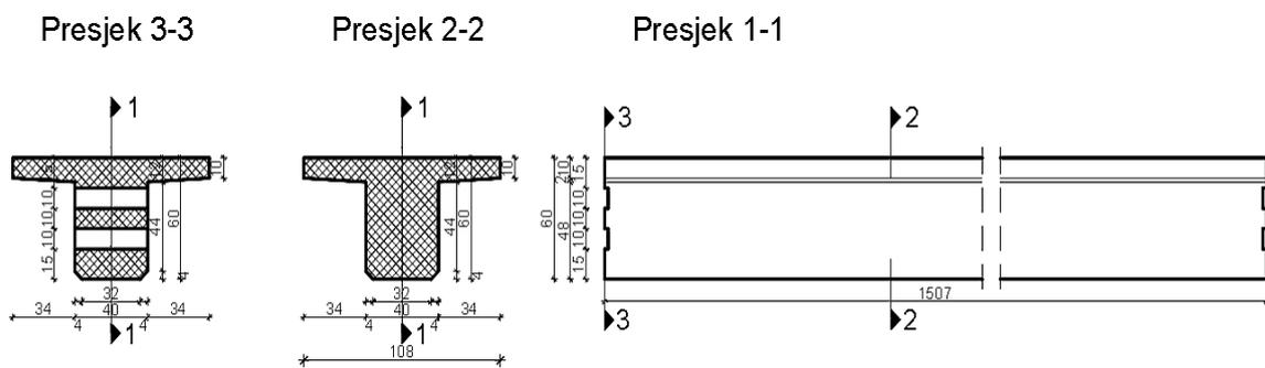
Slika 2. Uzdužna i poprečna dispozicija jednog nosača
