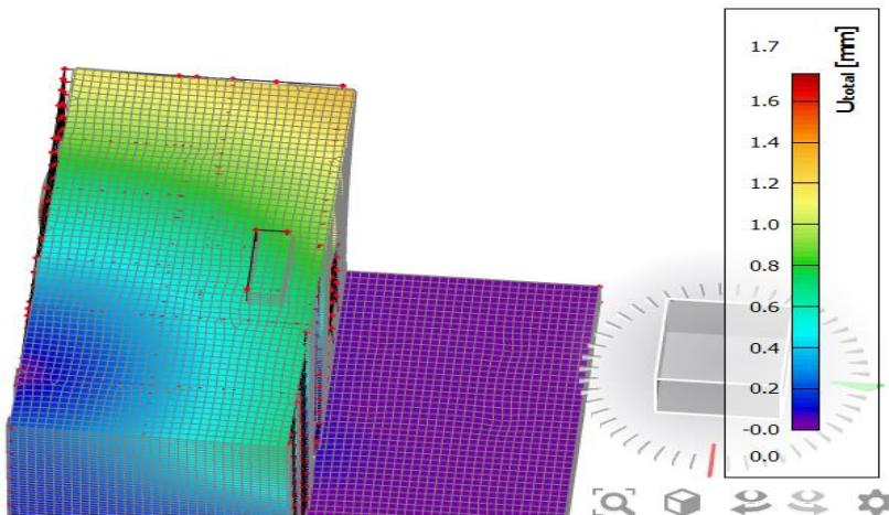
Slika 4.16. Deseti vlastiti vektor od djelovanja potresa na konstrukciju  $T_{10}=0,07 \text{ s}$
