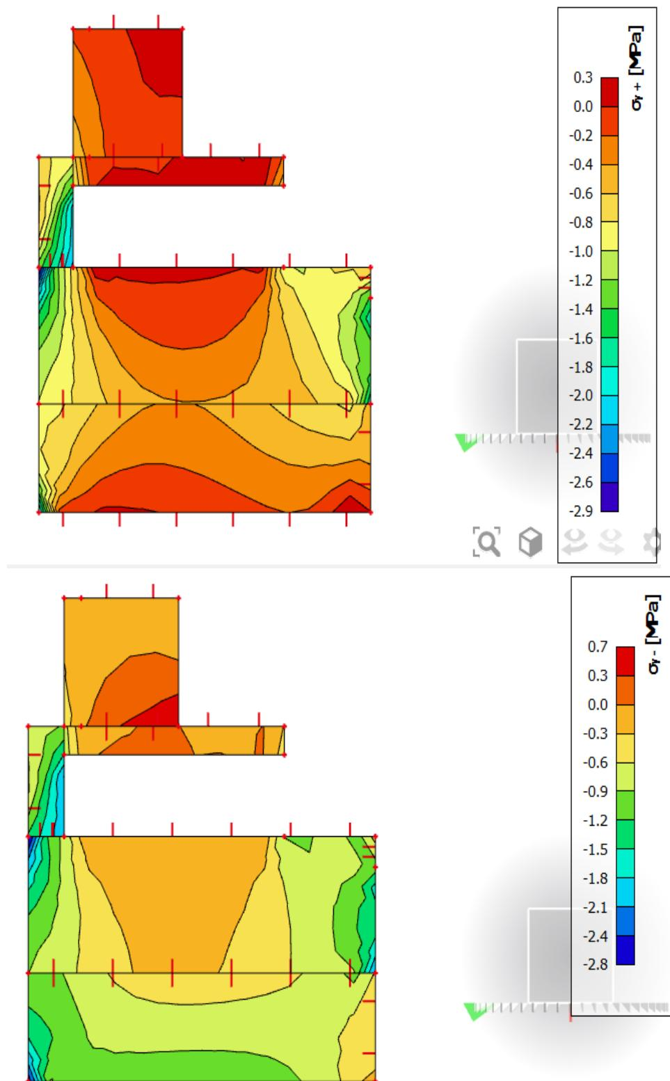
Slika 8.19. Naprezanja u smjeru y
