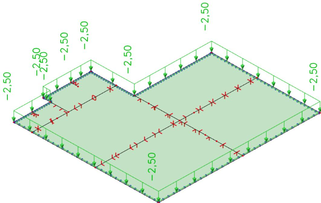
*Slika 6.1. Dodatno stalno opterećenje ( $\text{kN}/\text{m}^2$ )*
