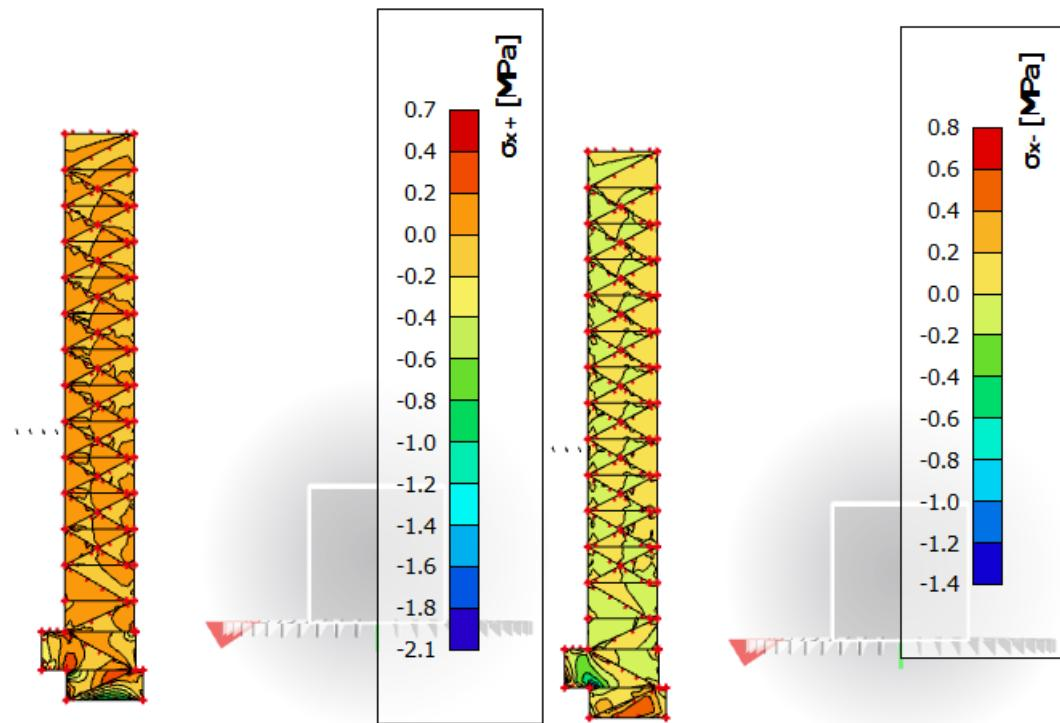
**Slika 8.27.** Naprezanja u smjeru x
