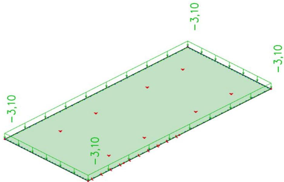
*Slika 6.42.* Dodatno stalno opterećenje ( $\text{kN}/\text{m}^2$ )
