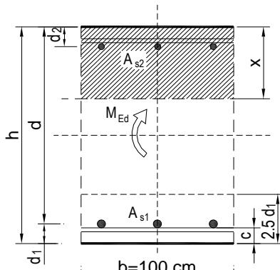
Dobivena karakteristična širina pukotine od 0,243 mm je manja od granične vrijednosti koja za AB konstrukcije iznosi 0,300 mm što znači da odabrana armatura zadovoljava.
