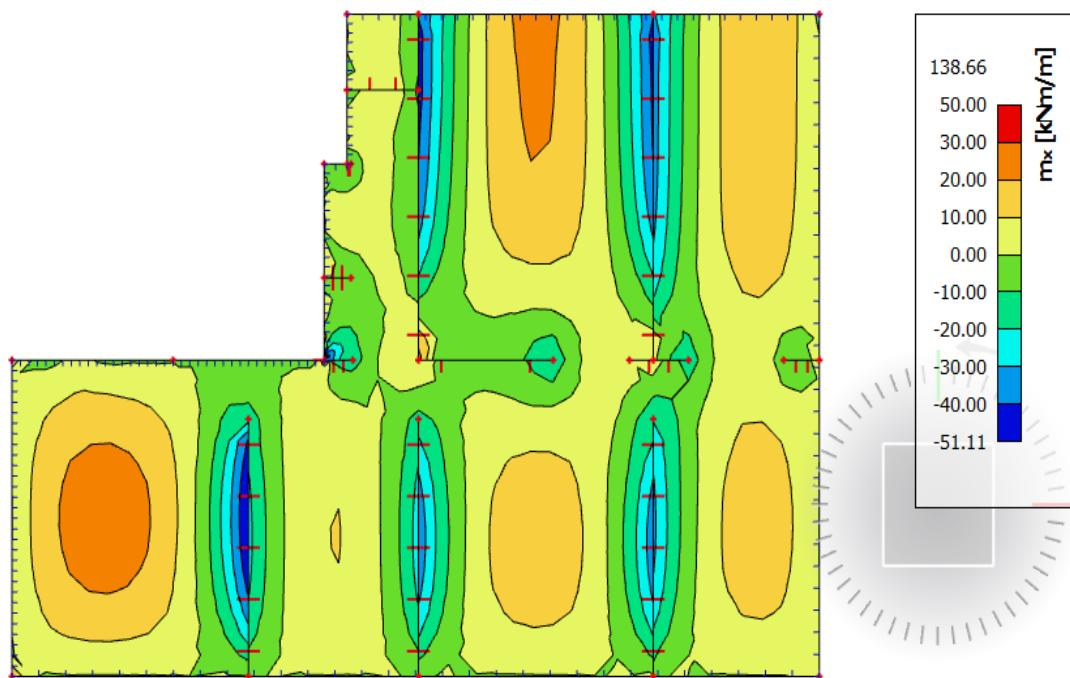
*Slika 6.14. Prikaz momenata savijanja na ležajevima  $M_x$  – GSN1*
