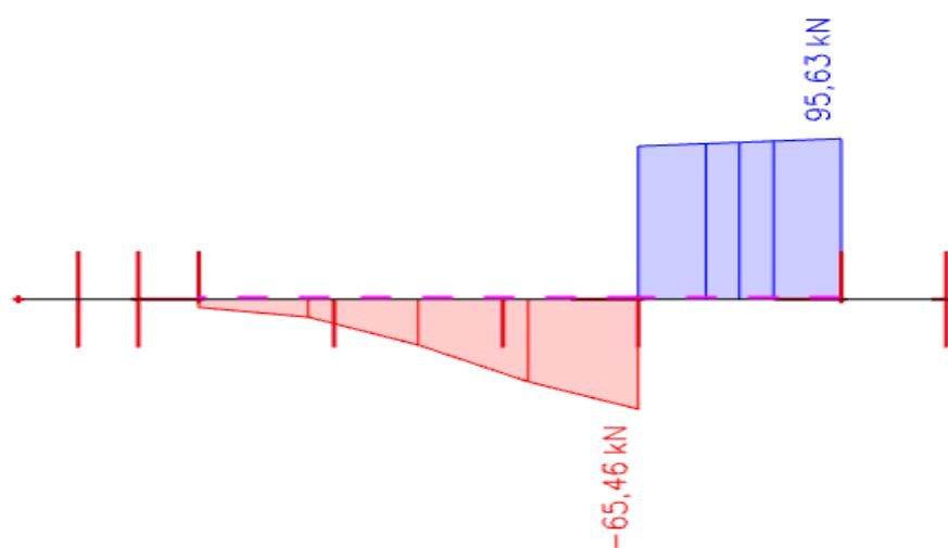
**Slika 7.4.** Prikaz poprečnih sila grede -  $V_z$
