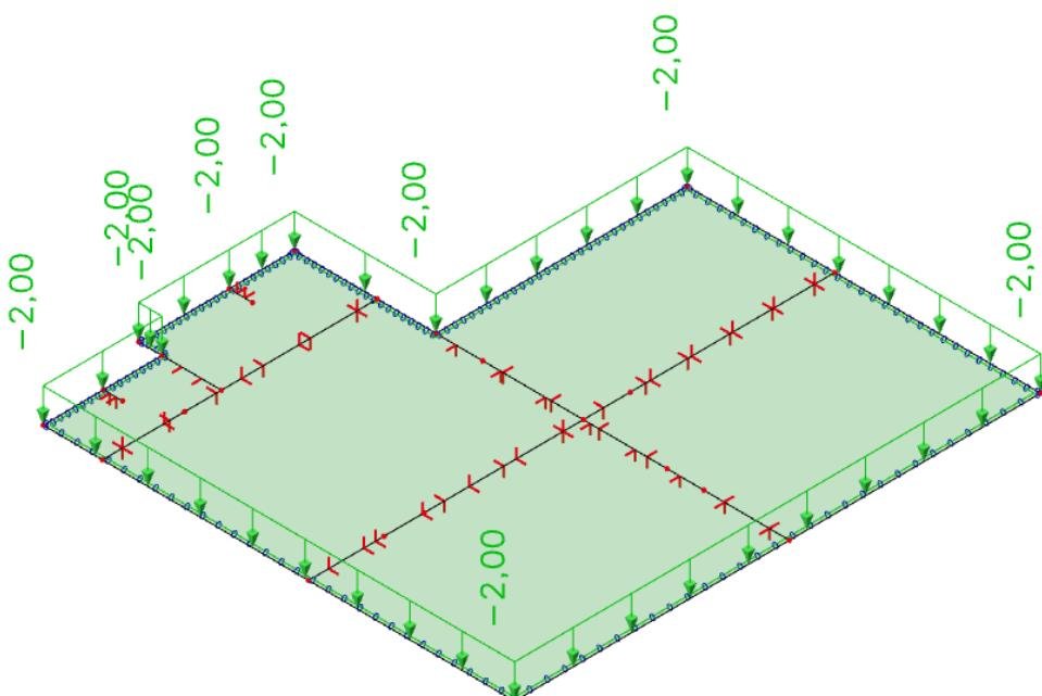
*Slika 6.2. Korisno opterećenje ( $\text{kN}/\text{m}^2$ )*
