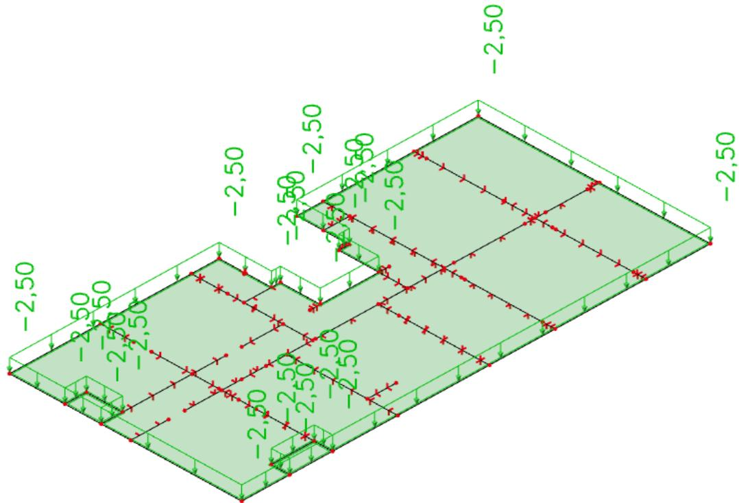
*Slika 6.19. Dodatno stalno opterećenje (kN/m<sup>2</sup>)*
