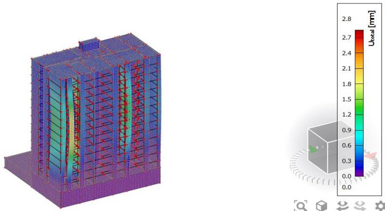
Slika 4.14. Prvi vlastiti vektor od djelovanja potresa na konstrukciju  $T_4=0,08 \text{ s}$
