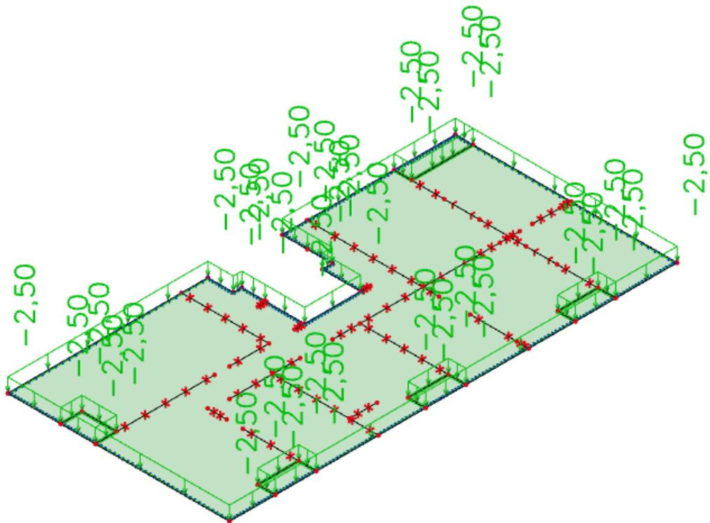
**Slika 6.28.** Dodatno stalno opterećenje ( $\text{kN/m}^2$ )
