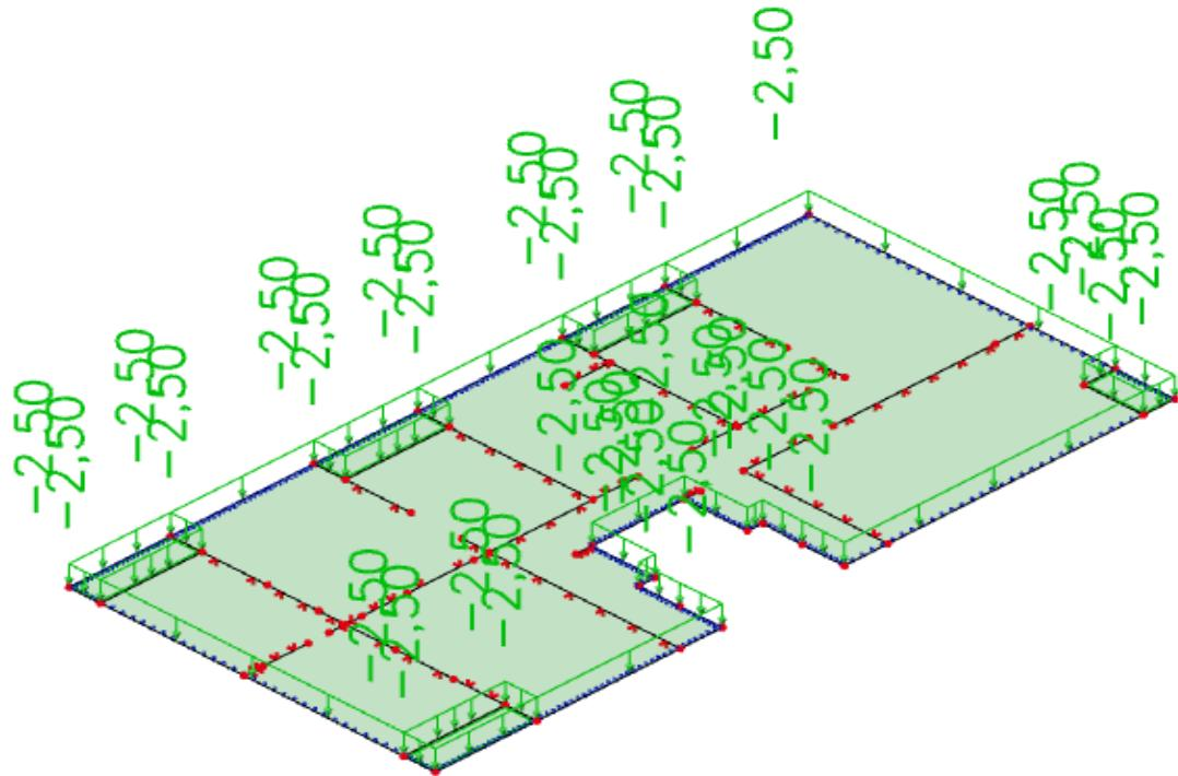
*Slika 6.28. Dodatno stalno opterećenje (kN/m<sup>2</sup>)*
