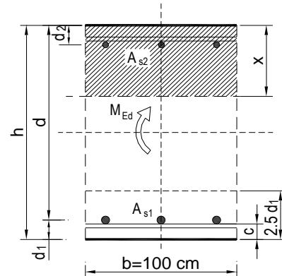
Dobivena karakteristična širina pukotine od 0,299 mm je manja od granične vrijednosti koja za AB konstrukcije iznosi 0,300 mm što znači da odabrana armatura zadovoljava.
