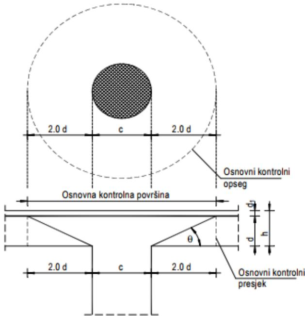
**Slika 8.13 Proboj ploče**
