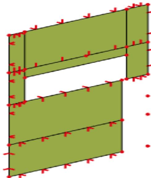
**Slika 8.20.** Prikaz visokostijenog nosača u modelu
