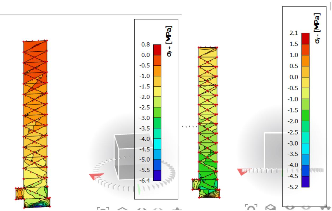
Slika 8.26. Naprezanja u smjeru y
