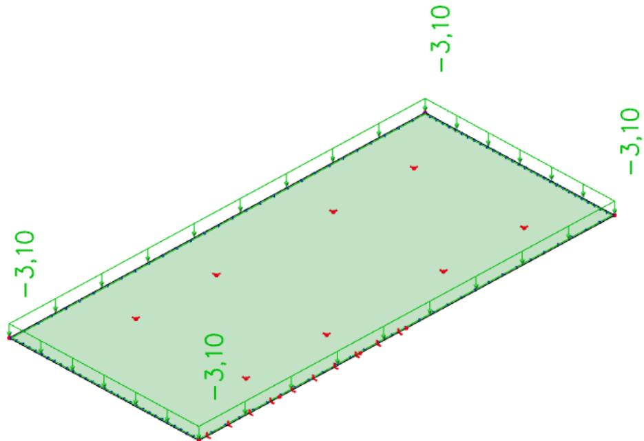
*Slika 6.30. Dodatno stalno opterećenje ( $\text{kN}/\text{m}^2$ )*
