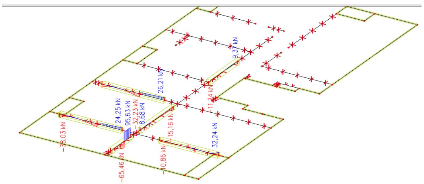
**Slika 7.2.** Prikaz poprečnih sila za grede pozicije 300
