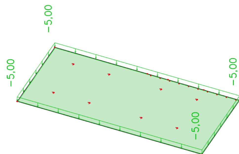
*Slika 6.43.* Korisno opterećenje ( $\text{kN}/\text{m}^2$ )
