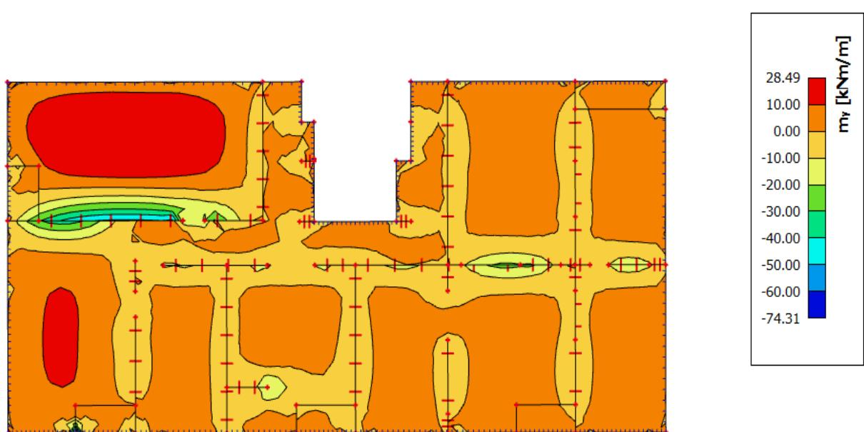
Slika 6.33. Prikaz momenata savijanja na ležajevima  $M_y$  – GSN1
