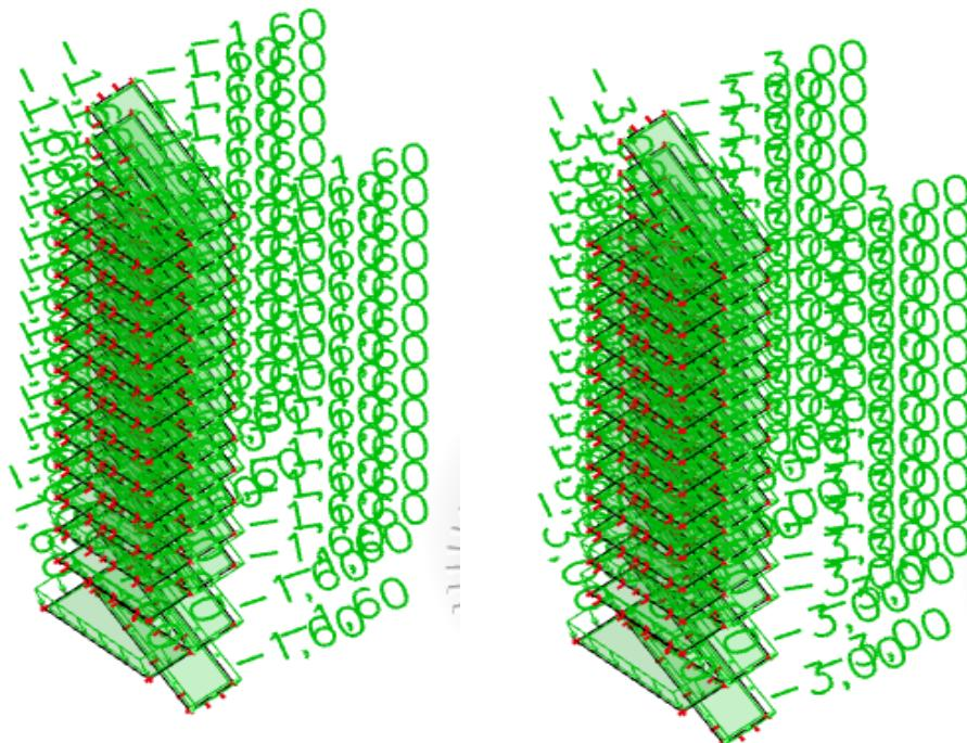
Slika 9.1. Dodatno stalno i pokretno opterećenje ( $\text{kN/m}^2$ )
