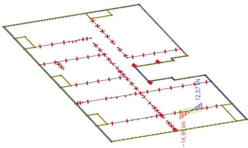
**Slika 7.8.** Prikaz poprečnih sila za grede pozicije 400,500,800,1100,1200,1300
