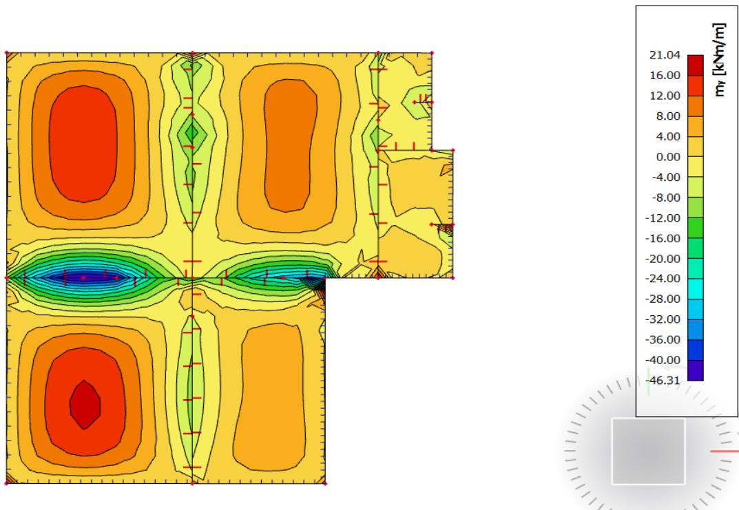
*Slika 6.5. Prikaz momenata savijanja na ležajevima  $M_x$  – GSN1*
