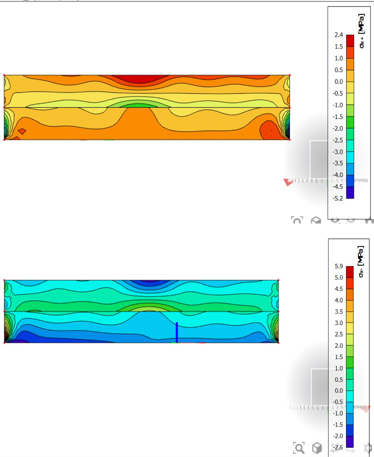
**Slika 8.31.** Naprezanja u smjeru x
