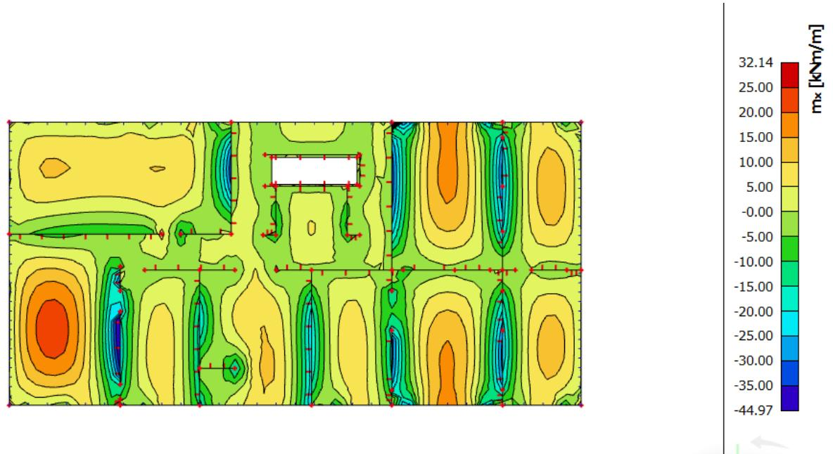
**Slika 6.32.** Prikaz momenata savijanja na ležajevima  $M_x - GSN1$
