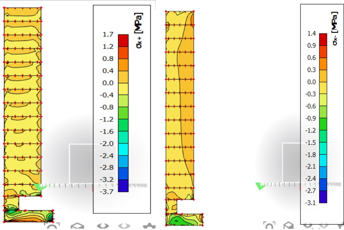
**Slika 8.35.** Naprezanja u smjeru x
