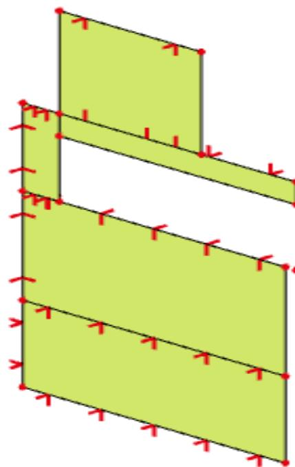
*Slika 8.15. Prikaz visokostijenog nosača u modelu*
