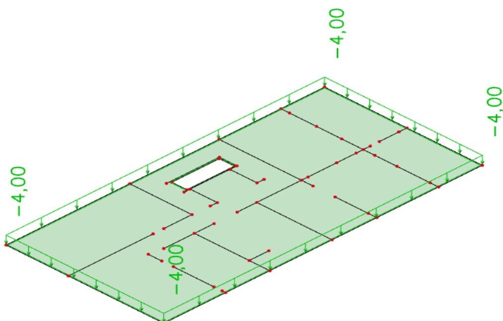
*Slika 6.30. Korisno opterećenje ( $\text{kN}/\text{m}^2$ )*
