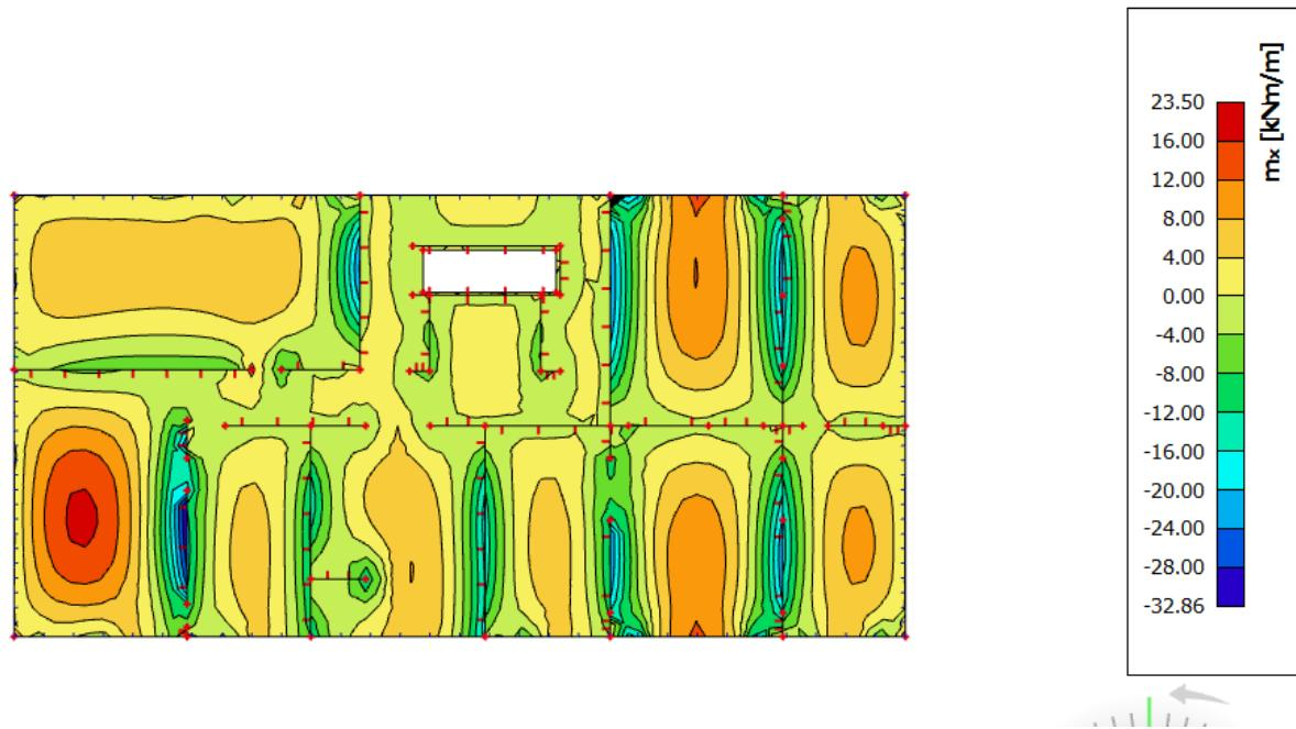
*Slika 6.36. Maksimalni momenti savijanja  $M_x$ , za kombinaciju GSU*
