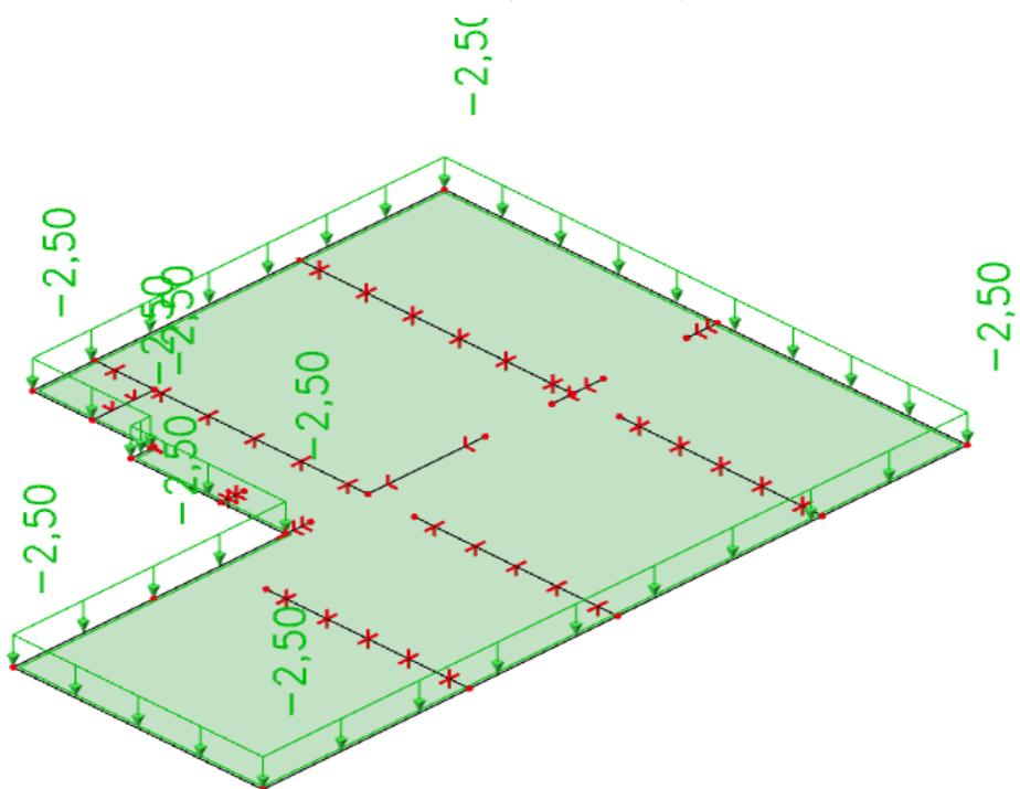
*Slika 6.10. Dodatno stalno opterećenje ( $\text{kN}/\text{m}^2$ )*
