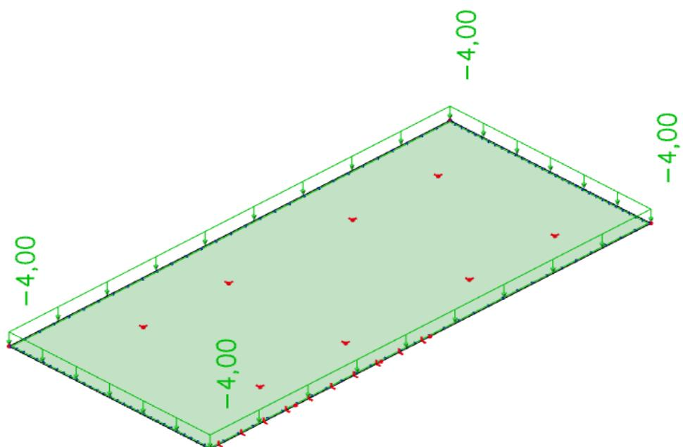
*Slika 6.31. Korisno opterećenje ( $\text{kN}/\text{m}^2$ )*
