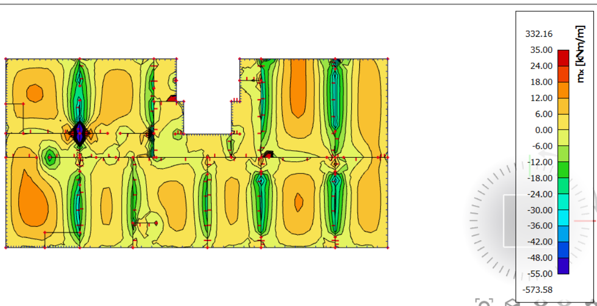
Slika 6.25. Maksimalni momenti savijanja M_x , za kombinaciju GSU
