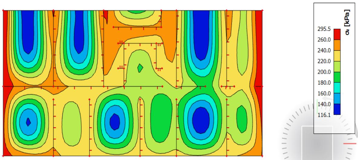
**Slika 10.1.** Naprezanja u tlu za kvazistalnu kombinaciju 1,0G+1,0Q
