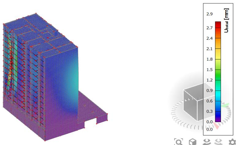
Slika 4.15. Drugi vlastiti vektor od djelovanja potresa na konstrukciju  $T_5=0,08 \text{ s}$
