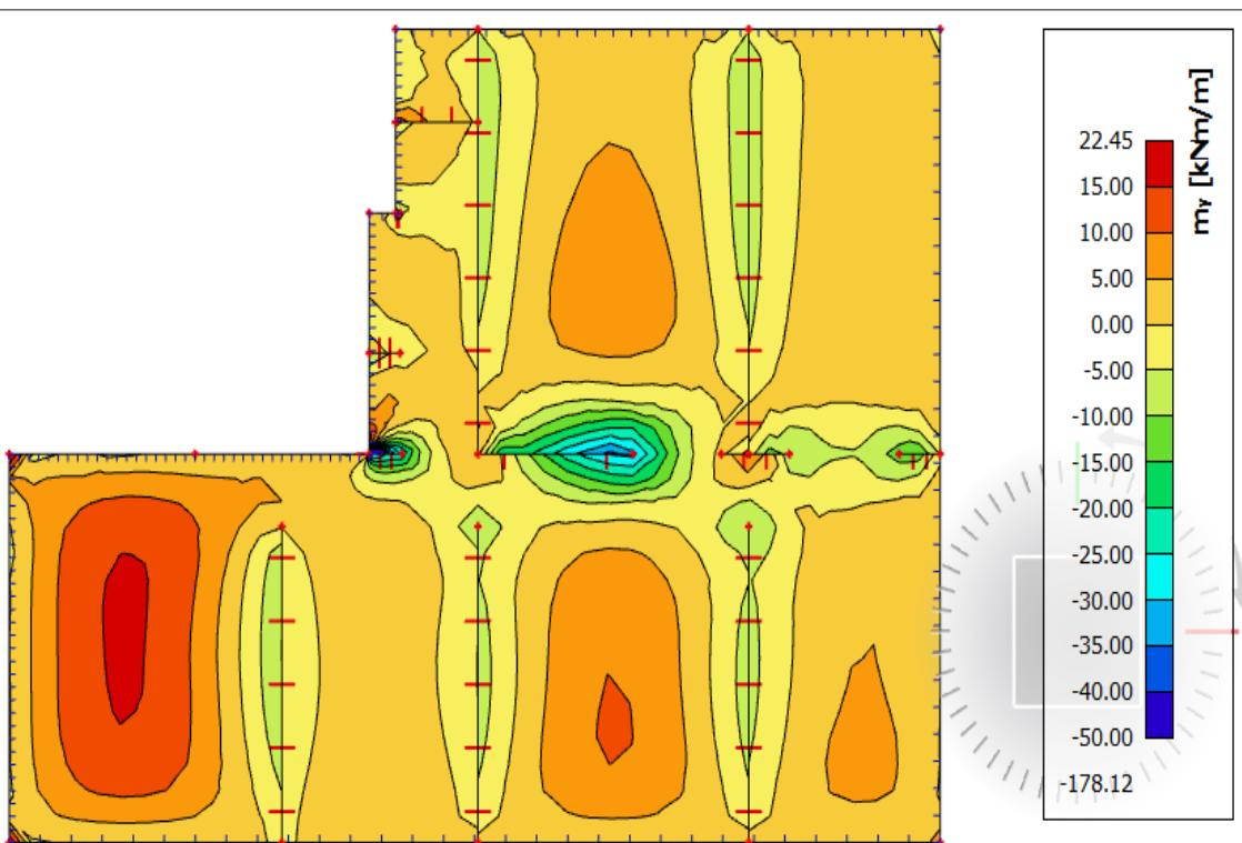
*Slika 6.15. Prikaz momenata savijanja na ležajevima  $M_y$  – GSN1*
