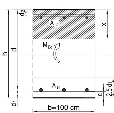
Dobivena karakteristična širina pukotine od 0.269 mm je manja od granične vrijednosti koja za AB konstrukcije iznosi 0.300 mm što znači da odabrana armatura zadovoljava.
