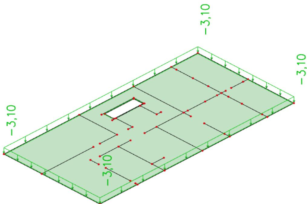
*Slika 6.29. Korisno opterećenje ( $\text{kN}/\text{m}^2$ )*
