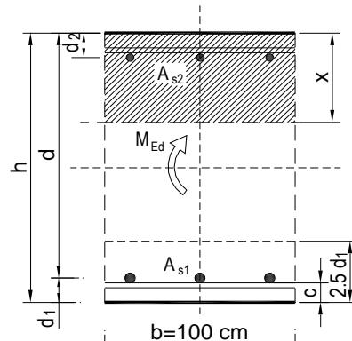
Dobivena karakteristična širina pukotine od 0.299 mm je manja od granične vrijednosti koja za AB konstrukcije iznosi 0.300 mm što znači da odabrana armatura zadovoljava.
