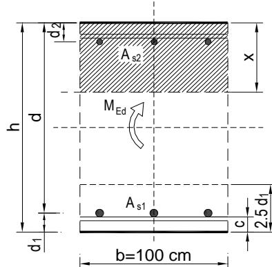
Dobivena karakteristična širina pukotine od 0,237 mm je manja od granične vrijednosti koja za AB konstrukcije iznosi 0,300 mm što znači da odabrana armatura zadovoljava.
