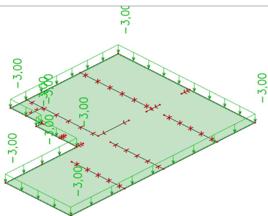
*Slika 6.11. Korisno opterećenje ( $\text{kN}/\text{m}^2$ )*
