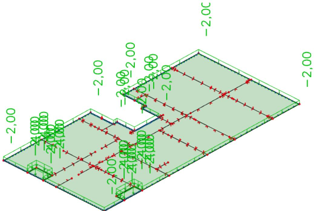
*Slika 6.20. Promjenjivo opterećenje (kN/m<sup>2</sup>)*
