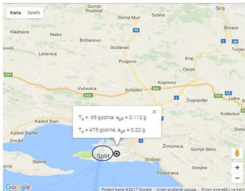
Slika 8.21. Očitano ubrzanje za područje grada Splita
