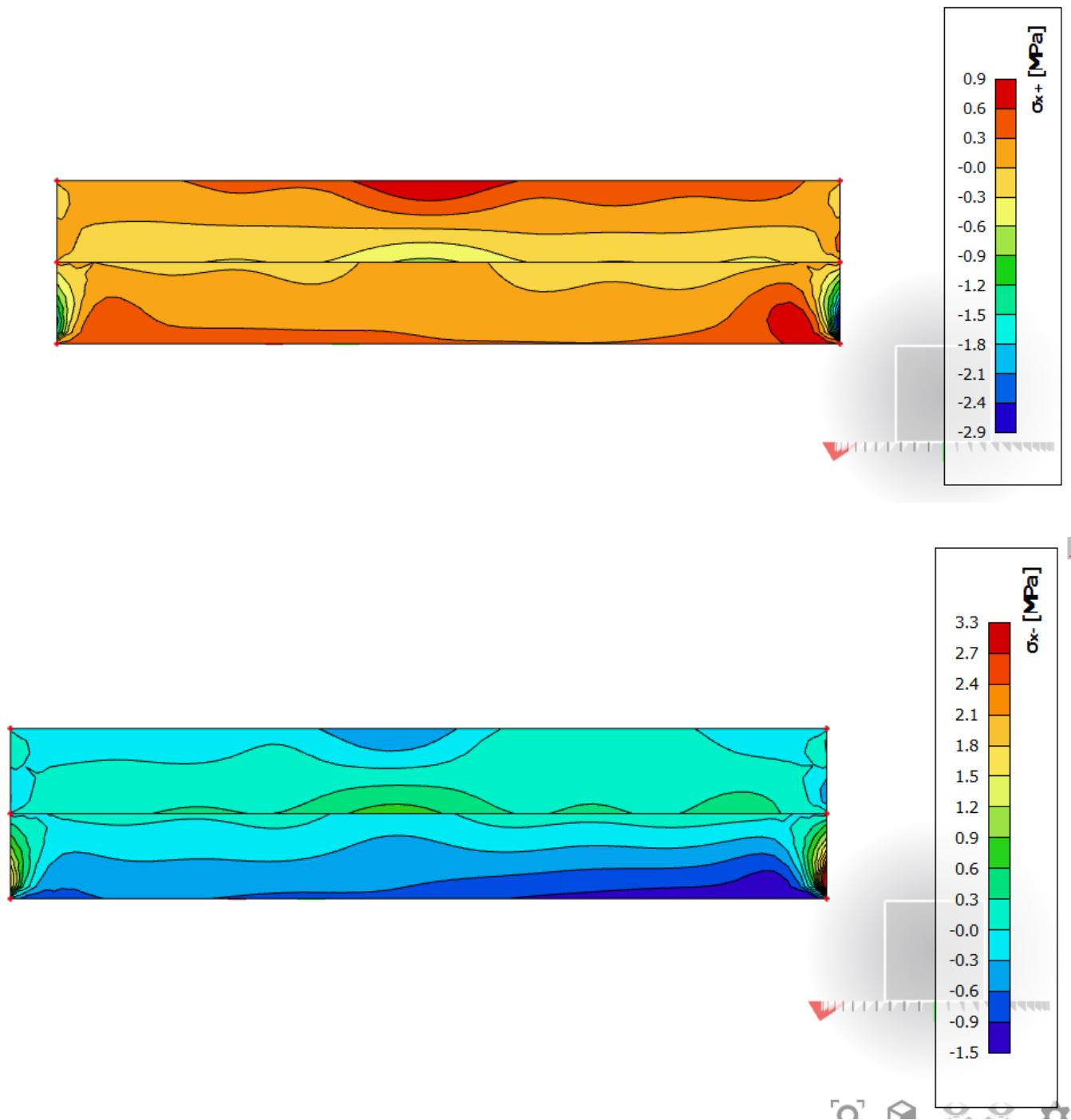
**Slika 8.31.** Naprezanja u smjeru x
