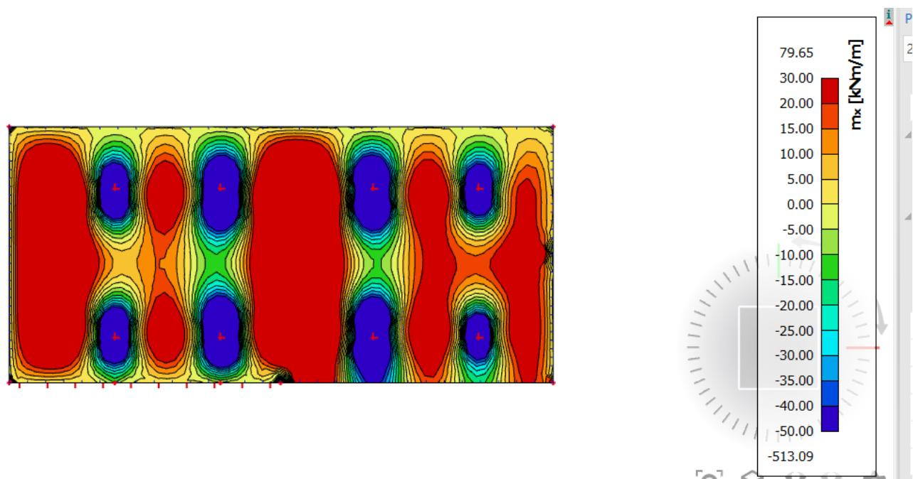
Slika 6.44. Prikaz momenata savijanja na ležajevima  $M_x$  – GSN1
