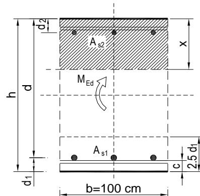
Dobivena karakteristična širina pukotine od 0,228 mm je manja od granične vrijednosti koja za AB konstrukcije iznosi 0,300 mm što znači da odabrana armatura zadovoljava.
