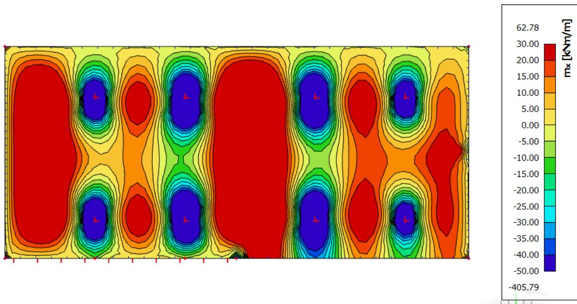
**Slika 6.40.** Prikaz momenata savijanja na ležajevima  $M_x - GSN1$
