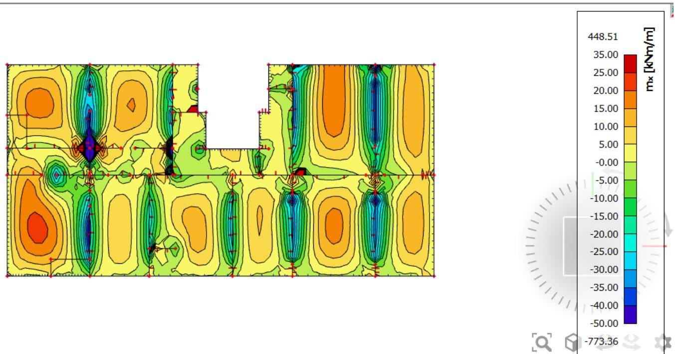
**Slika 6.23.** Prikaz momenata savijanja na ležajevima  $M_x$  – GSN1
