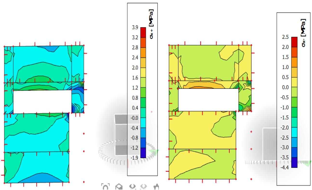
**Slika 8.23.** Naprezanja u smjeru x
