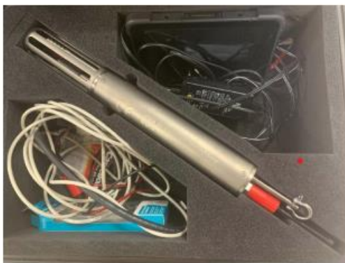
Slika 7. CTD/DO sonda za vertikalno profiliranje parametara: tlak, salinitet, temperatura i otopljeni kisik [42]
