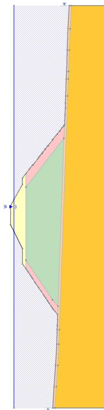
Slika 7. Model primarnog lukobrana sa saniranim pokosom nasipa
