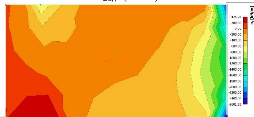
C3y) Proračunske vlačne sile za ANV 1: n_{Ed,y} (kN/m)
