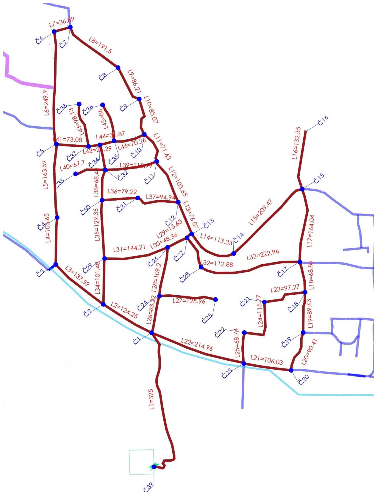
Slika 3. Izdvojeni dio vodovodne mreže naselja Preko za hidraulički proračun
