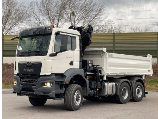
Slika 9. Kamion kiper MAN TGS 28.430 [2]
