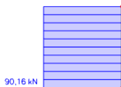
Slika 13.18. Maksimalna poprečna sila za kombinaciju GSN
