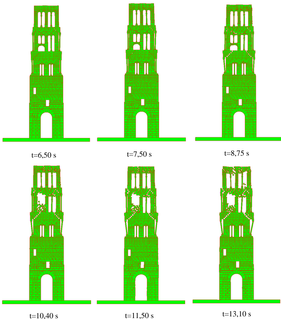
Slika 13. Nastanak i širenje pukotina za potres Petrovac, a_g=0.35g
