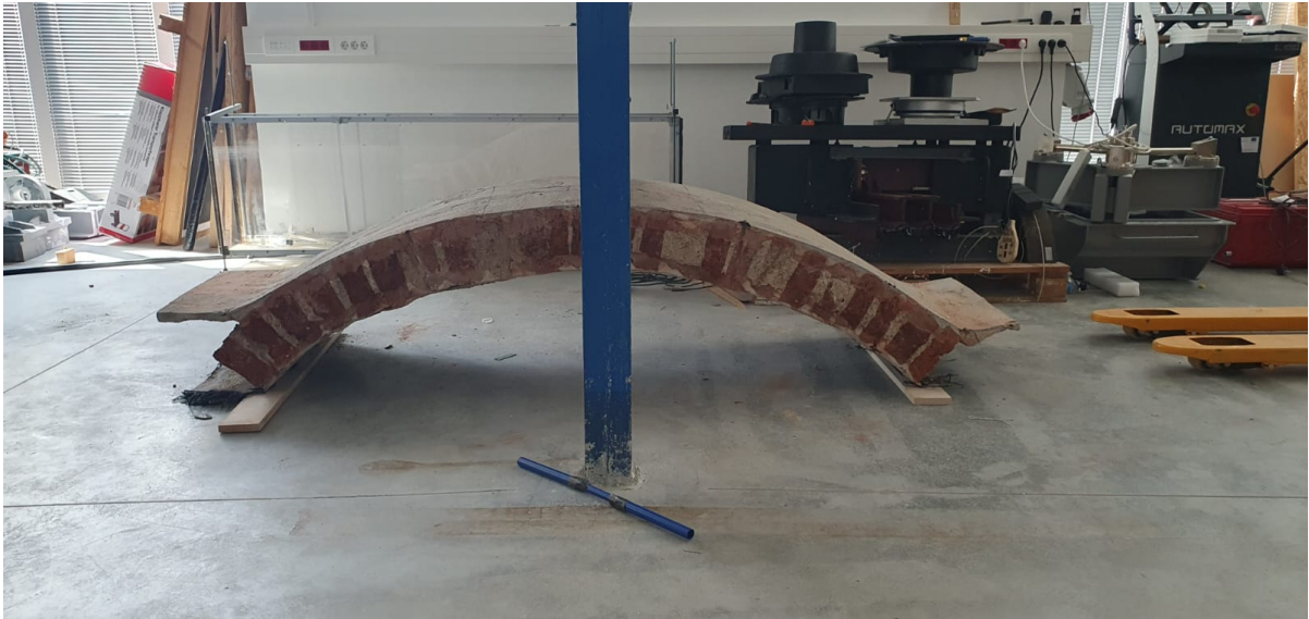
Fotografija 2.11 – Svod na mjestu ispitivanja
