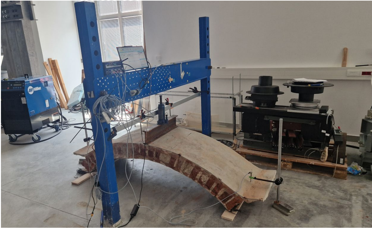
Fotografija 2.15 – Postavljanje pojačala i konvertera te računala
