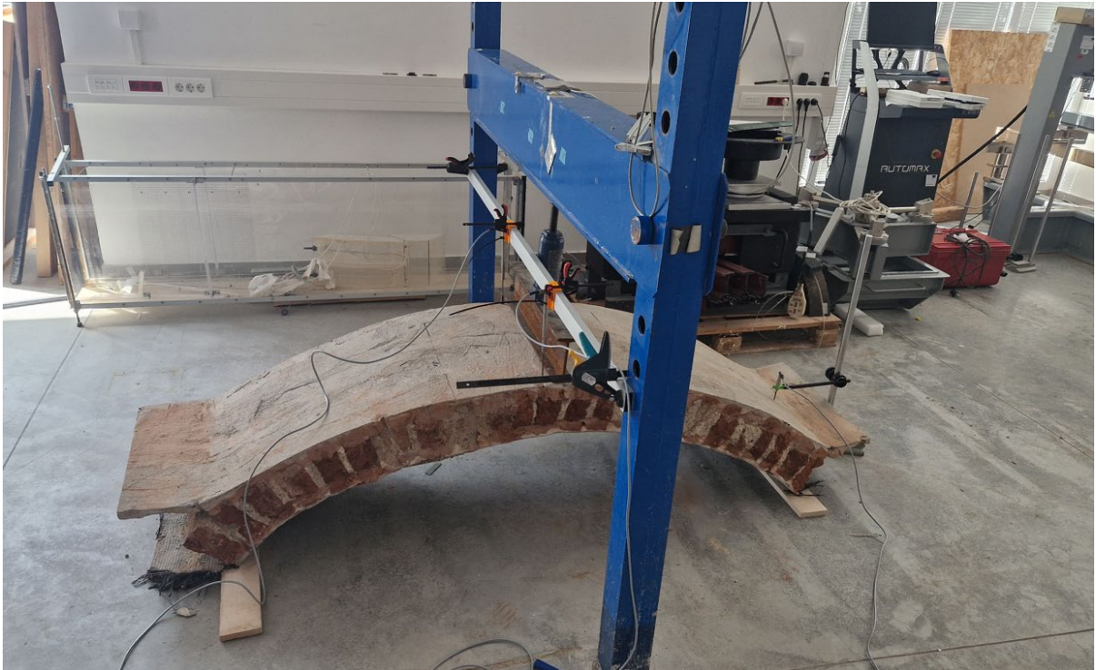
Fotografija 2.13 – Postavljanje senzora deformacije i progiba
