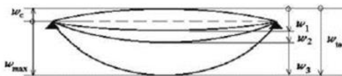
Slika 7.3 Prikaz progiba grede
