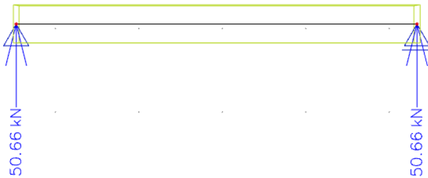
slika 11. reakcije na ležajevima uzrokovane opterećenjem q_1=21.11\text{kN/m} [4]
