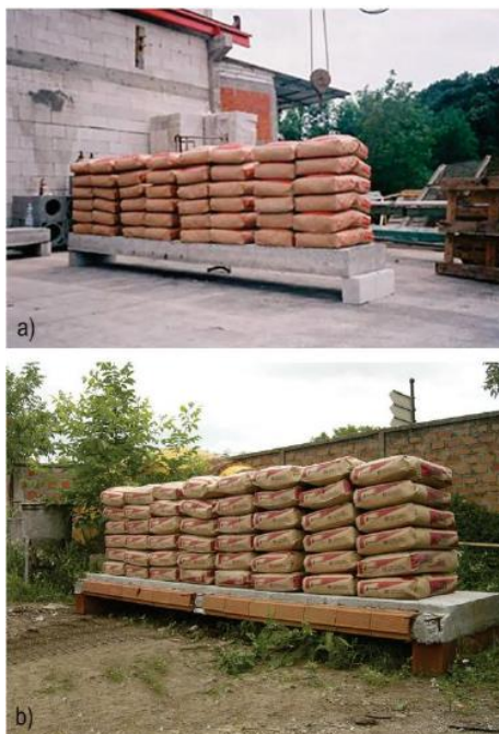
Slika 18. a) SSLC armiranobetonska ploča raspona 4 metra b) obična polugotova FERT podna ploča raspona 4 metra [25]
