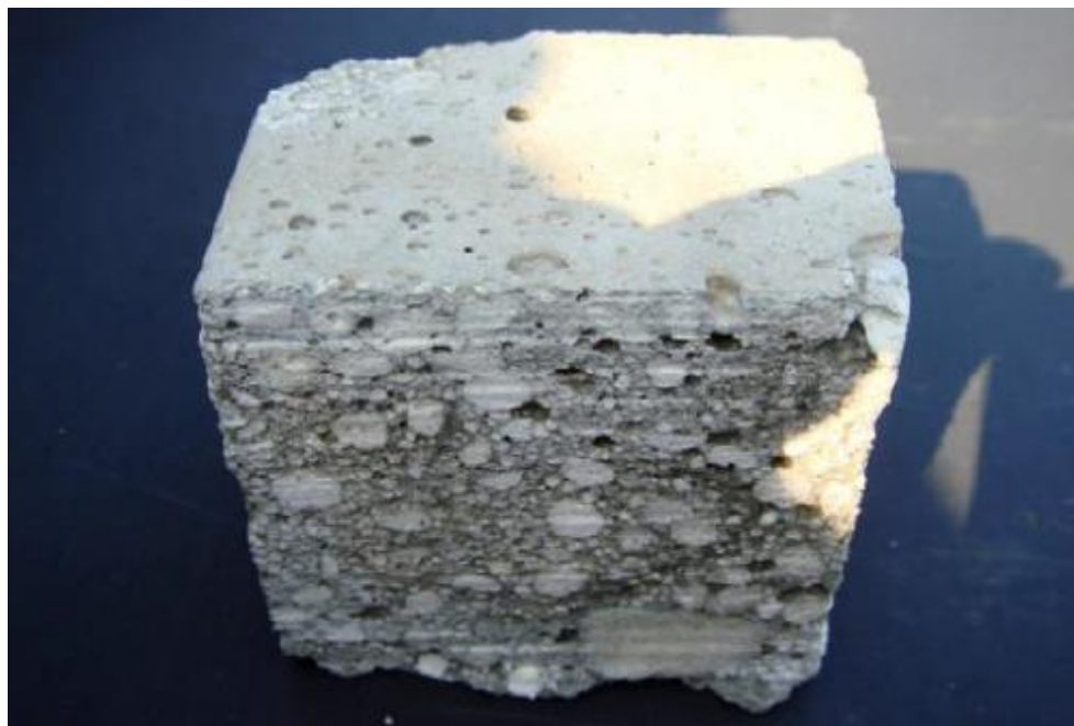
Slika 8. Uzorak betona s otpadnim LWC agregatima koji sadrže ekspanzirano staklo [16]
