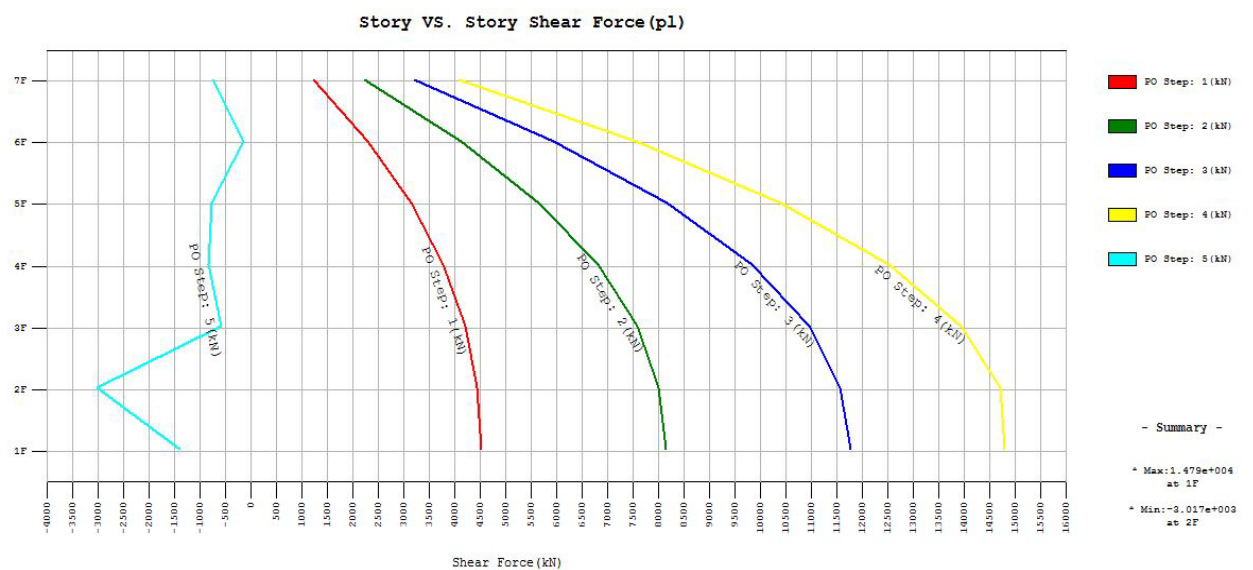
Crtež 5.45. Prikaz raspodjele poprečnih sila za pojedini inkrement opterećenja (kN)
