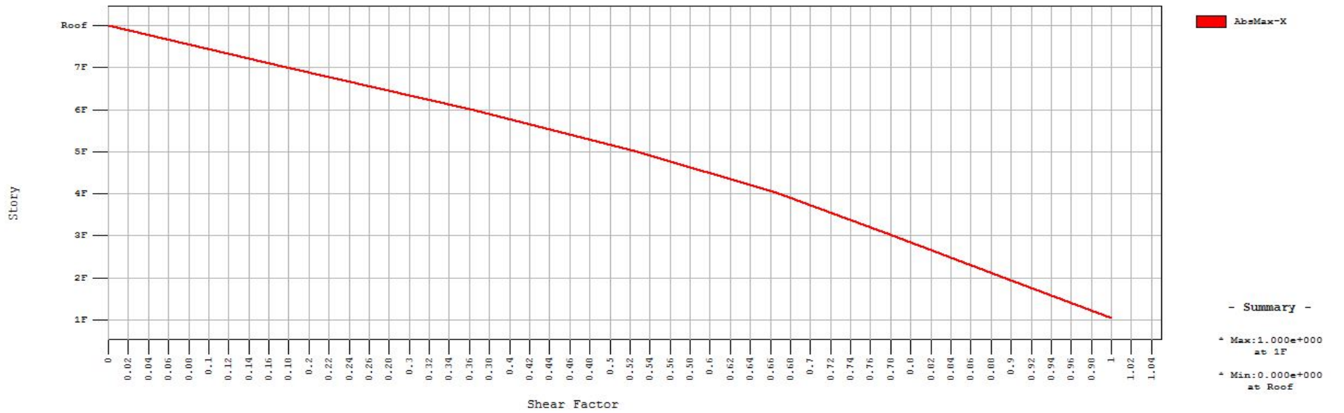
Crtež 5.78. Prikaz raspodjele poprečnih sila po etažama
