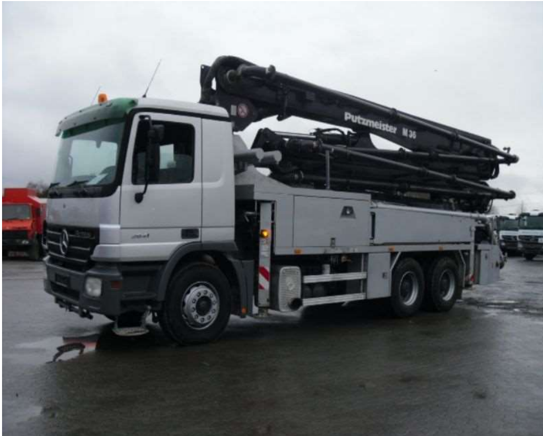
Slika 3.10 Pumpa za beton Mercedes-Benz 2641 Putzmeister 36m [4]
