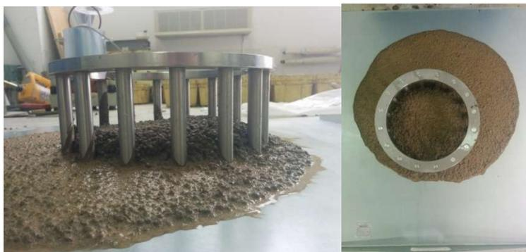
**Slika 7.15:** Ispitivanje J-prstenom - mješavina L1
