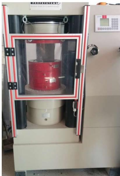
*Slika 8.1: Preša za ispitivanje tlačne čvrstoće betona*
