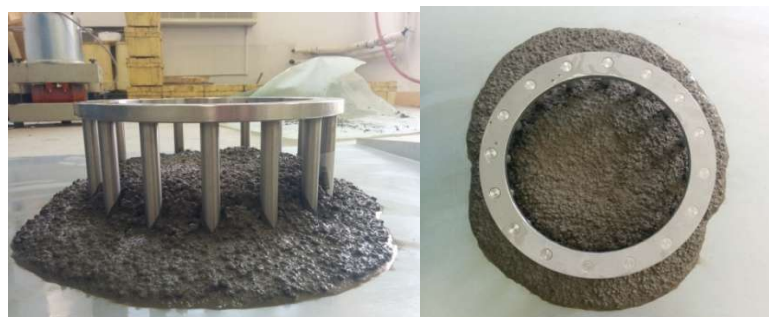
Slika 7.20: Ispitivanje J-prstenom - mješavina L6
