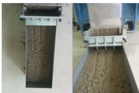
**Slika 7.27:** Ispitivanje L-posudom – mješavina L5
