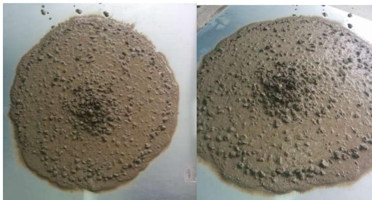
**Slika 7.5:** Rasprostiranje slijeganjem mješavine L3
