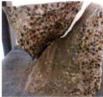
*Slika 5.11: Mješavina 2; vertikalni lom i smicanje[17]*
