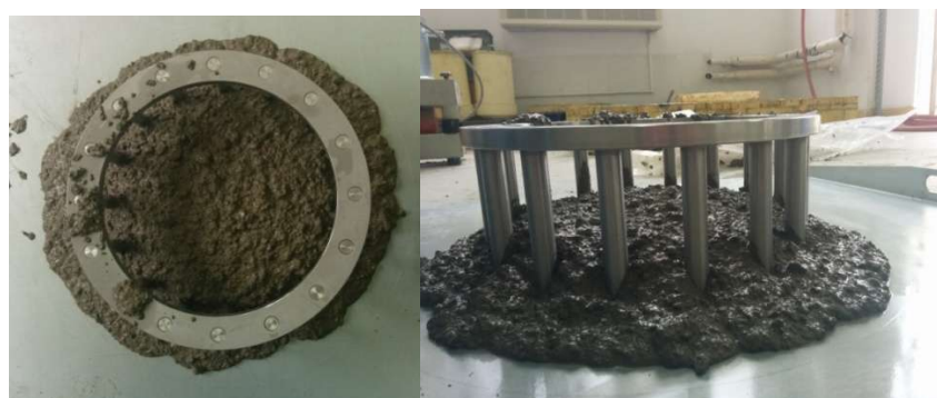
Slika 7.19: Ispitivanje J-prstenom - mješavina L5
