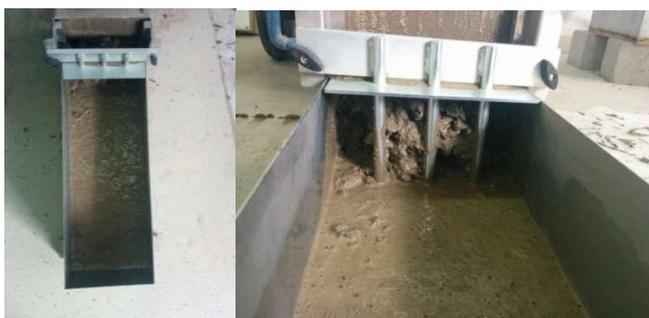
**Slika 7.25:** Ispitivanje L-posudom – mješavina L3
