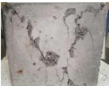
*Slika 5.9: Mješavina 1; vertikalni lom[17]*
