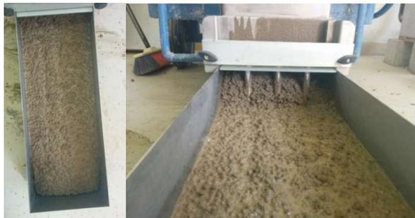
**Slika 7.24:** Ispitivanje L-posudom – mješavina L2
