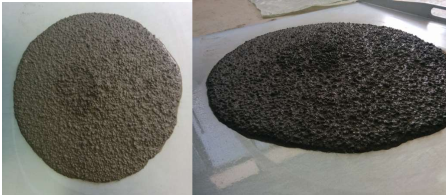
Slika 7.8: Rasprostiranje slijeganjem mješavine L6
