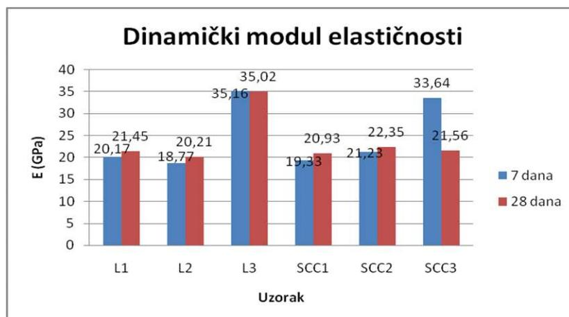
**Slika 8.5:** Grafički prikaz dinamičkog modula elastičnosti L i SCC betona nakon 7 i 28 dana
