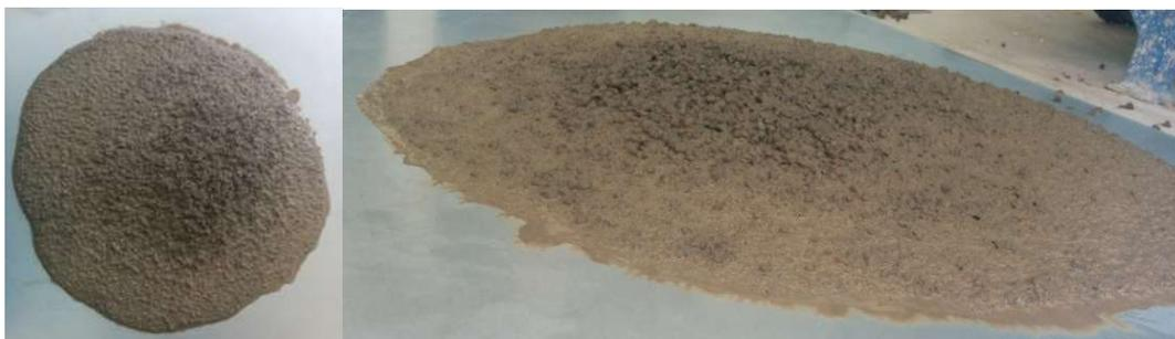
**Slika 7.4:** Rasprostiranje slijeganjem mješavine L2
