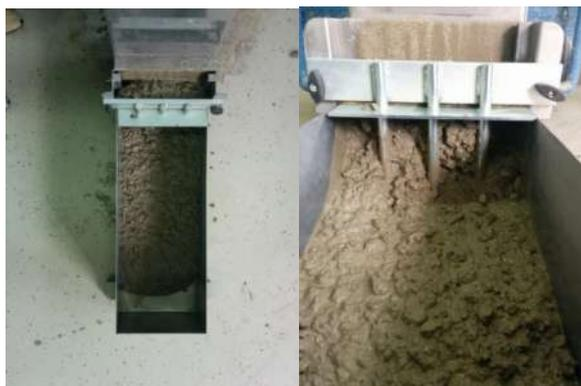
**Slika 7.26:** Ispitivanje L-posudom – mješavina L4
