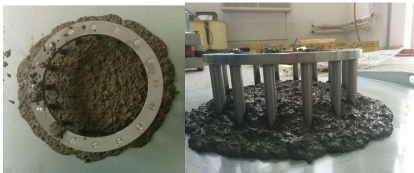
**Slika 7.19:** Ispitivanje J-prstenom - mješavina L5
