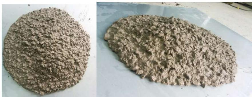
**Slika 7.6:** Rasprostiranje slijeganjem mješavine L4
