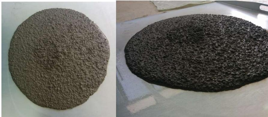
**Slika 7.8:** Rasprostiranje slijeganjem mješavine L6
