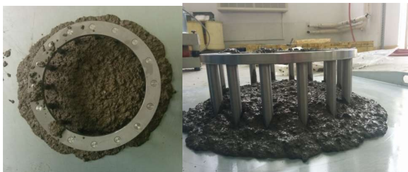
Slika 7.19: Ispitivanje J-prstenom - mješavina L5
