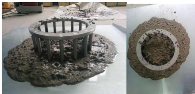
**Slika 7.17:** Ispitivanje J-prstenom - mješavina L3
