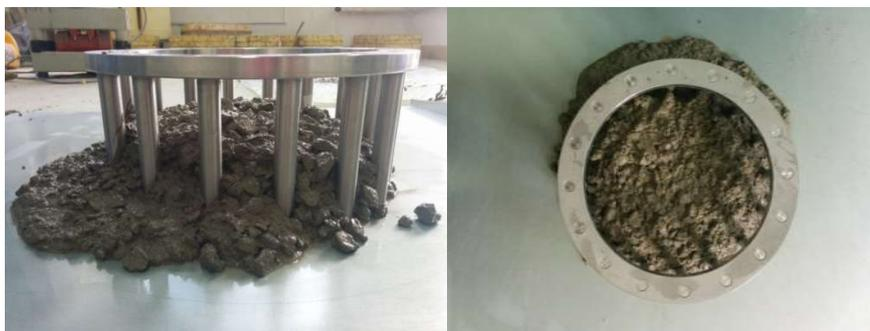
**Slika 7.18:** Ispitivanje J-prstenom - mješavina L4
