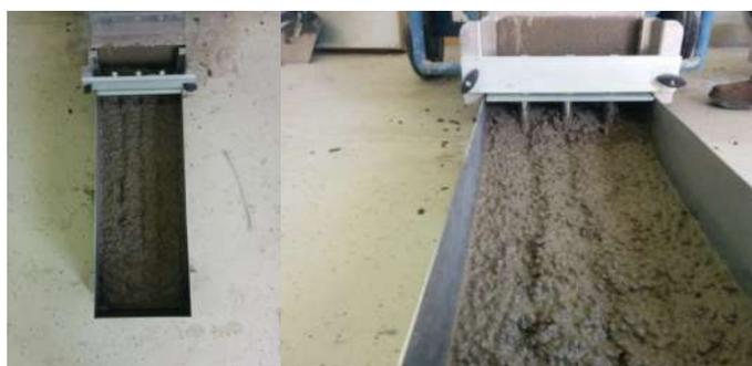
**Slika 7.28:** Ispitivanje L-posudom – mješavina L6
