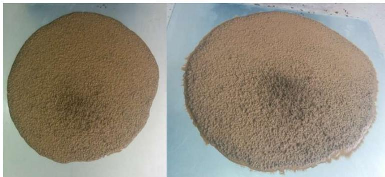
**Slika 7.3:** Rasprostiranje slijeganjem mješavine L1
