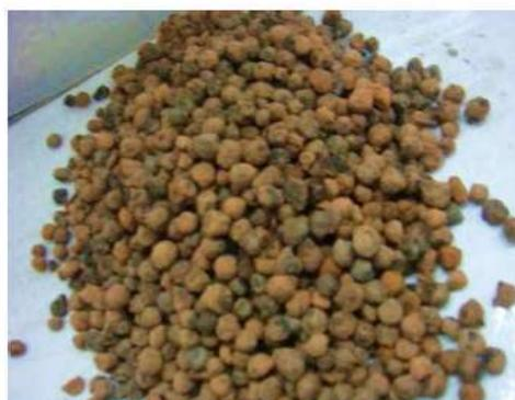
**Slika 5.6:** a) granulometrijski sastav završnog agregata (lijevo); b) prikaz laganog agregata od letećeg pepela (desno) [17]
