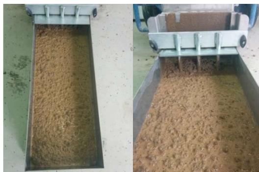
**Slika 7.23:** Ispitivanje L-posudom – mješavina L1
