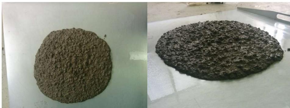
**Slika 7.7:** Rasprostiranje slijeganjem mješavine L5
