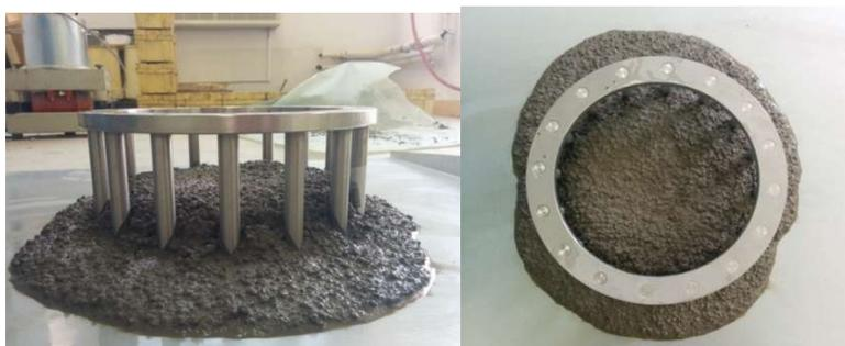
**Slika 7.20:** Ispitivanje J-prstenom - mješavina L6
