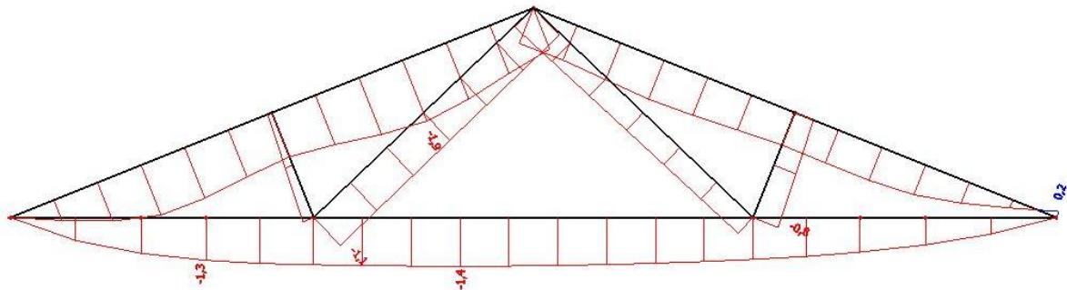
$$1) \quad W_{S,inst} \leq L/300 = 53,33 \text{ mm} \rightarrow 9,2 \text{ mm} \leq 53,33 \text{ mm}$$
