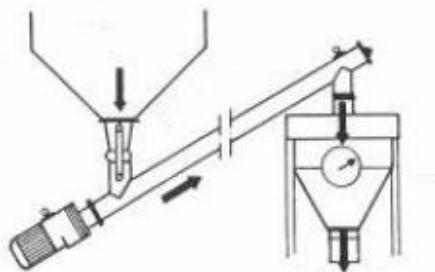
Slika 3. Cementna vaga s dobavljačkom cijevi, kinematika
