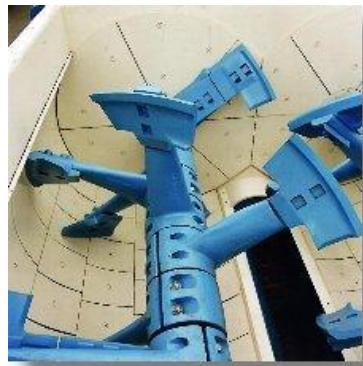
Slika 7. Prisilna mješalica s horizontalnom osovinom
