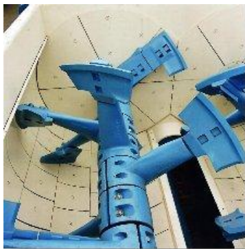
Slika 7. Prisilna mješalica s horizontalnom osovinom
