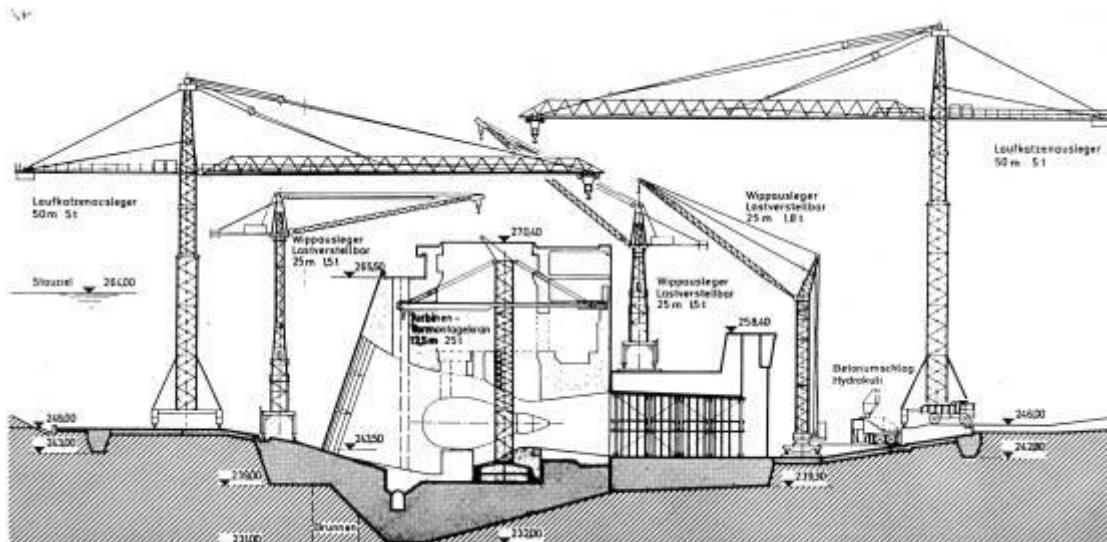
Slika 8. Primjer izvedbe transportnog sustava toranjskih dizalica
