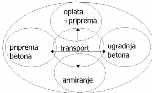
**Slika 1. Gradnja s betonom kao sistem isprepletenih lanaca**
