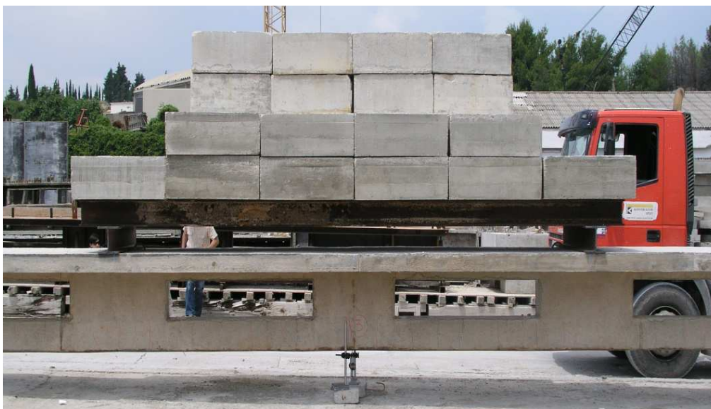
Slika 3.6. IV faza opterećenja (18 betonskih blokova)
