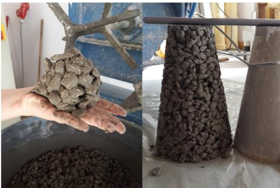
Slika 5.5 Ispitivanje konzistencije mješavina B 5 i B 6
