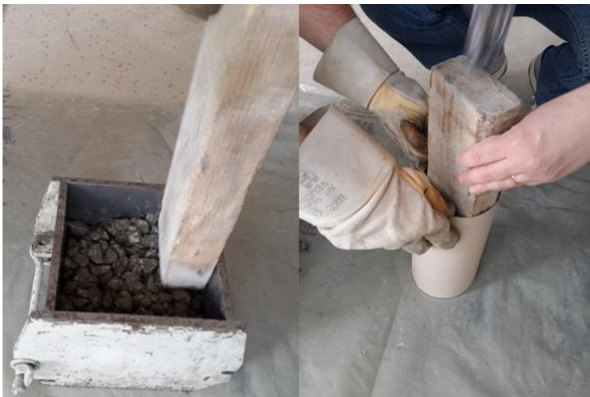
Slika 4.9 Zbijanje uzoraka pri ugradnji prva dva sloja poroznog betona
