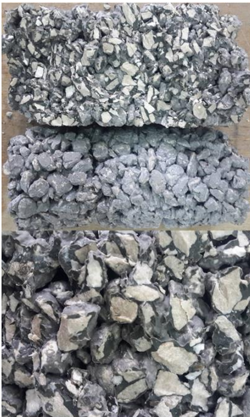
Slika 5.15 Raspored i količina šupljina mješavine B 7
