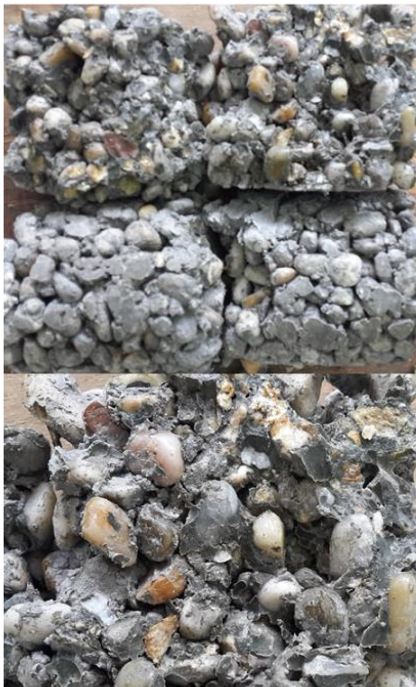
Slika 5.10 Raspored i količina šupljina mješavine B 2
