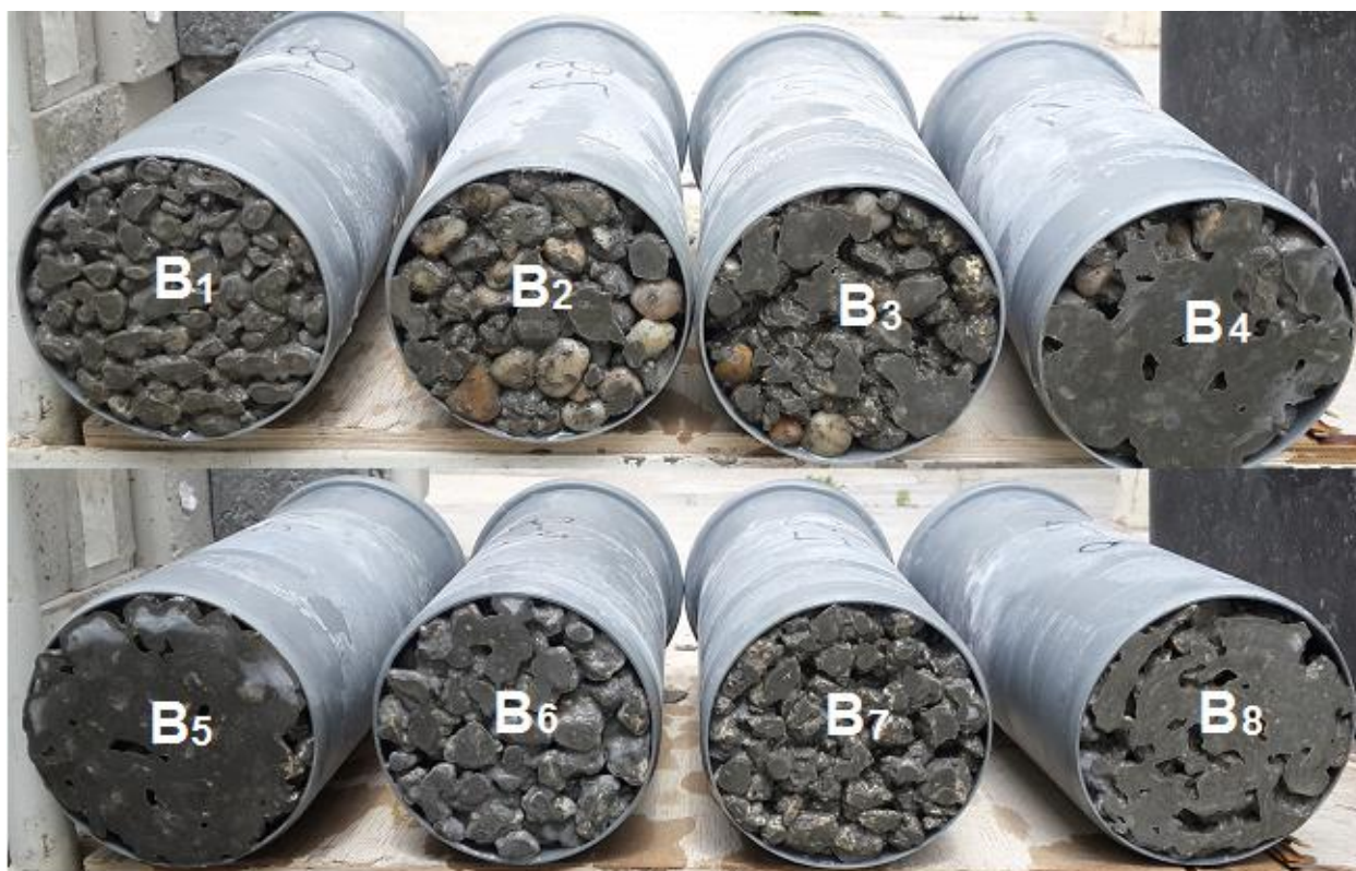
Slika 5.19 Segregacija cementne paste na uzorcima oblika valjka
