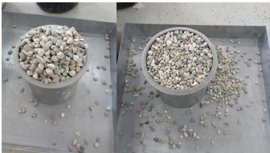
Slika 4.7 Mjerenje nasipne gustoće agregata
