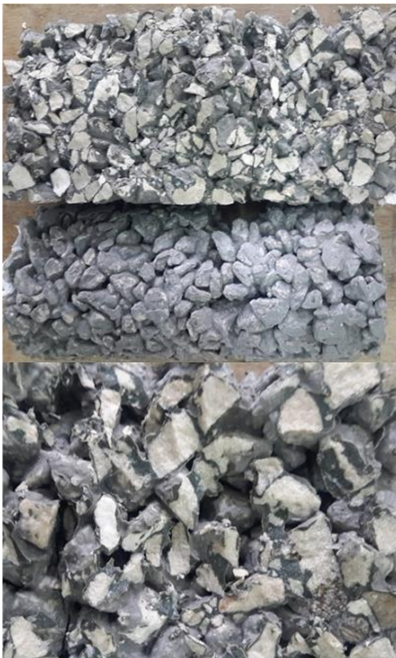
Slika 5.16 Raspored i količina šupljina mješavine B 8
