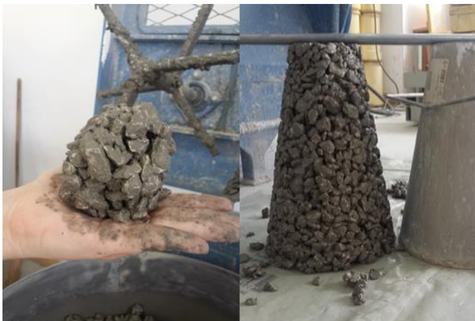
Slika 5.6 Ispitivanje konzistencije mješavine B 7
