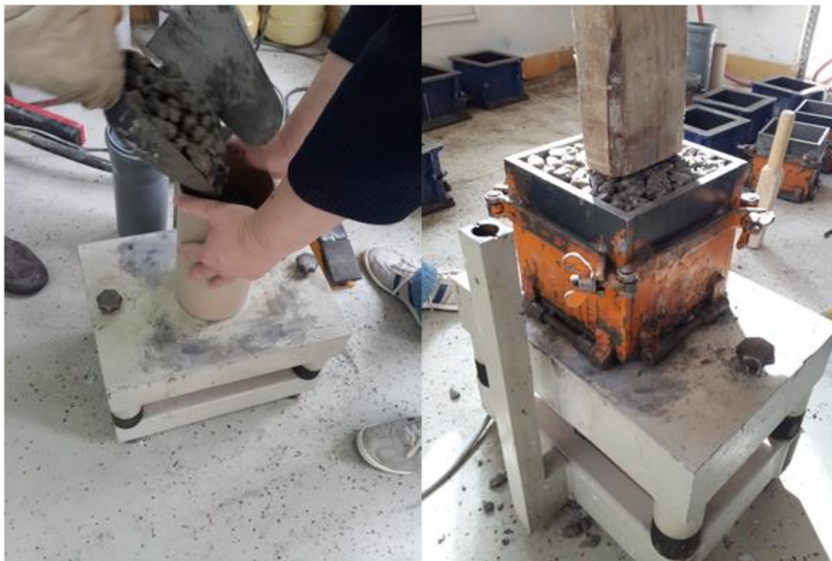
Slika 4.11 Ugrađivanje uzoraka vibriranjem na vibrostolu
