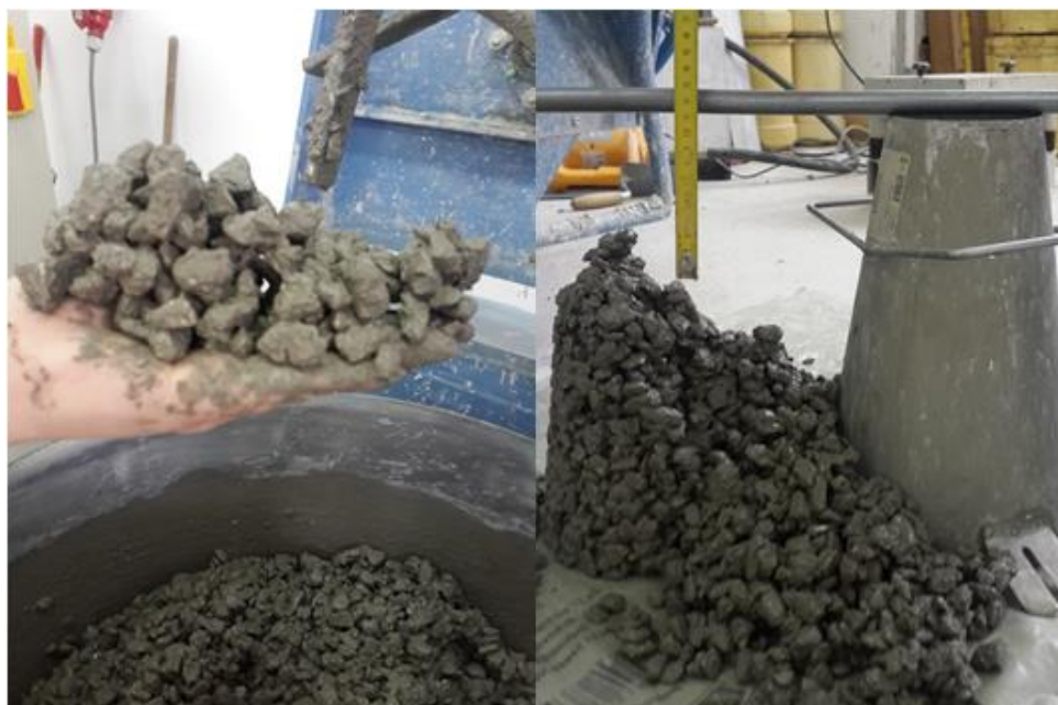
Slika 5.7 Ispitivanje konzistencije mješavine B 8
