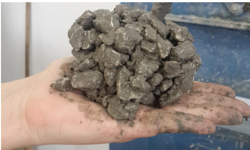
Slika 4.15 Ispitivanje konzistencije metodom oblikovanja kuglice
