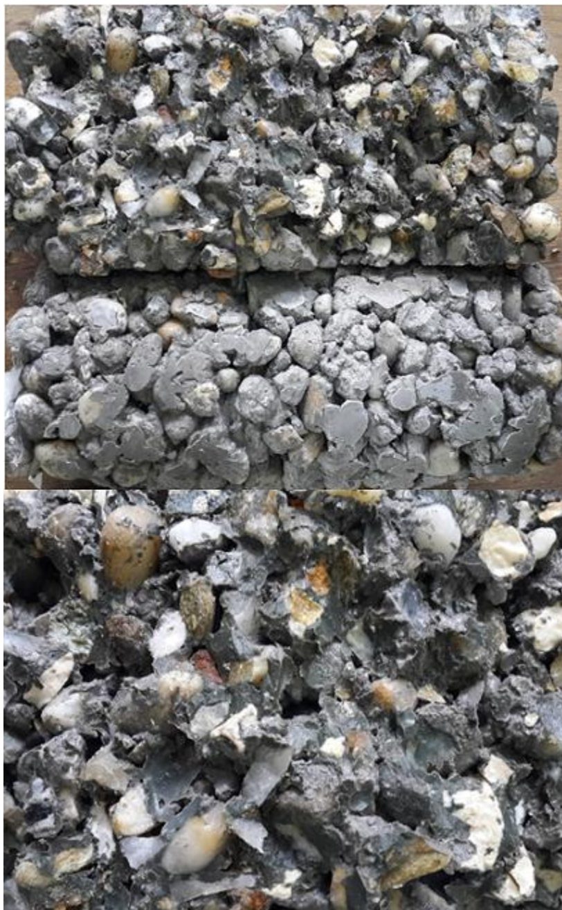
Slika 5.11 Raspored i količina šupljina mješavine B 3
