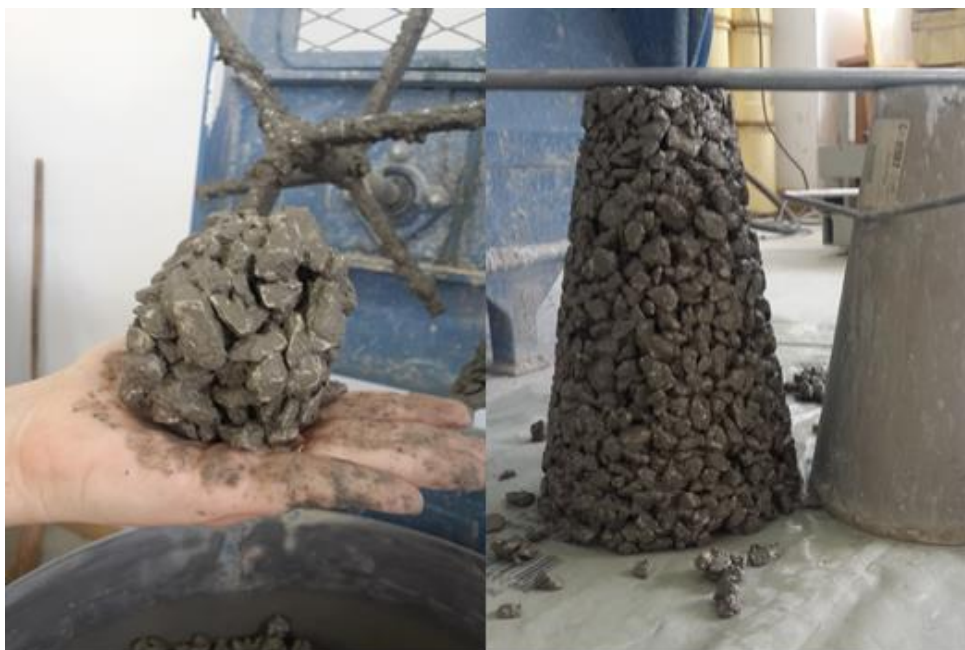
Slika 5.6 Ispitivanje konzistencije mješavine B 7
