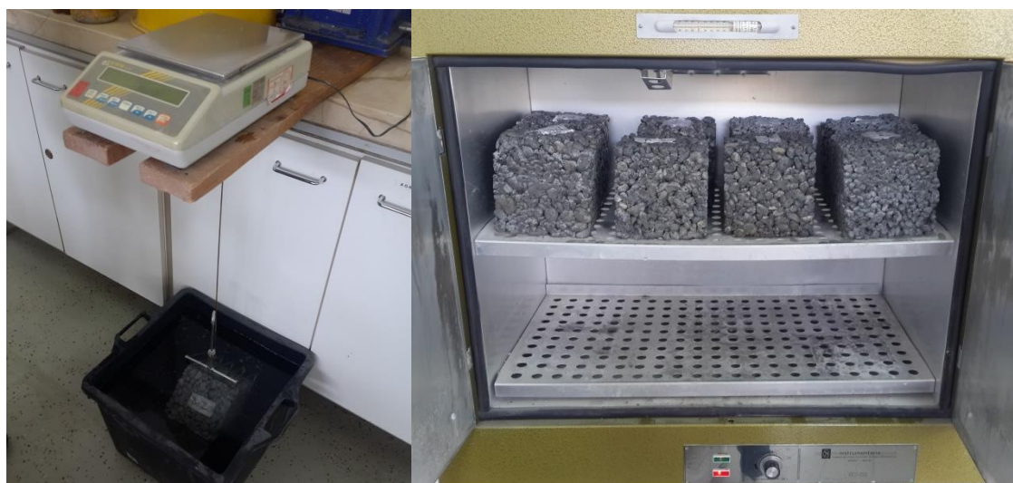
Slika 4.16 Mjerenje mase uzorka uronjenog u vodu i sušenje u pećnici
