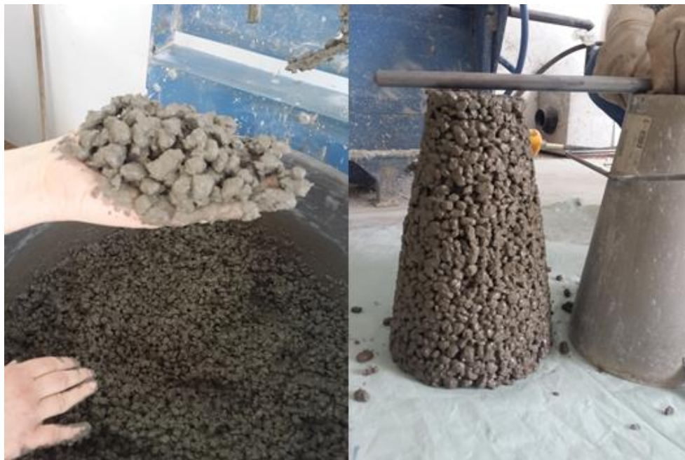
Slika 5.1 Ispitivanje konzistencije mješavine B 1
