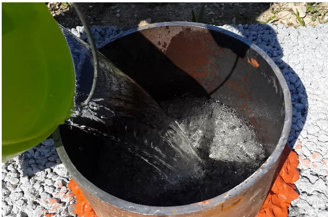
Slika 4.31 Mjerenje brzine infiltracije prema ASTM C 1701 standardu
