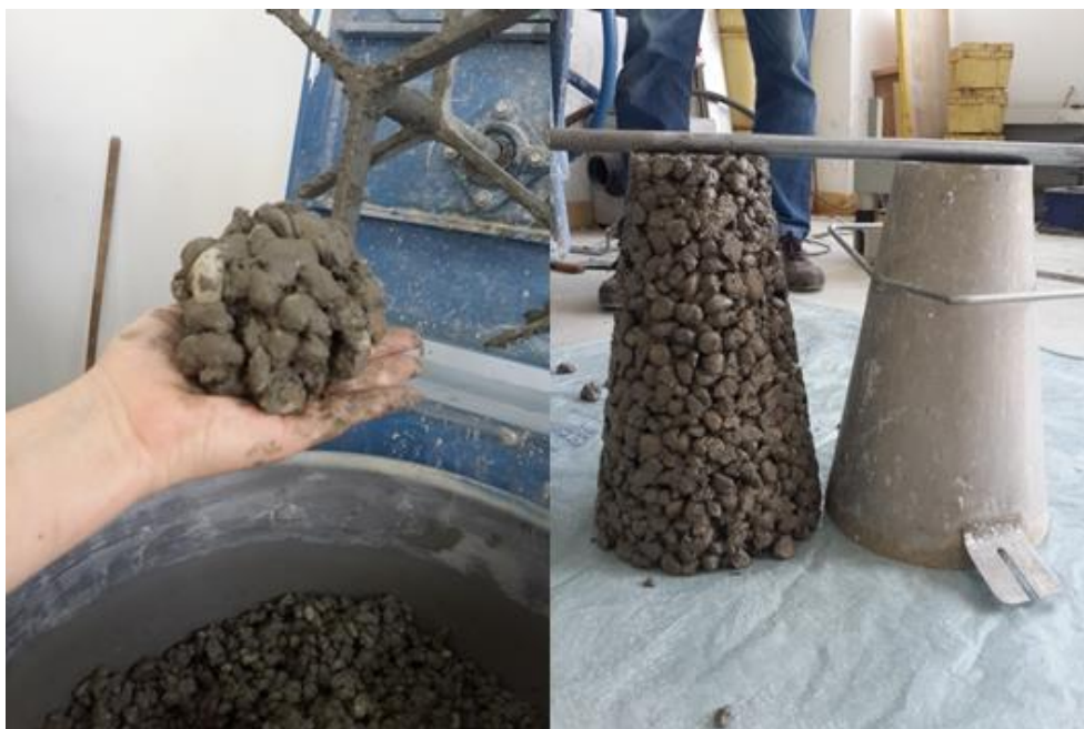
Slika 5.3 Ispitivanje konzistencije mješavine B 3
