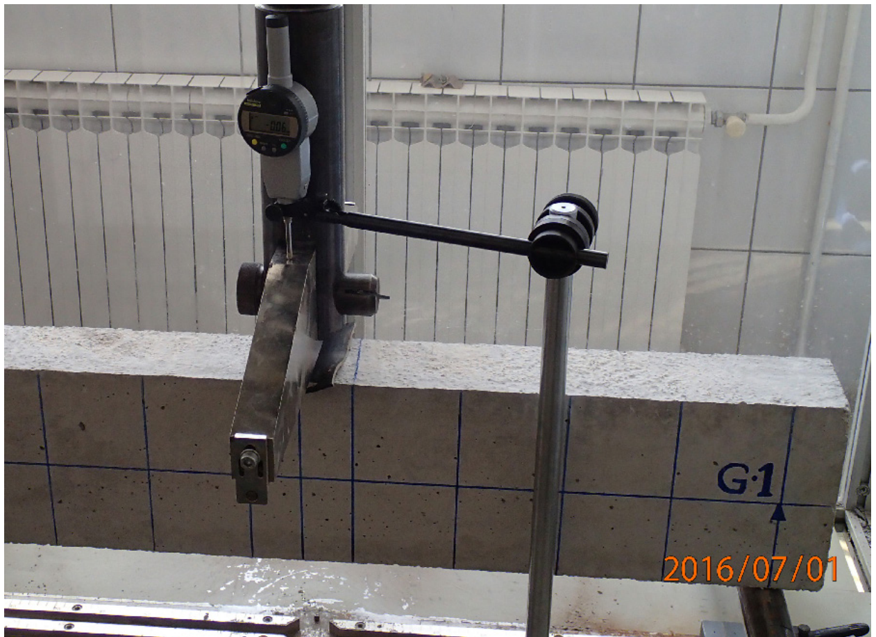
Fotografija 4.7 Slika postavljanja i nuliranja mikroure
