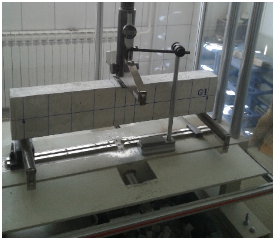
Fotografija 4.8 Početak ispitivanja grede G1
