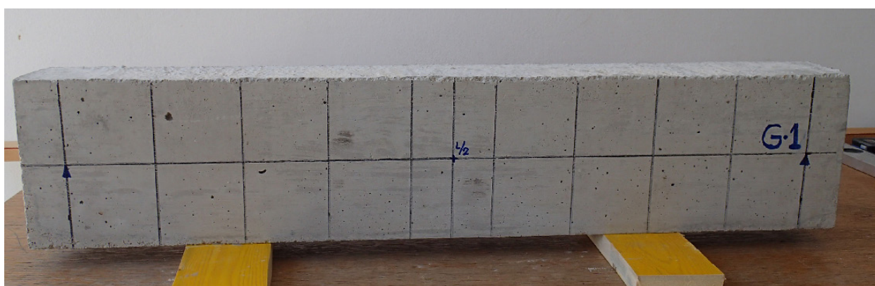
Fotografija 4.1. Greda G1 označena za ispitivanje
