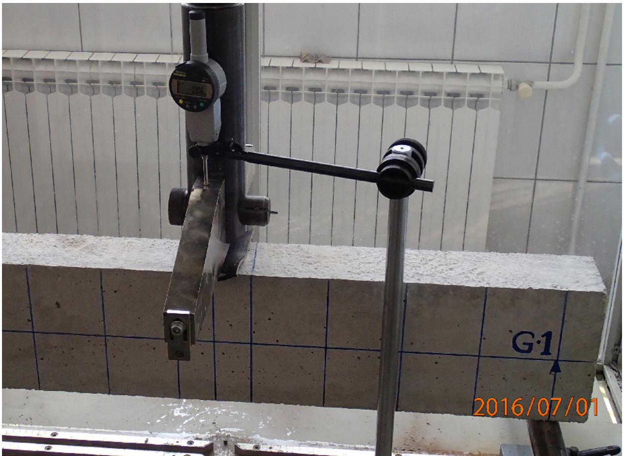
**Fotografija 4.7** Slika postavljanja i nuliranja mikroure
