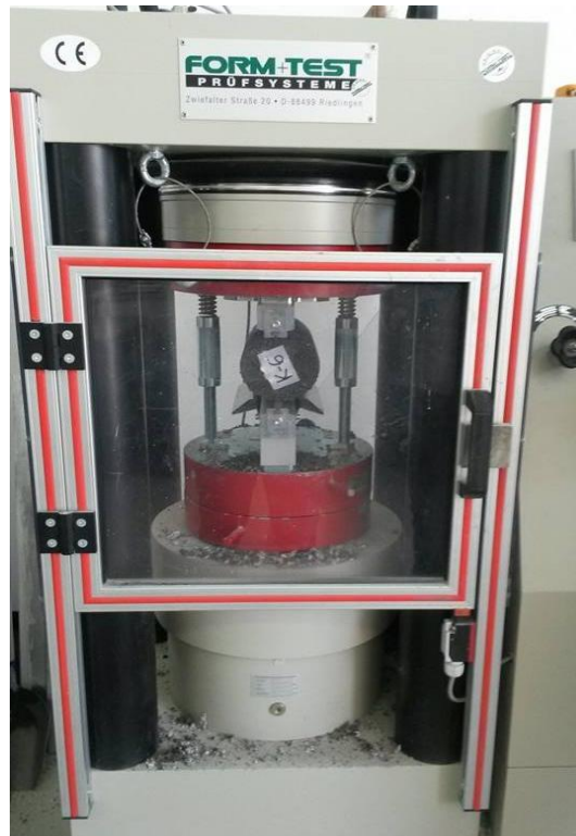
Slika 4.14. Preša za ispitivanje vlačne čvrstoće cijepanjem
