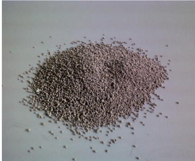
Slika 4.5. Granulirano staklo Liaver
