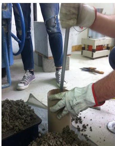
Slika 4.8. Ugrađivanje uzoraka u kalupe
