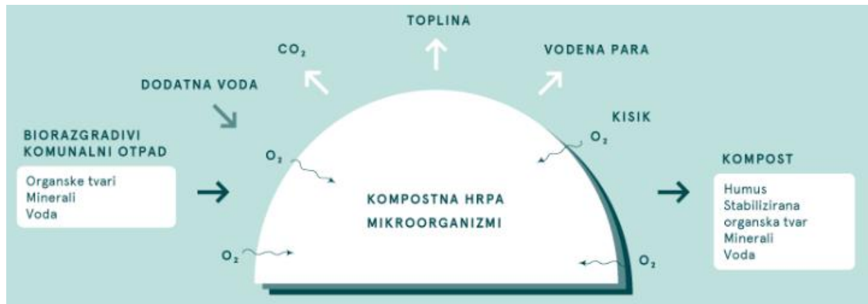
Slika 11.1. Ulazi i izlazi tvari u procesu kompostiranja
