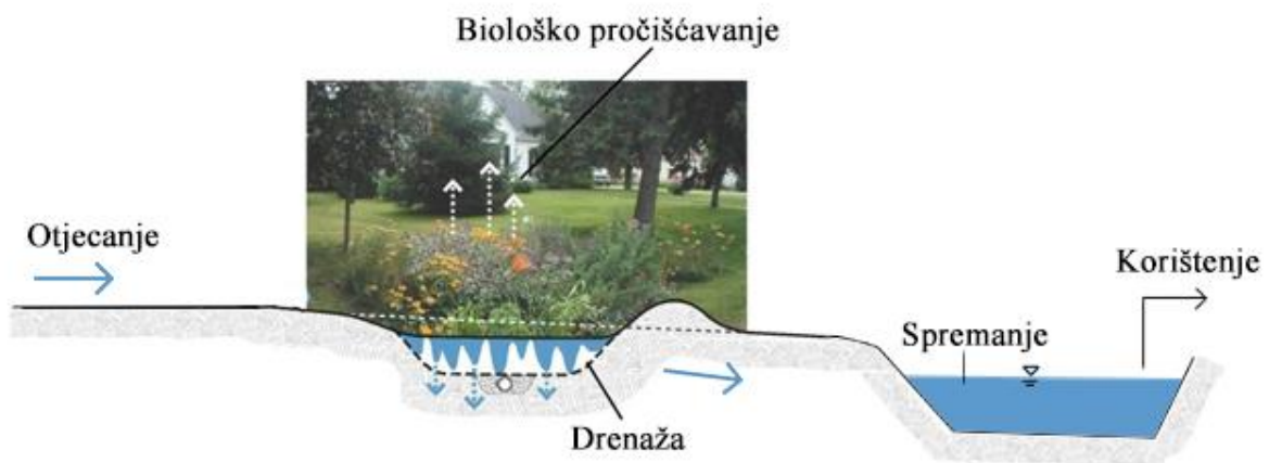
Slika 36. Shema uređaja za pročišćavanje – sakupljanje – spremanje
