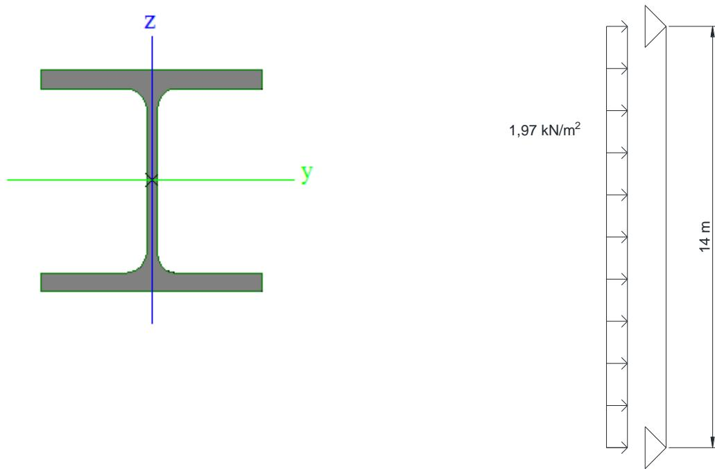
Slika 6.15. Poprečni presjek i model sekundarne konstrukcije
