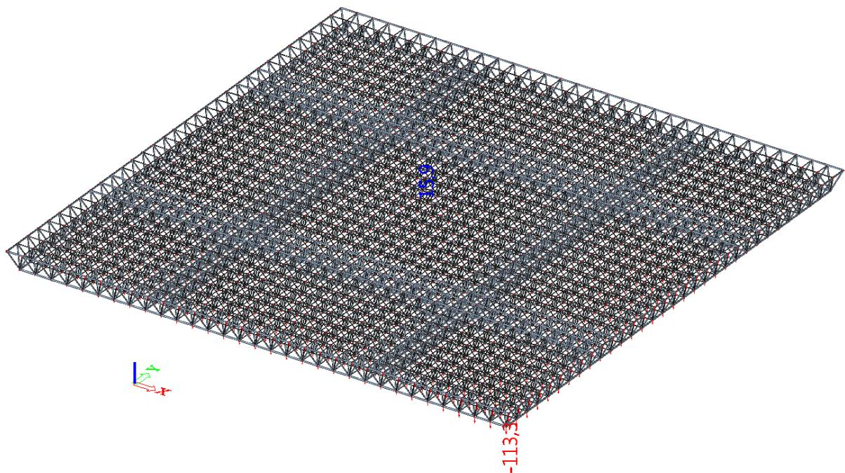
Slika 8.2. Progib rešetke kod sustava sa sekundarnom konstrukcijom na rubovima, varijanta aluminij
