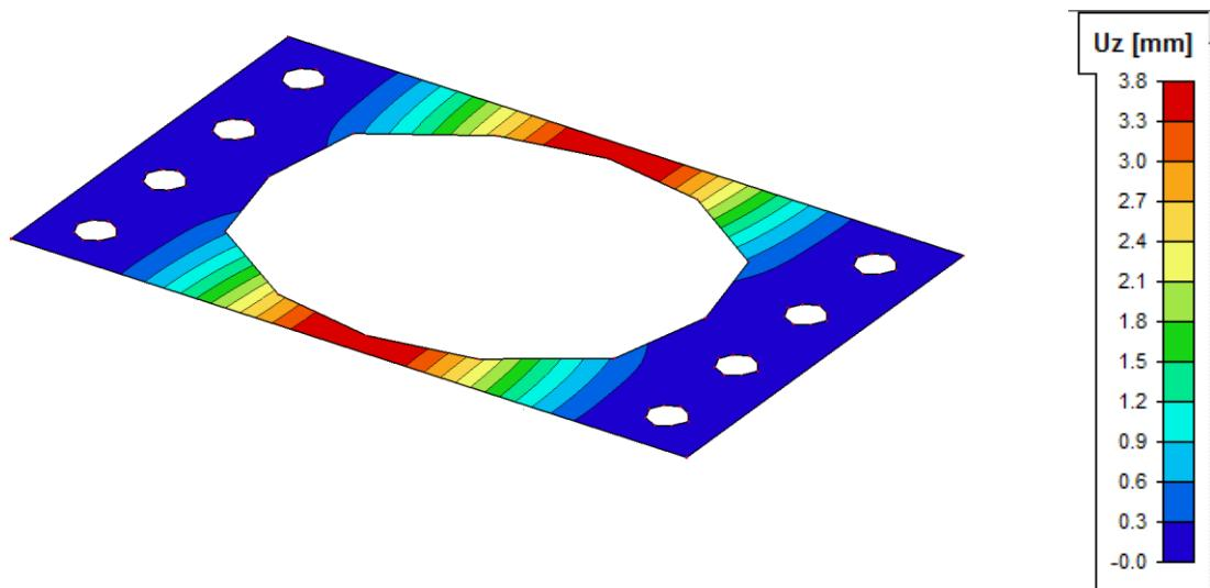
*Slika 7.4. Pomaci pločice*
