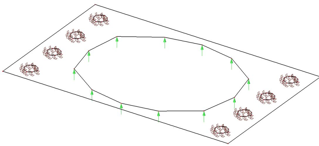
*Slika 7.1. Model pločice sa rubnim uvjetima i silama*
