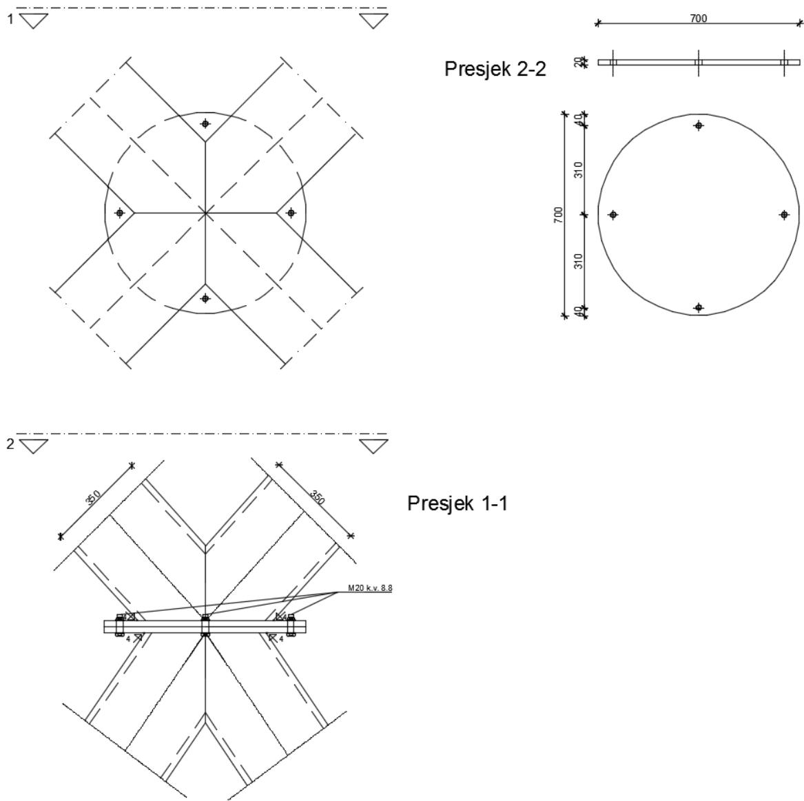
Priključak stup-stup je kompleksan spoj gdje se u jednom čvoru sastaje 8 štapova. Proračunat je na način da je dobivena rezultanta sile iz tih 8 štapova rastavljena na uzdužnu i poprečnu silu za koju su dimenzionirani var, vijci te ploča.
