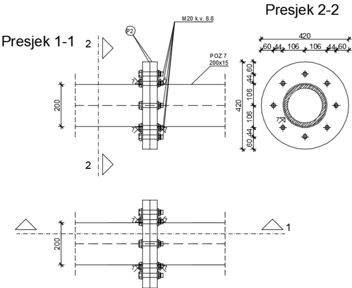
Slika 7.10. Montažni nastavak gornjeg pojasa rešetke u smjeru x - Detalj B
