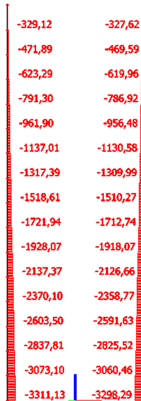
Slika.63 Potresna kombinacija opterećenja K3 – N
