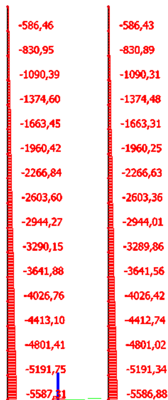
Slika .60 Osnovna kombinacija opterećenja K5 – N
