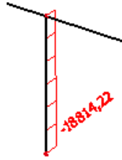
Slika 1.86. – dijagram uzdužnih sila
