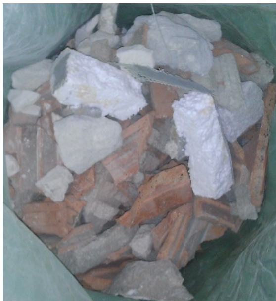
Slika 4.3. Betonski otpad prije mljevenja
