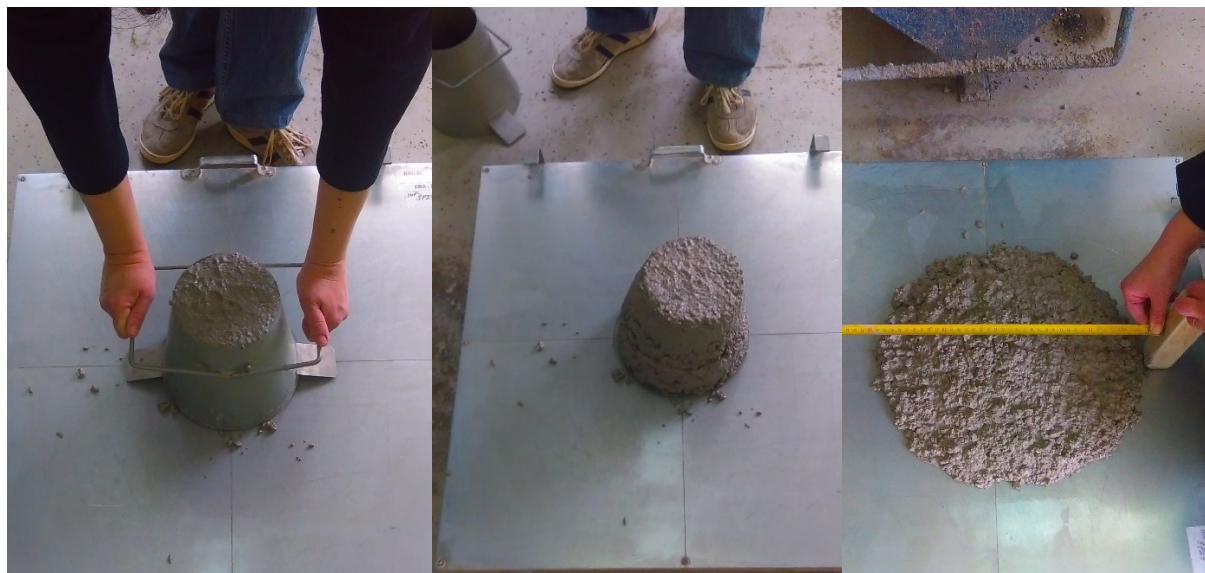
Slika 4.13. Metoda rasprostiranja [slika zabilježena tijekom ispitivanja]
