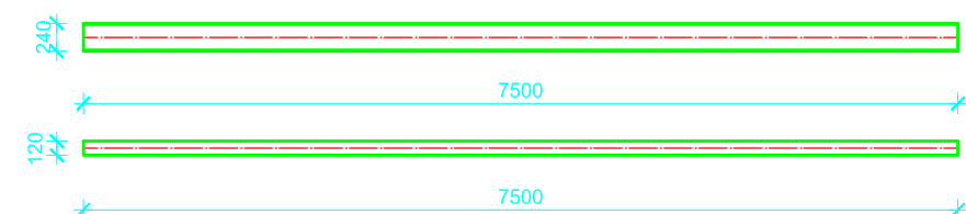
BOČNI SEKUNDARNI NOSAČI (S2-2) I IPE240, l=7500 mm, kom=20
