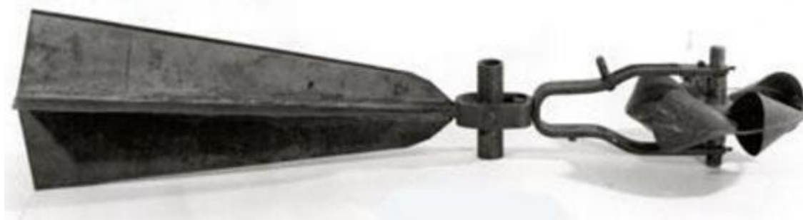
Slika 3.3 Originalno AA hidrometrijsko krilo W.G.Pricea, 1880. godina [14]
