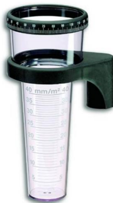
Slika 3.1 Kišomjer s brojilom 40 mm/m 2 [11]
