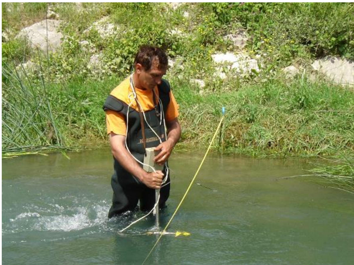
Slika 3.4 Mjerenje brzine strujanja vode hidrometrijskim krilom [14]
