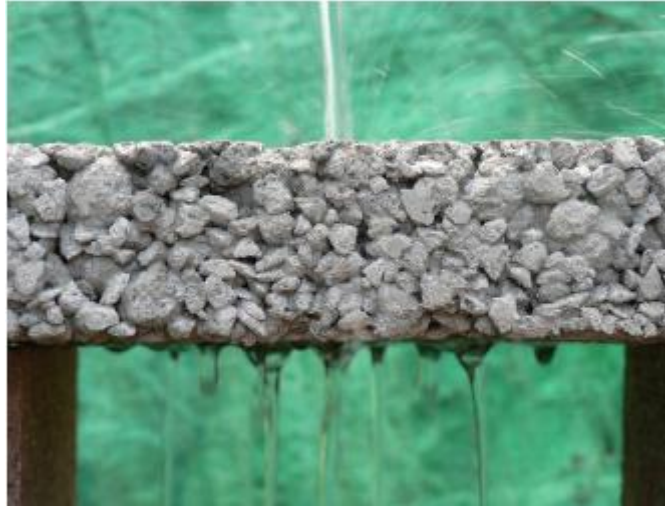
Slika 2.1. Laki beton od jednakozrnatog agregata; izvor [2]
