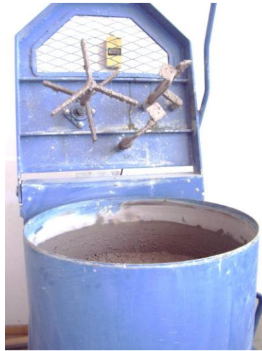
Slika 4.1. Mješalica betona [slika zabilježena tijekom ispitivanja]
