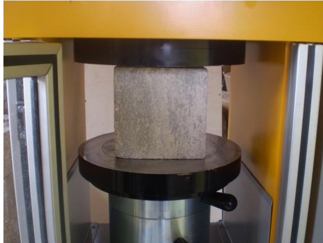
Slika 4.5. Uređaj za ispitivanje tlačne čvrstoće betona [10]
