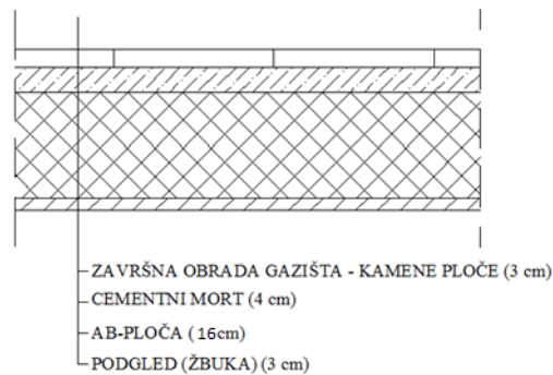
Slika 10: Presjek podesta
