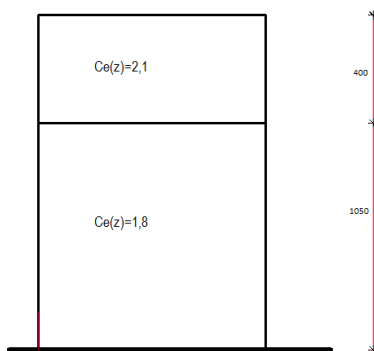
Slika 18: Koeficijent izloženosti c_e(z) u ovisnosti o kategoriji terena I do IV i visini z iznad terena
