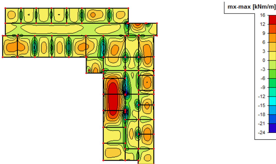
Slika 7.5: Prikaz momenata savijanja m_x (kNm/m) za uobičajenu kombinaciju (1,35G + 1,50Q)
