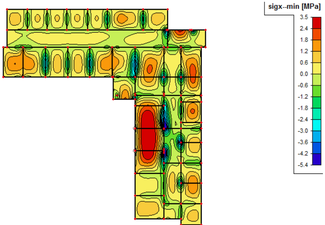
Slika 7.12: Tlačna naprezanja u betonu na donjoj plohi plohi ploče \sigma_{cx,+} [MPa] u smjeru X za osnovnu kombinaciju (1,35G + 1,5Q)
