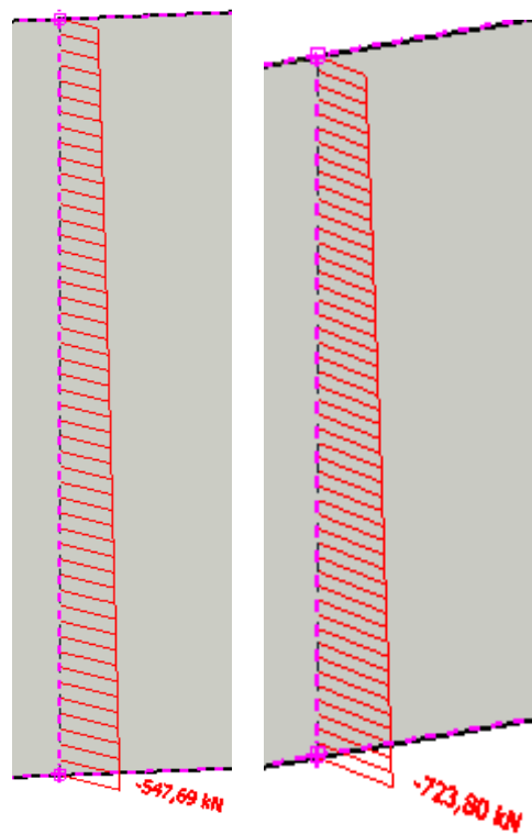
Slika 83: Prikaz max uzdužne sile za kombinaciju Potres y i GSN Snijeg
