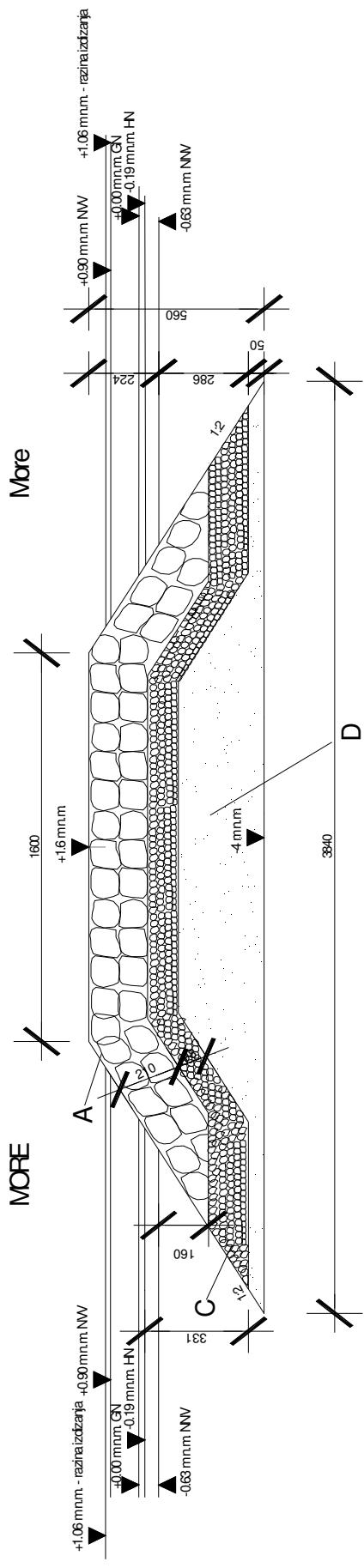
Slika 4-7 Poprečni presjek plaže ispred pristana Pero 2
