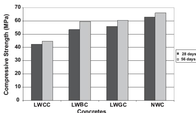
Slika 4.2. Tlačna čvrstoća nakon 28 i 56 dana [5]
