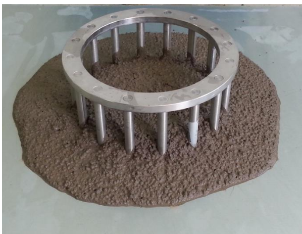
Slika 5.5. Ispitivanje J-prstenom [slika zabilježena tijekom ispitivanja]
