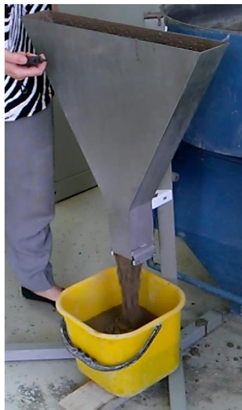
**Slika 5.2. V-lijevak [slika zabilježena tijekom ispitivanja]**
