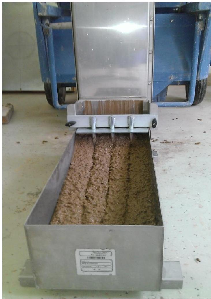
**Slika 5.9.** L-box [slika zabilježena tijekom ispitivanja, mješavina 11]
