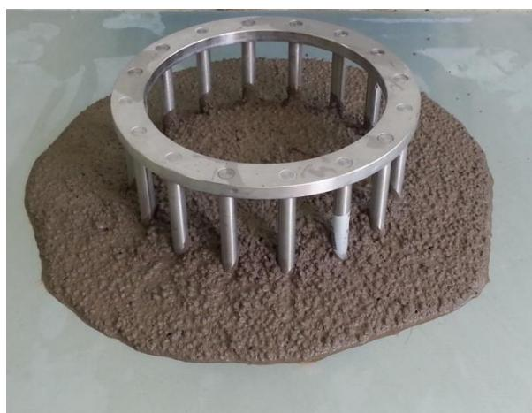
Slika 5.5. Ispitivanje J-prstenom [slika zabilježena tijekom ispitivanja]
