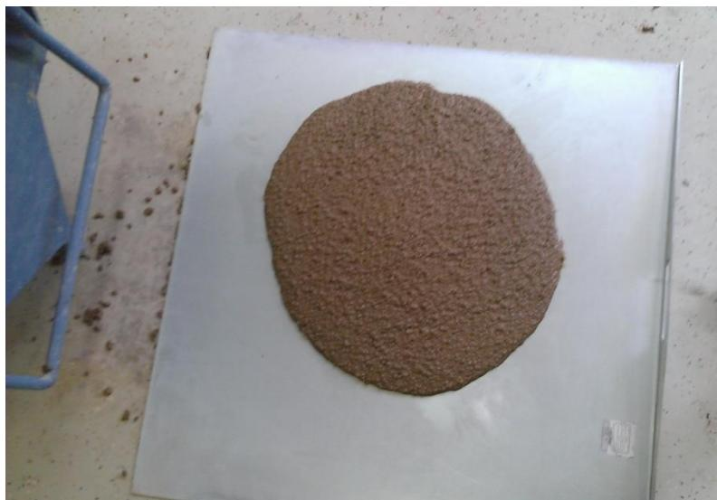
Slika 5.3. Razastiranje betona [slika zabilježena tijekom ispitivanja]
