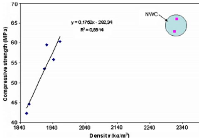
**Slika 4.3.** Omjer tlačne čvrstoće i gustoće [5]
