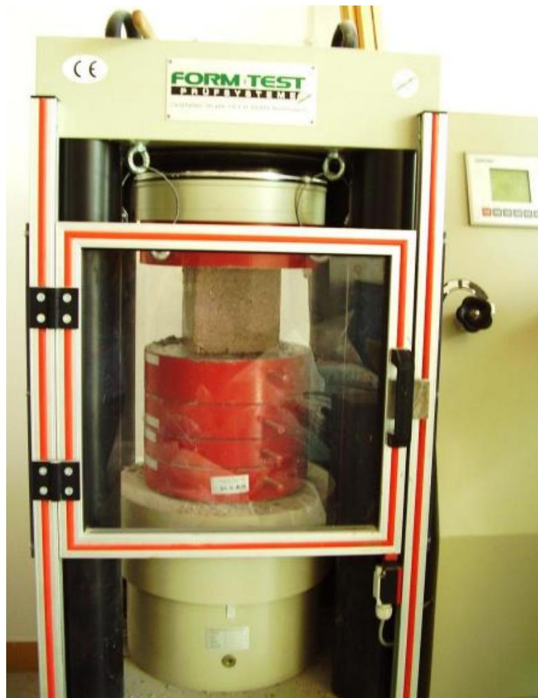
Slika 5.8. Ispitivanje tlačne čvrstoće [slika zabilježena tijekom ispitivanja]
