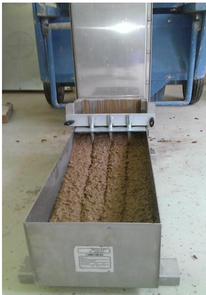
Slika 5.9. L-box [slika zabilježena tijekom ispitivanja, mješavina 11]
