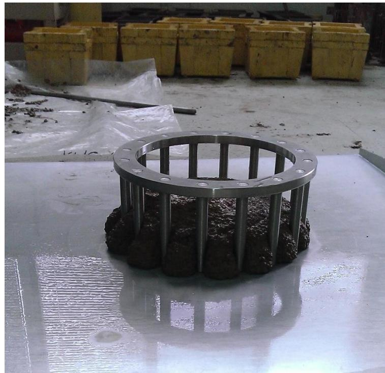
**Slika 5.10.** J-Ring (slika zabilježena tijekom ispitivanja, mješavina 11)
