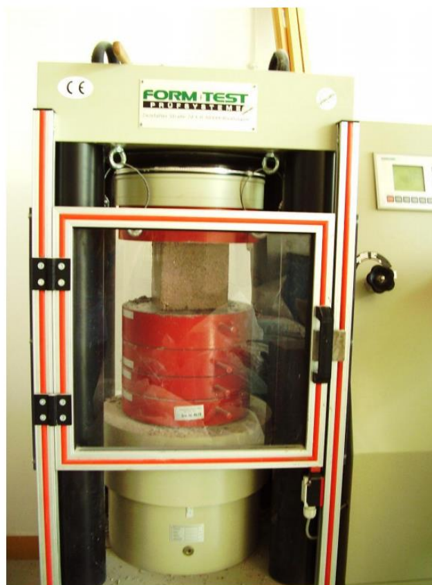
Slika 4.8. Ispitivanje tlačne čvrstoće [4]
