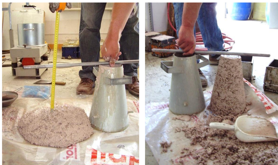
Slika 4.5. Slijeganje mješavine LB6 neposredno nakon miješanja (lijevo), te 30 minuta nakon miješanja (desno). [4]
