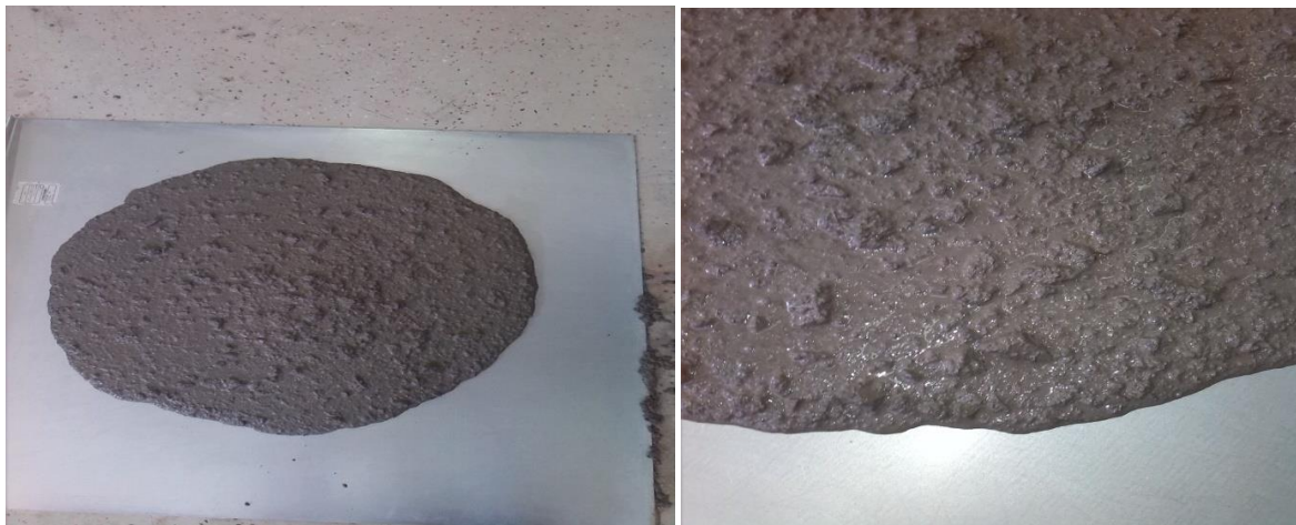
Slika 4.9 Rasprostiranje-slijeganjem mješavina SCC4
