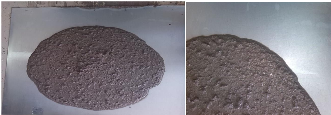
Slika 4.10 Rasprostiranje-slijeganjem mješavina SCC5
