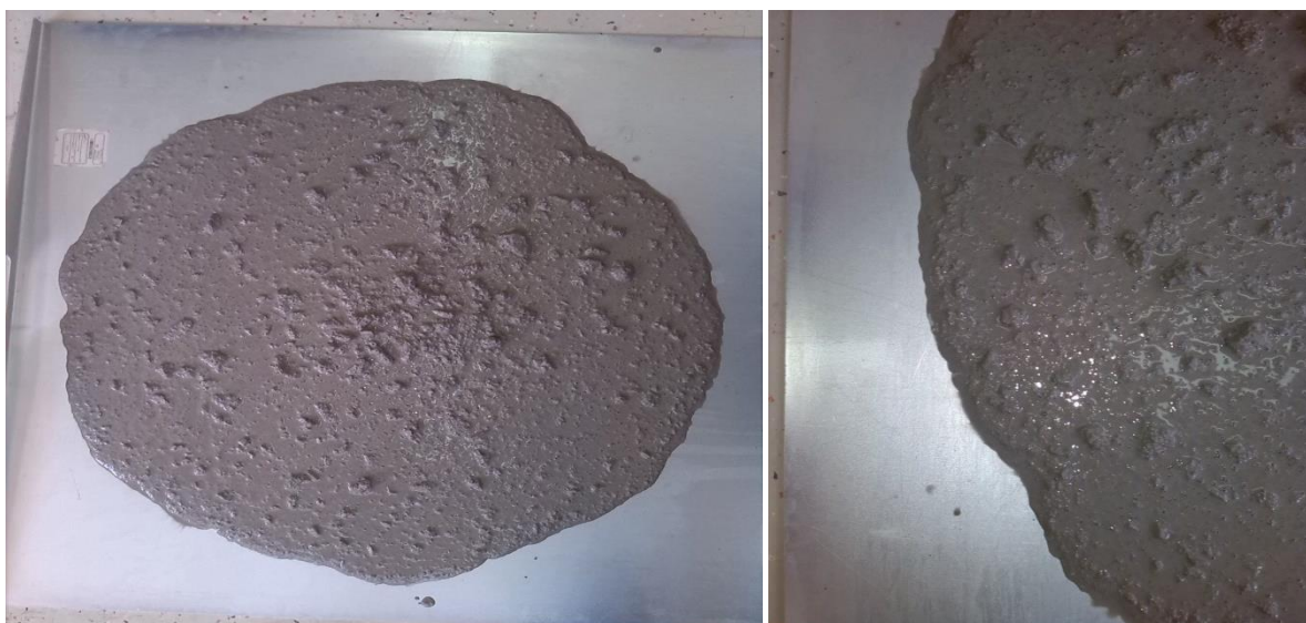
Slika 4.11 Rasprostiranje-slijeganjem mješavina SCC6
