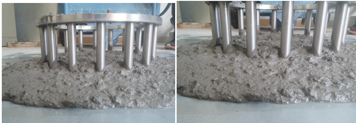
Slika 4.26 Rezultati ispitivanja J-prstenom mješavine SCC3
