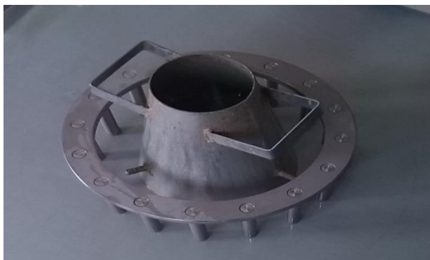
Slika 2.3 Oprema za ispitivanje J-prstenom
