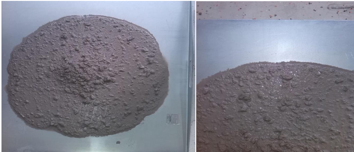
Slika 4.12 Rasprostiranje-slijeganjem mješavina SCC7
