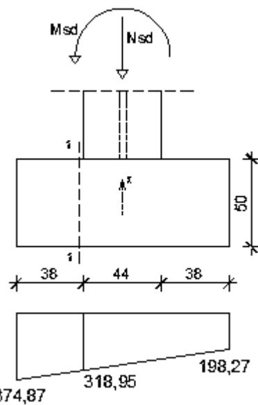
Slika 3.75. Naprezanja u tlu
