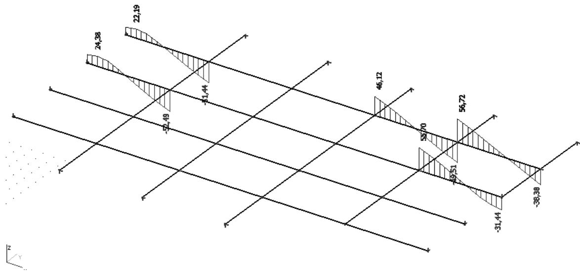
Slika 3.37. Dijagram poprečnih sila  $V_z$  (kN) za gredu Gla POZ 100 (uporabno opterećenje "Q")
