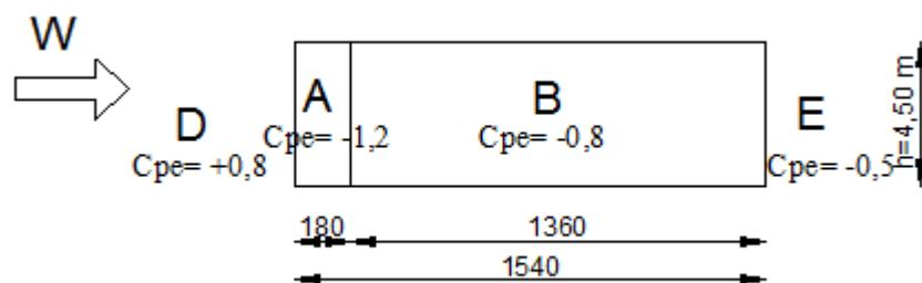
Slika 2.20. Koeficijenti vanjskog tlaka na vanjske zidove
