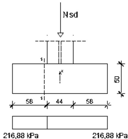
Slika 3.69. Naprezanja u tlu
