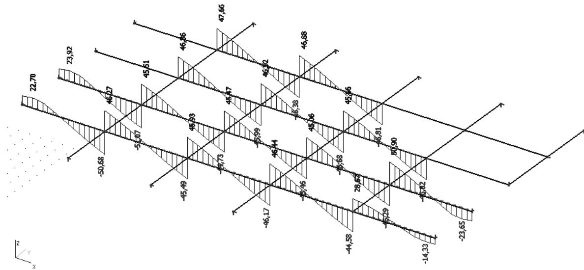
Slika 3.32. Dijagram poprečnih sila  $V_z$  (kN) za gredu G1 POZ 100 (uporabno opterećenje "Q")
