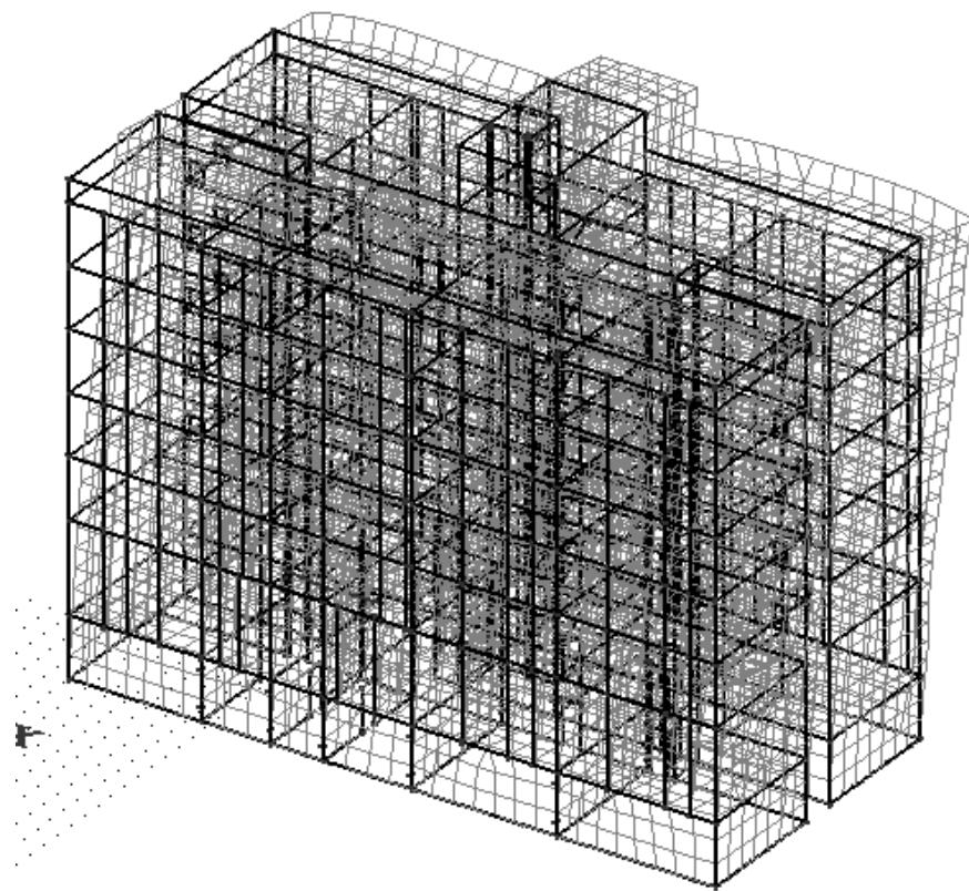
Slika 2.23. 1. oblik osciliranja:  $T=0,1749$  s,  $Sx= 0,01\%Gx$ ,  $Sy= 66,46\% Gy$ ,  $Sz= 0,0\% Gz$
