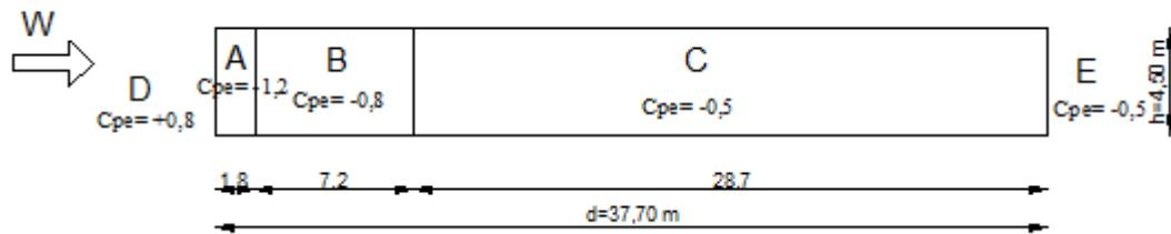
Slika 2.17. Koeficijenti vanjskog tlaka na vanjske zidove
