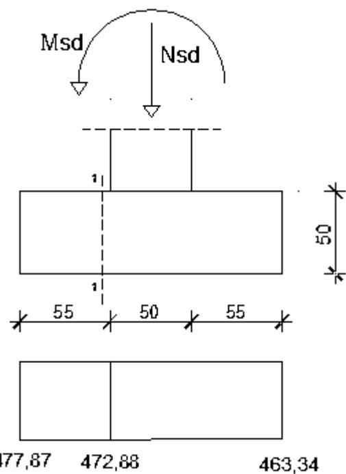
Slika 3.66. Naprezanja u tlu
