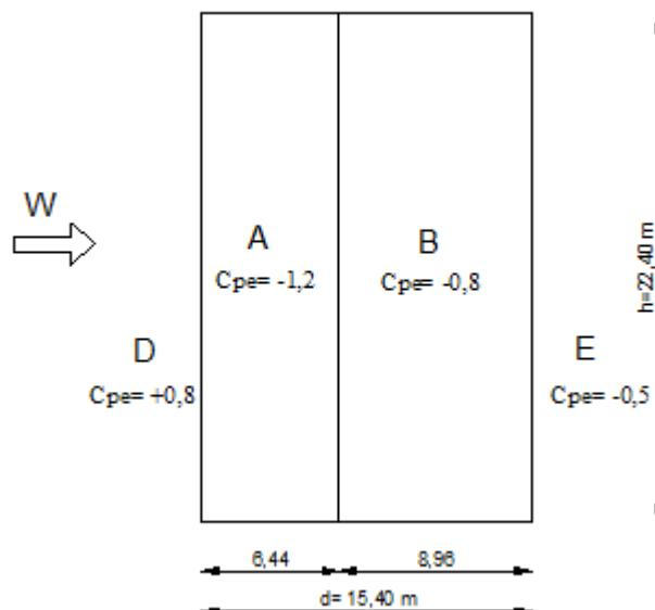
Slika 2.14. Koeficijenti vanjskog tlaka na vanjske zidove
