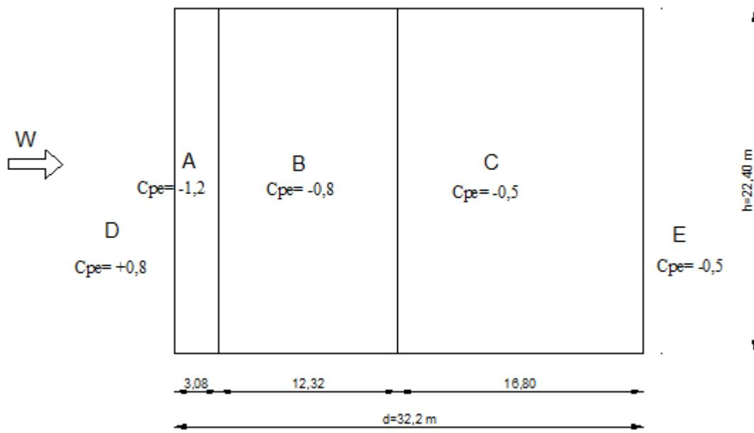
Slika 2.10. Koeficijenti vanjskog tlaka na vanjske zidove
