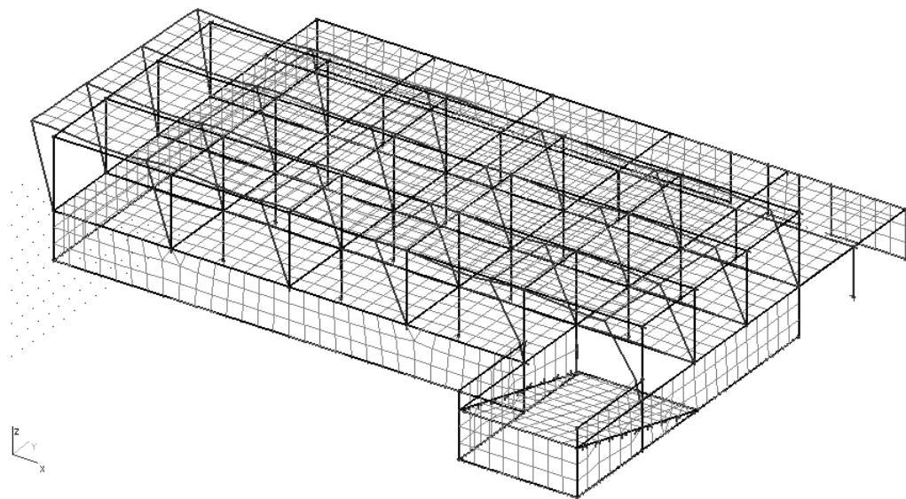
Slika 2.27. 1. oblik osciliranja: T=0,4518 s, Sx= 31,79%Gx, Sy=0,19% Gy, Sz=0,0% Gz
