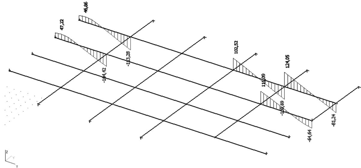
Slika 3.36. Dijagram poprečnih sila  $V_z$  (kN) za gredu Gla POZ 100 (vlastita težina i dodatno stalno opterećenje "dG")
