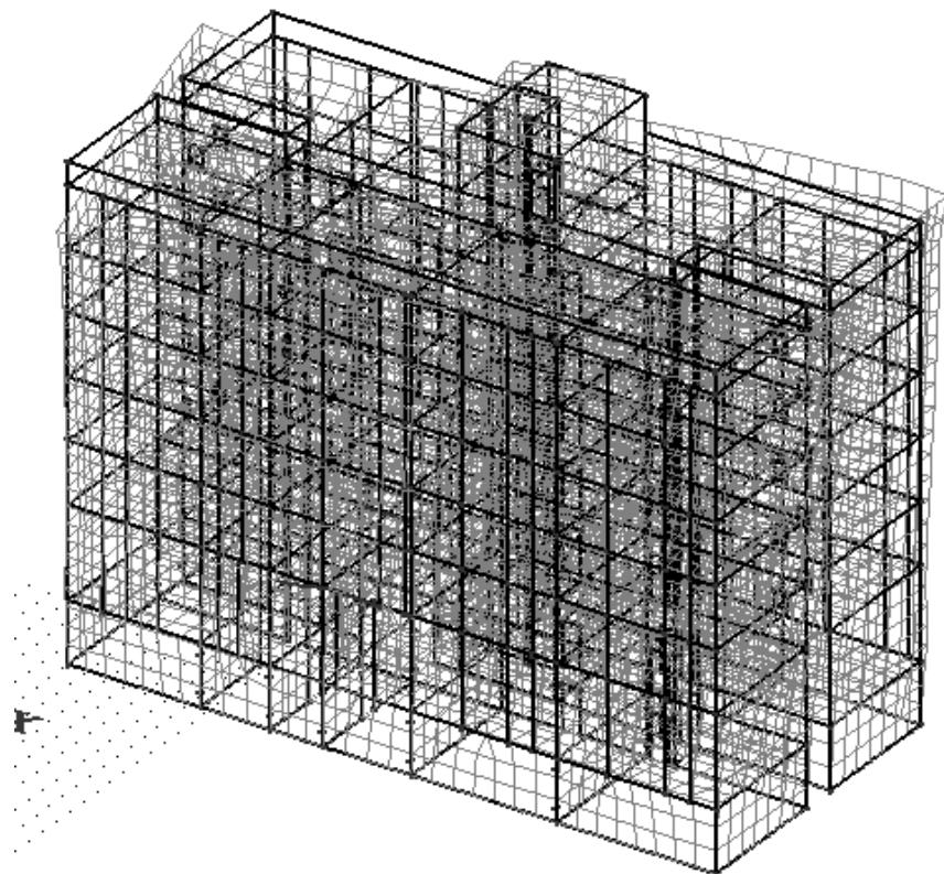
Slika 2.24. 2. oblik osciliranja:  $T=0,152$  s,  $Sx= 2,27\% Gx$ ,  $Sy=0,08\% Gy$ ,  $Sz=0,0\% Gz$
