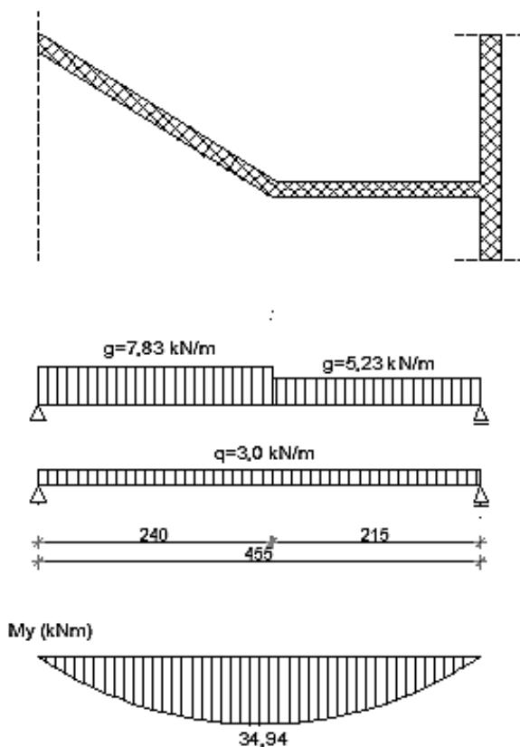
Slika 3.17. Prikaz opterećenja i statickog sustava konstrukcije stubišta
