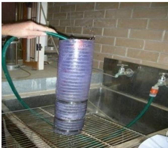
Slika 3.3 Ispitivanje vodopropusnosti poroznog betona [9]
