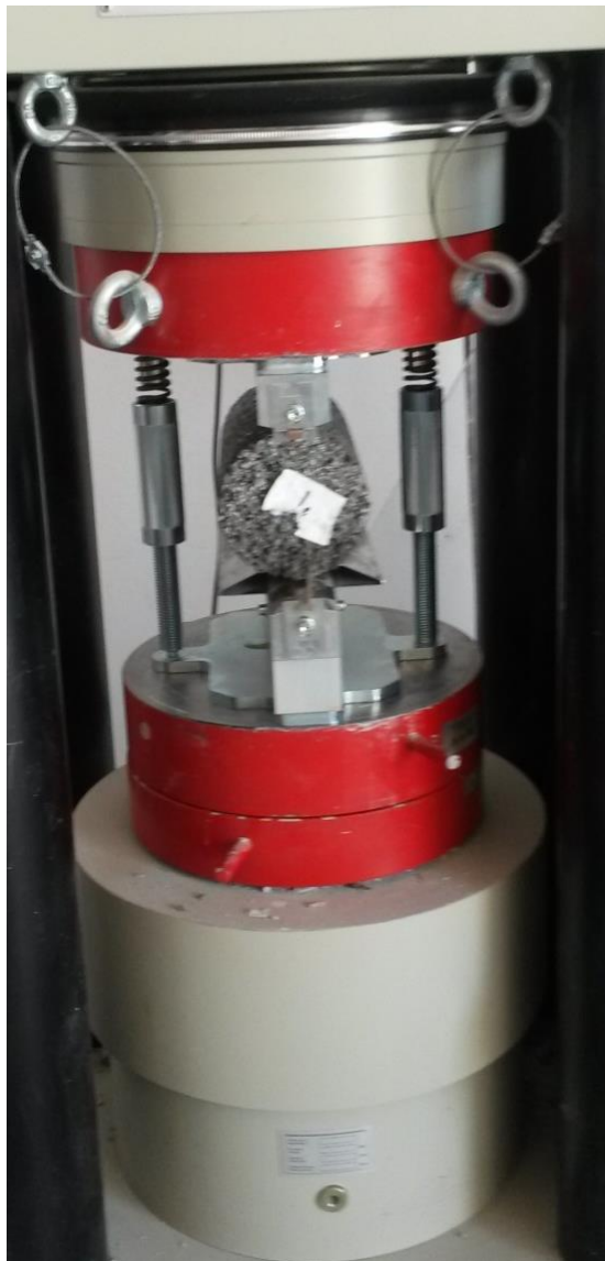
Slika 5.7 Preša za ispitivanje vlačne čvrstoće cijepanjem
