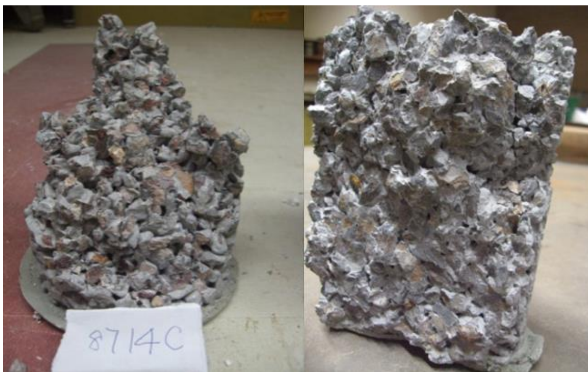
Slika 3.6 Usporedba uzoraka poroznog betona bez dodataka i sa dodacima [9]
