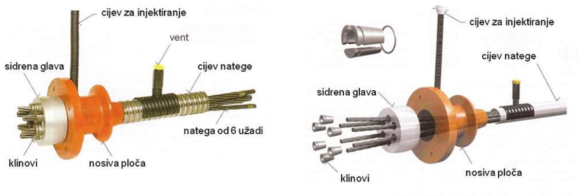
Slika 3.13 Sidro sustava prednapinjanja SOLO [9]
