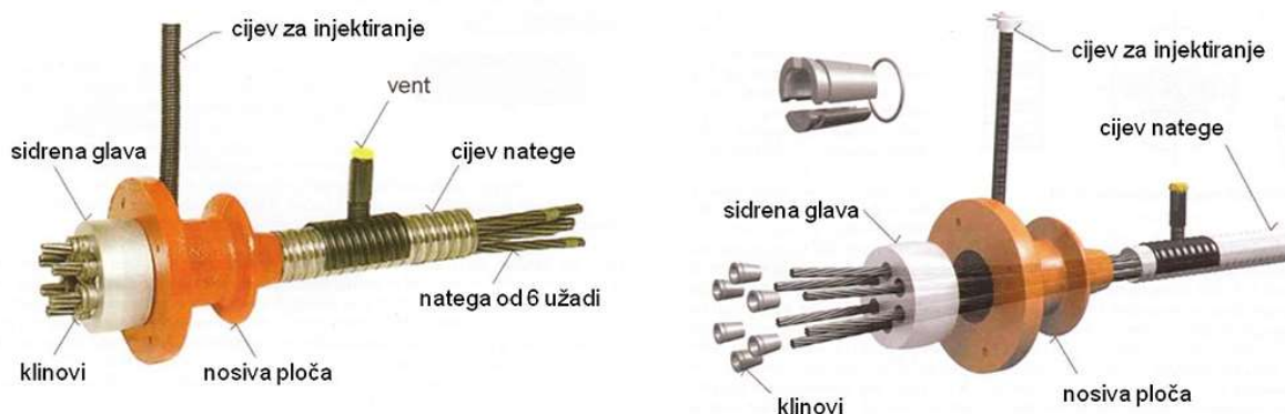
Slika 3.13 Sidro sustava prednapinjanja SOLO [9]
