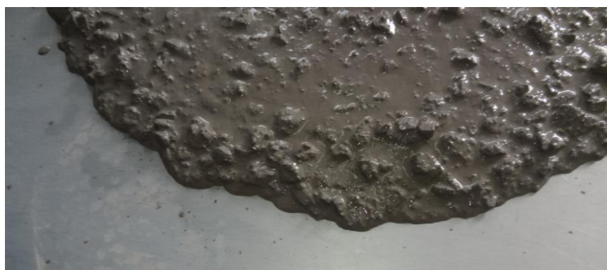
Slika 6.12.: Mješavina M5 (nema lučenja vode)
