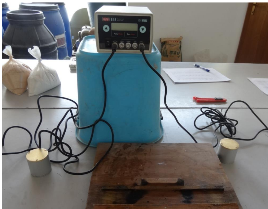
Slika 6.33.: Uređaj za ispitivanje brzine ultrazvučnih valova
