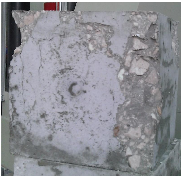
Slika 6.29.: Uzorak betona M9 nakon ispitivanja 14-dnevne tlačne čvrstoće
