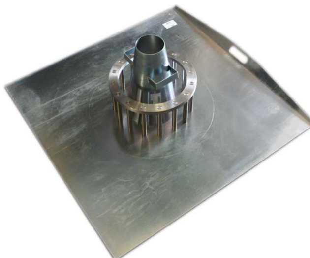
Slika 4.3.: Oprema za ispitivanje J- prstenom[17]
