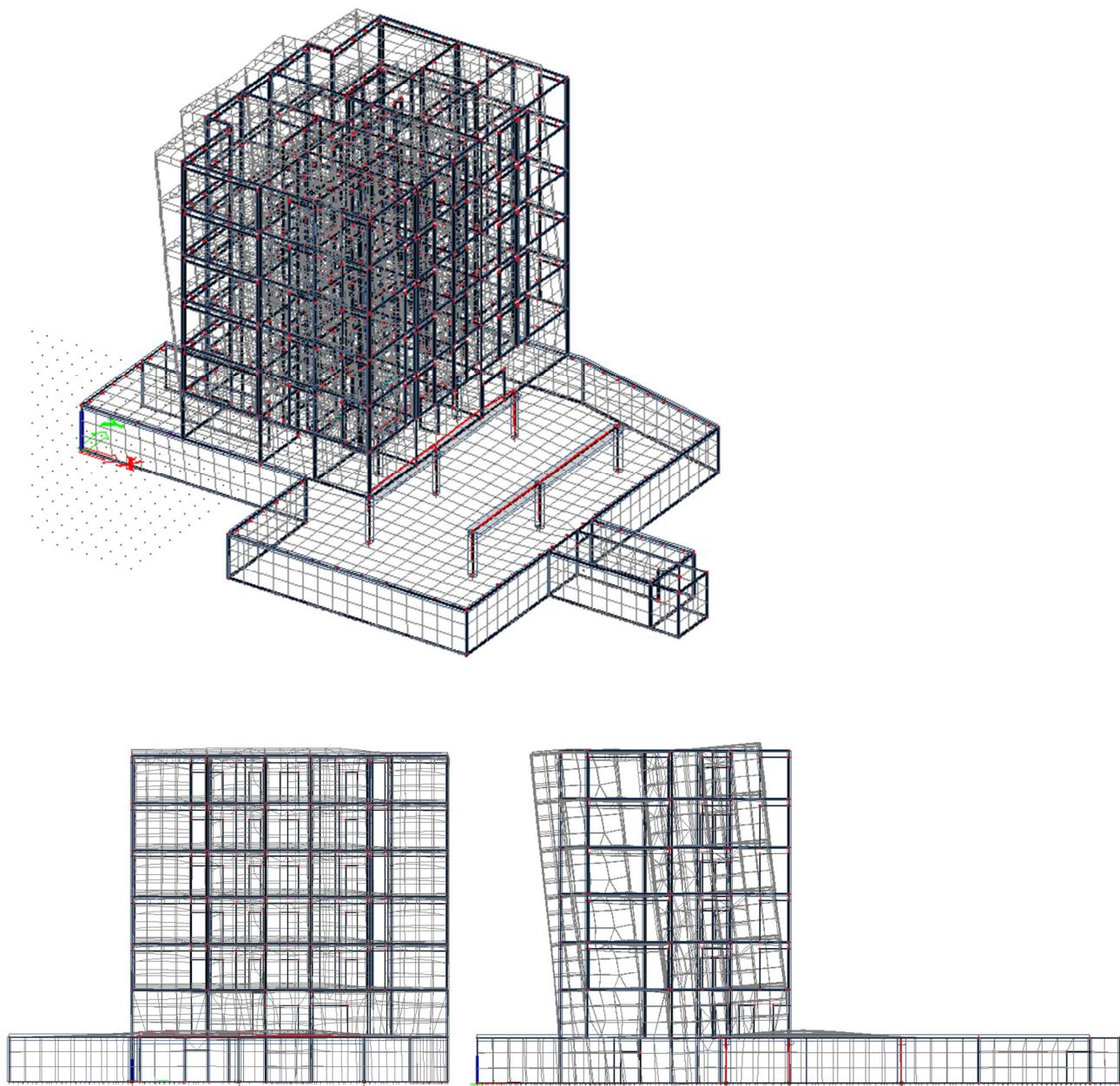
*Slika 8.12 Prvi vlastiti vektor od djelovanja potresa na konstrukciju,  $T = 0.1786 \text{ s}$*
