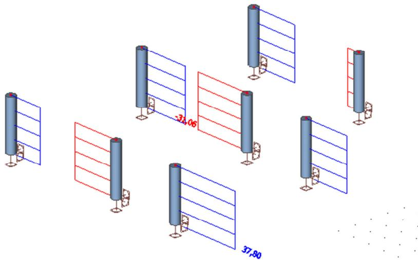
**Slika 11.3.** Maximalni Poprečna sila V za kombinaciju 1,35G+1,35Q+1,5W za stupove  $\phi=50\text{cm}$  u garaži
