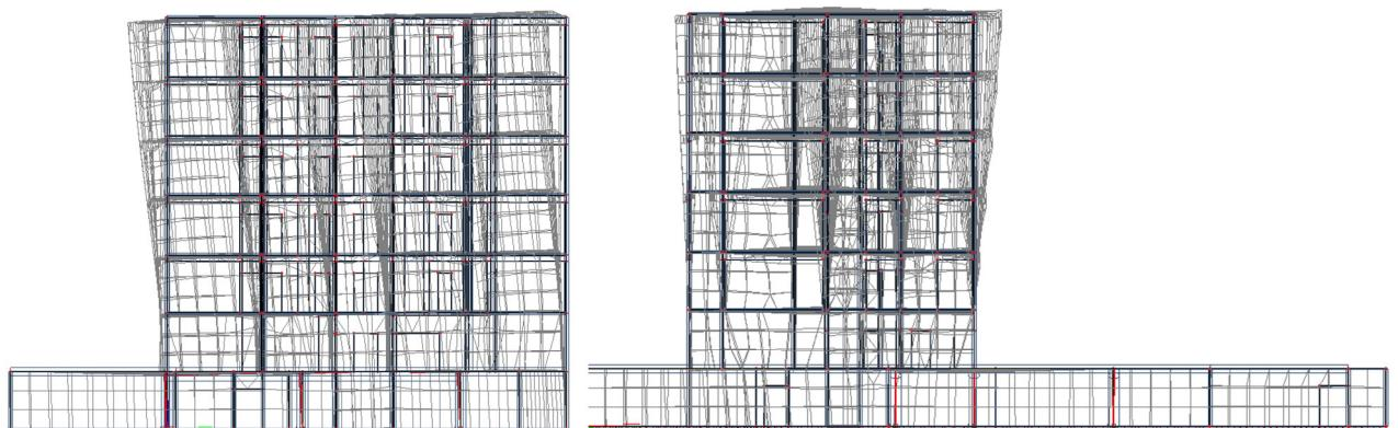
**Slika 8.14** Treći vlastiti vektor od djelovanja potresa na konstrukciju,  $T = 0.1297 \text{ s}$
