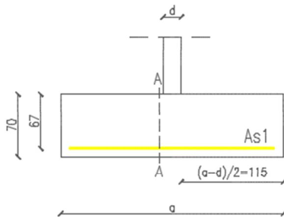
**Slika 12.2.** Dimenzije trakastog temelja ispod zida debljine  $d=20\text{cm}$
