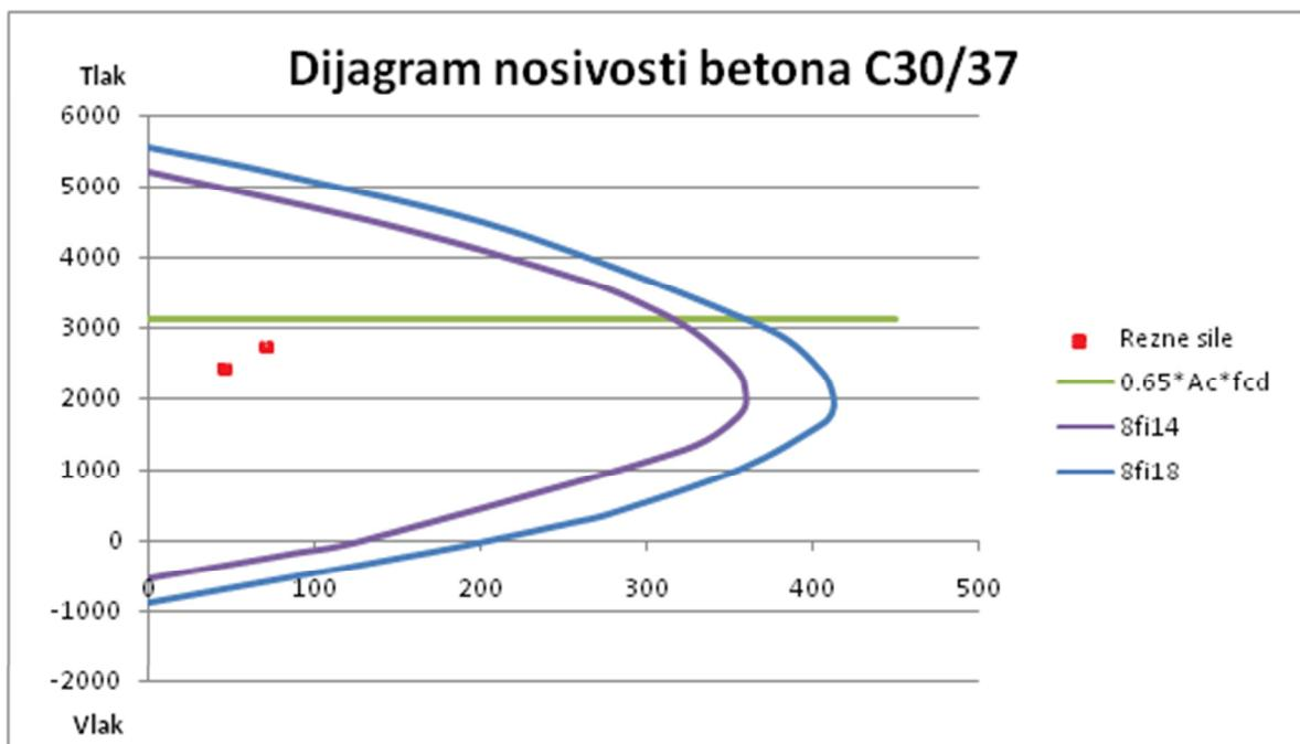
Slika 11.4. Dijagrami nosivosti za stup  $\phi=60\text{cm}$  (C30/37)
