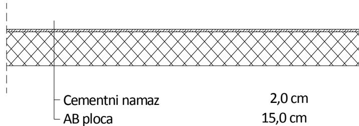
**Slika 8.4** Prikaz slojeva poda garaže i rampe
