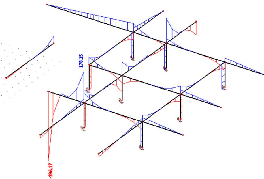
*Slika 10.14. Maksimalna poprečna sila  $V_z$  za kombinaciju  $1,35G+1,5Q+1,5W$  za grede  $50x70\text{cm}$*
