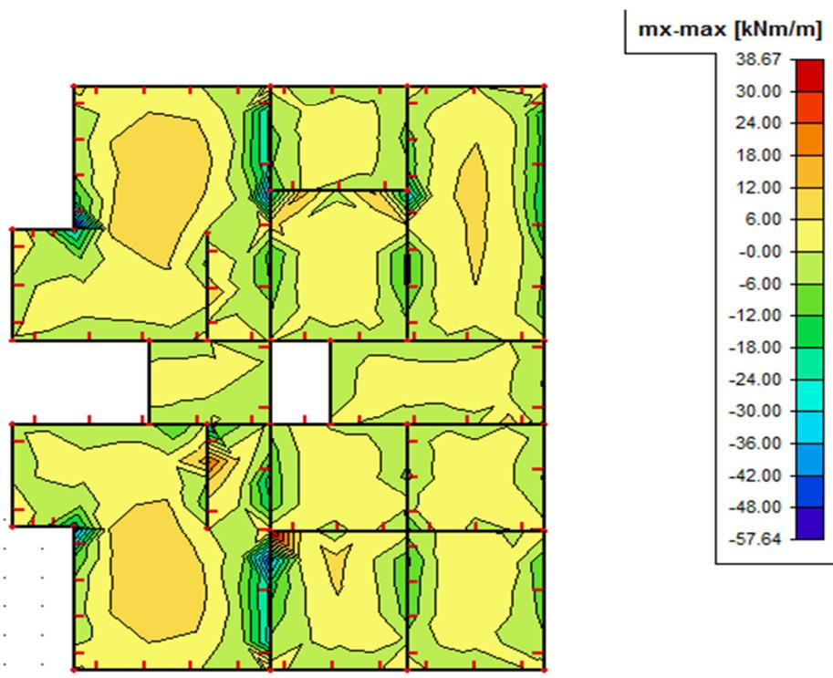
Slika 10.7. Maximalni moment savijanja  $M_x$  za kombinaciju  $1,35G+1,5Q+1,5S$  za ploču iznad prizemlja
