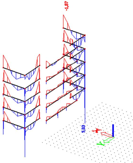
**Slika 10.19.** Maximalni moment savijanja  $M_y$  za kombinaciju  $1,0G+1,0Q+1,0W$  za grede  $20x35$  na katovima
