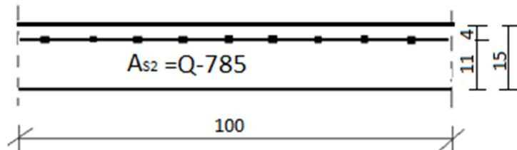
*Slika 10.11. Skica armature ploče na ležaju*
