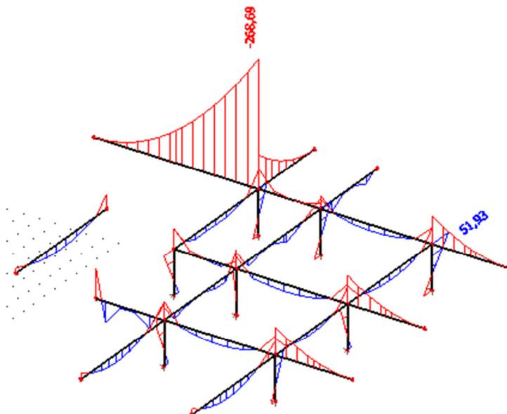
*Slika 10.13. Maksimalni moment savijanja  $M_y$  za kombinaciju  $1,35G+1,5Q+1,5W$  za grede  $50x70\text{cm}$*
