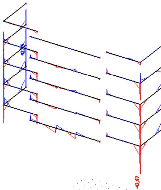
**Slika 10.18.** Maksimalna poprečna sila  $V_z$  za kombinaciju  $1,35G+1,5Q+1,5W$  za grede  $20x35\text{cm}$
