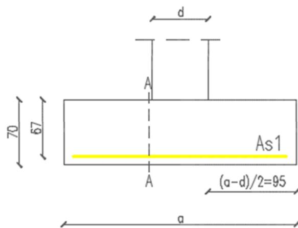
**Slika 12.1.** Dimenzije temelja samca ispod stupa  $\phi=50\text{cm}$
