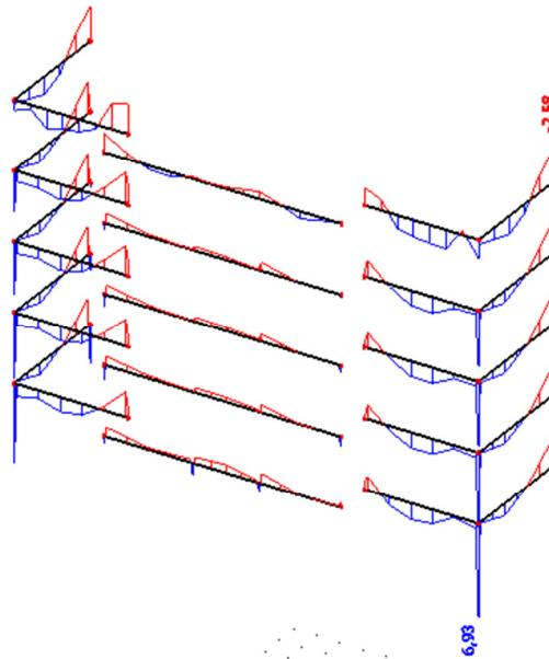
**Slika 10.17.** Maksimalni moment savijanja  $M_y$  za kombinaciju  $1,35G+1,5Q+1,5W$  za grede  $20x35\text{cm}$
