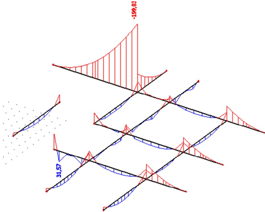
**Slika 10.16.** Maximalni moment savijanja  $M_y$  za kombinaciju  $1,0G+1,0Q+1,0W$  za grede  $50x70$  u garaži
