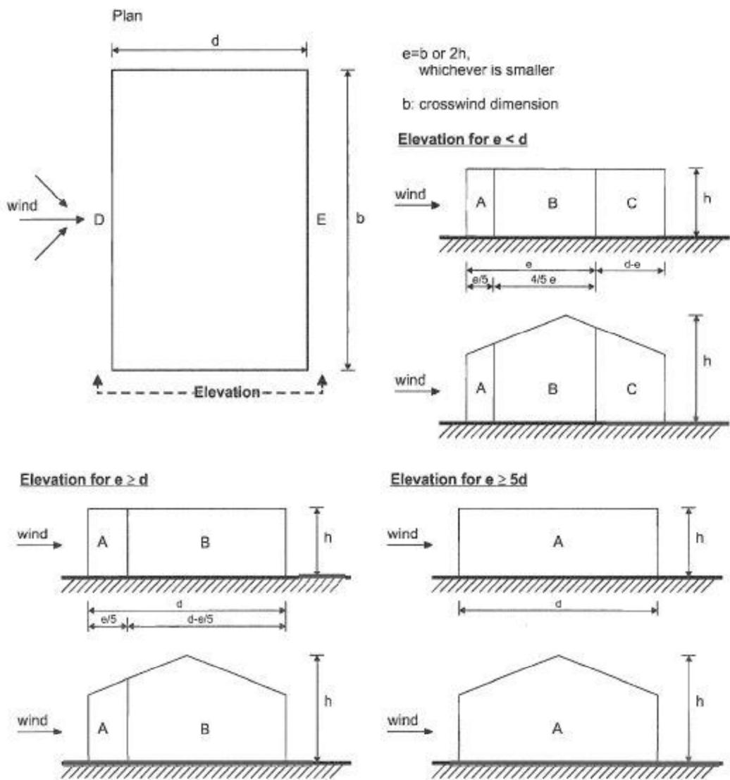
**Slika 8.8** Podjela na zone A,B,C,D i E u ovisnosti o e i d**Tablica 8.7** Preporučene vrijednosti koeficijenta vanjskog tlaka za vertikalne zidove tlocrtno pravokutnih zgrada
