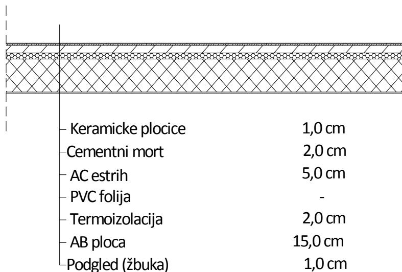
*Slika 8.3 Prikaz slojeva ploča S, P, I, II, III i IV kata*
