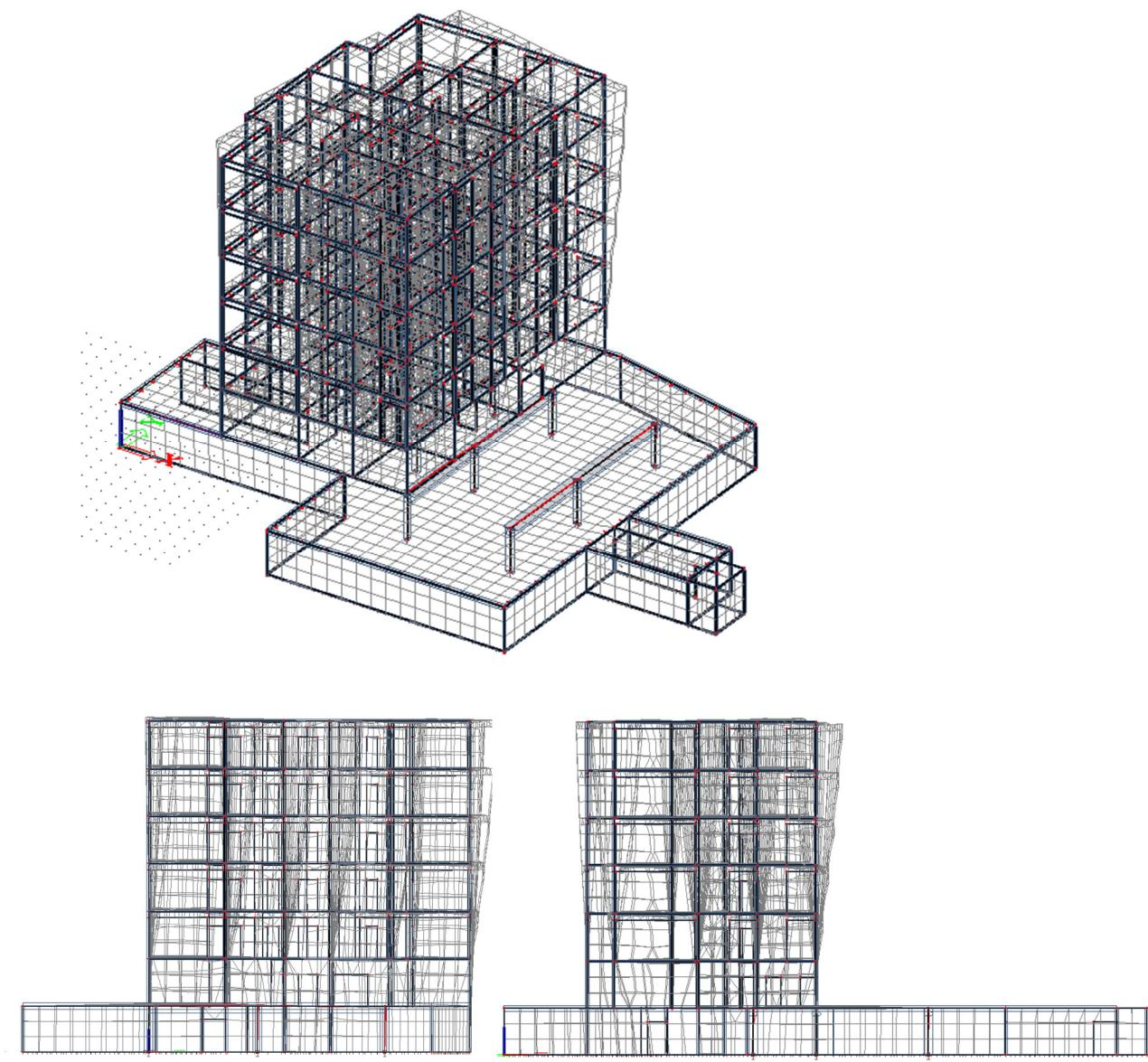
*Slika 8.13 Drugi vlastiti vektor od djelovanja potresa na konstrukciju,  $T = 0.1570 \text{ s}$*
