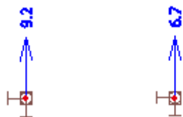
Slika 7.92 Pomaci ležajeva (mm) - vjetar u smjeru osi y (tlak i podtlak)
