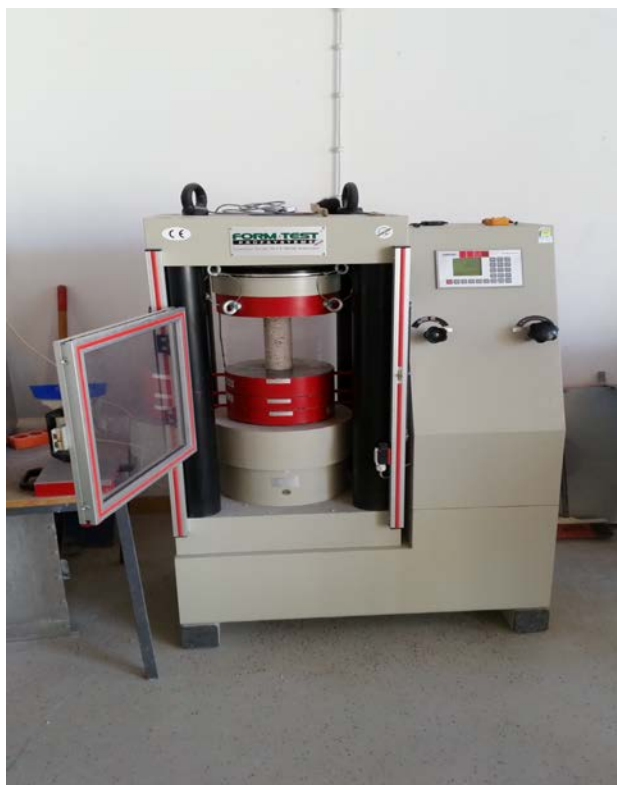
Slika 5.4 Ispitivanje uzorka SCC1 sa prešom
