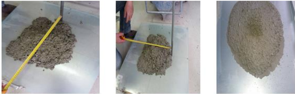
Slika 19. Rasprostiranje betona bez dodataka [slike zabilježene tijekom ispitivanja]
