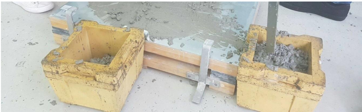
Slika 23. Kalupi za svježi beton
