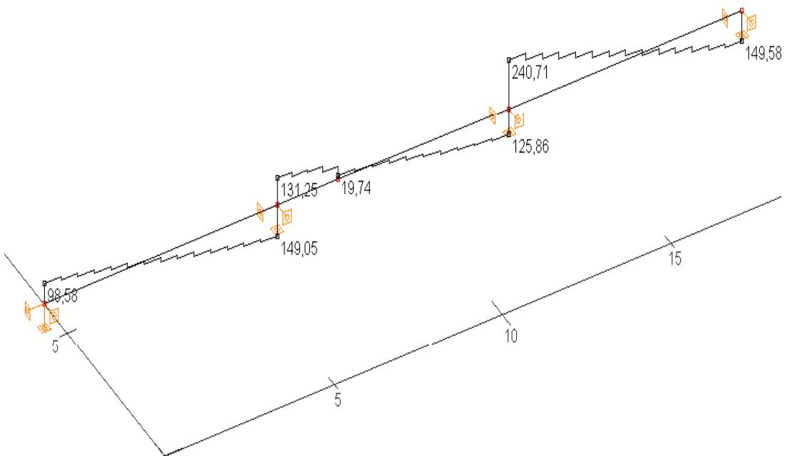
Slika 7.16. Poprečne sile Vy (kN)
