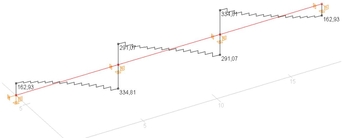
Slika 6.8. Poprečne sile Vy (kN)
