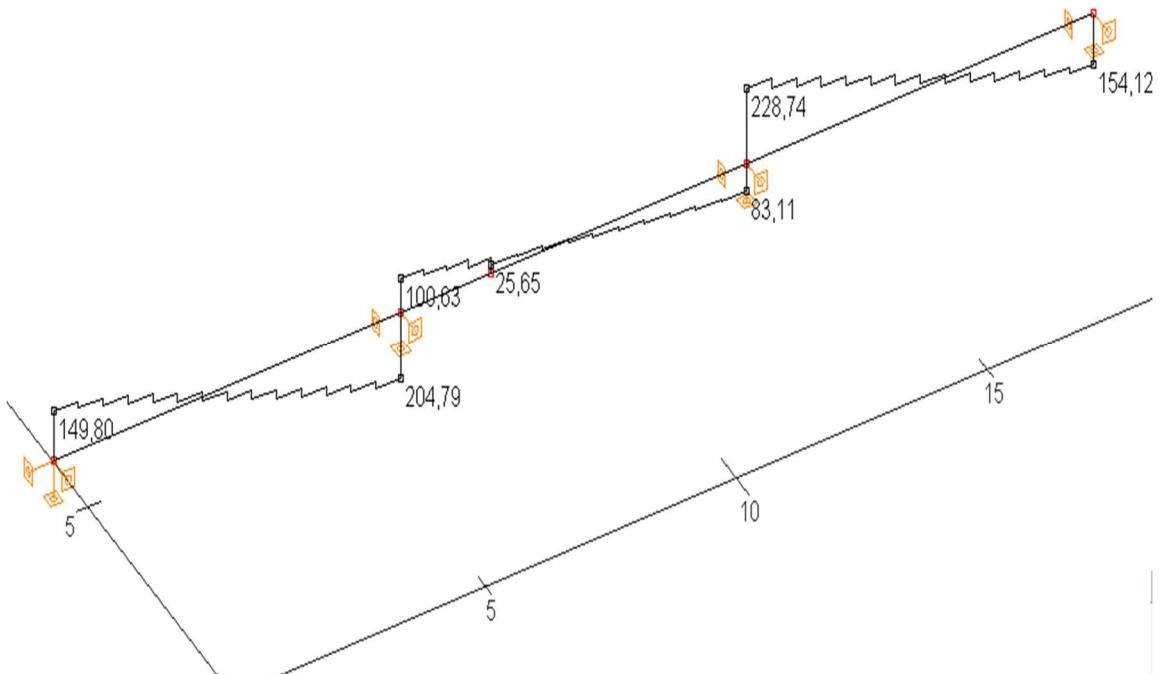
Slika 7.12. Poprečne sile Vy (kN)
