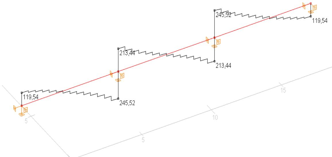
Slika 6.10.Poprečna sila (kN)
