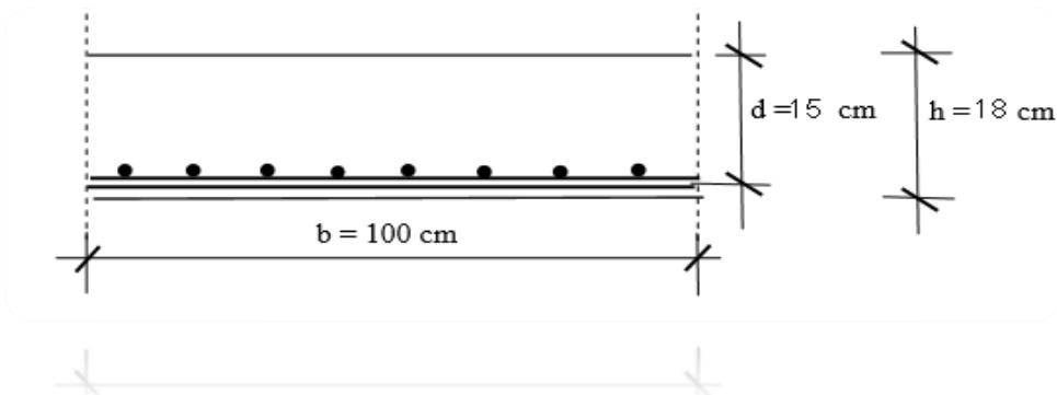
Slika 4.9. Poprečni presjek ploče
