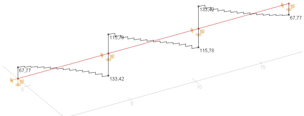
Slika 6.2. Poprečne sile Vy (kN)
